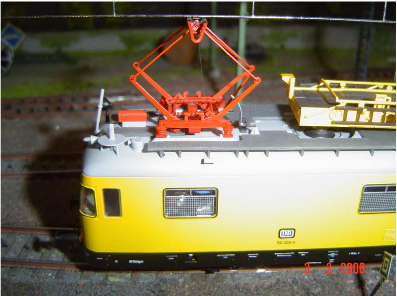
**Il pantografo si alza grazie alle molle ad un filo sottilissimo azionato dal motore piezoelettrico (foto di G.P. Cannata n. 10)**
