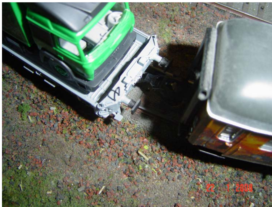
Foto n. 13 – particolare dei respingenti modificati
