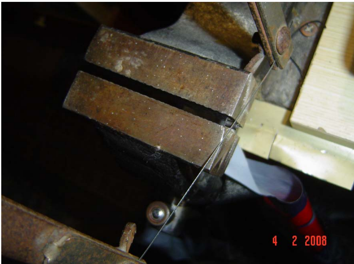
Foto n. 12 – il respingente serrato in una morsa viene accorciato con il traforo
