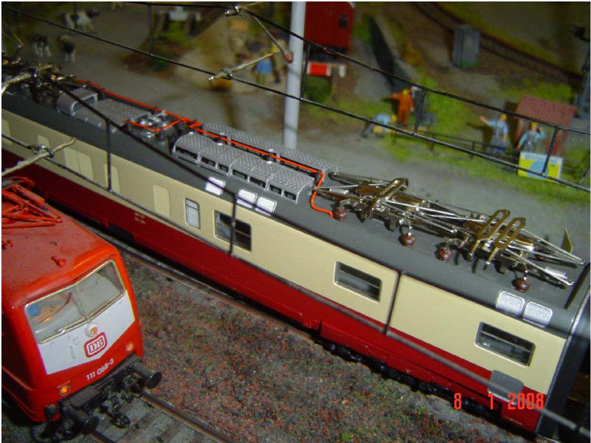
Il pantografo SBB/CFF è il mediano accanto al vistoso cavo rosso, il pantografo italiano è quello mediano a sinistra sullo sfondo, quello DB (abbassato) è a destra in primo piano (foto n. 35)
