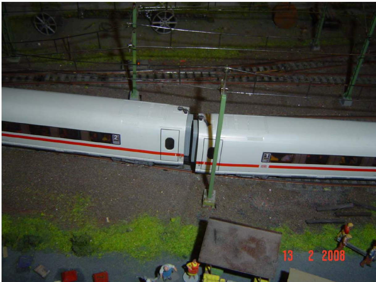
Nelle controcurve slanciate i soffietti sono appena allontanati (foto n.33)
