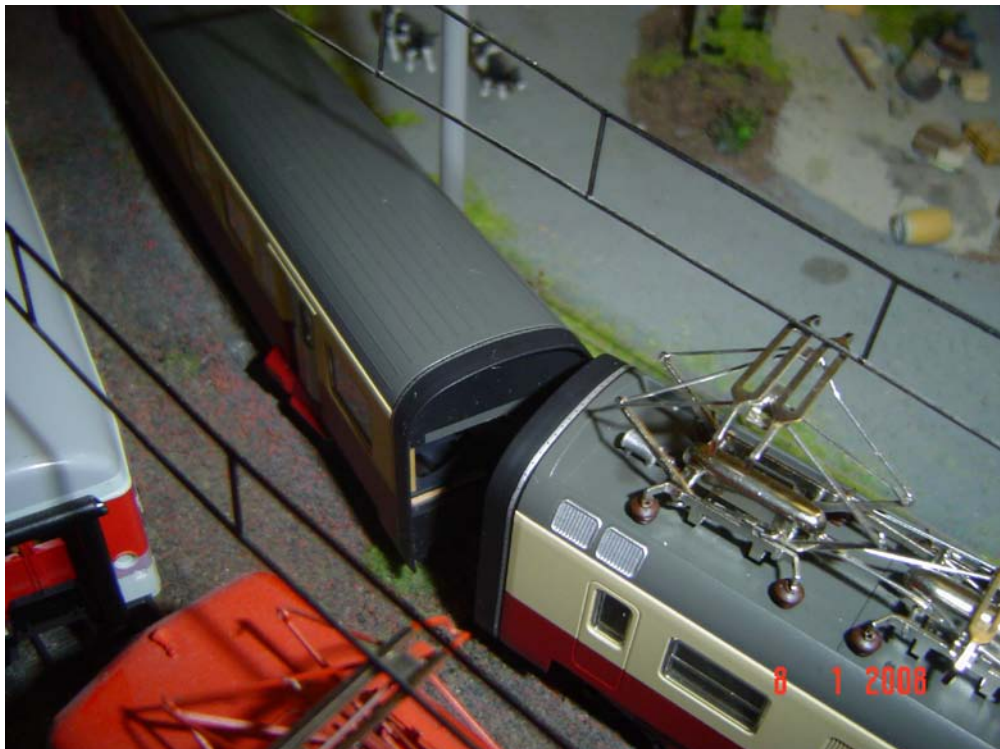
I soffietti sono appena accennati nel Gottardo e la vistosa apertura serve per il gancio verticale ed il suo timone d'allontanamento, il pantografo alzato è sbagliato! Il pantografo per la rete FS è il secondo. (Foto n. 34)
