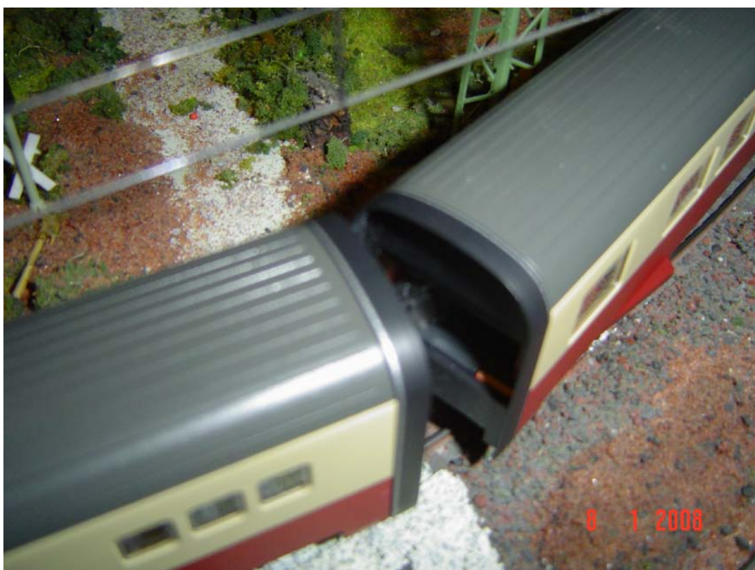
Il distacco verso l'esterno in curve strette dovuto ai timoni d'allontanamento (foto n. 7)
