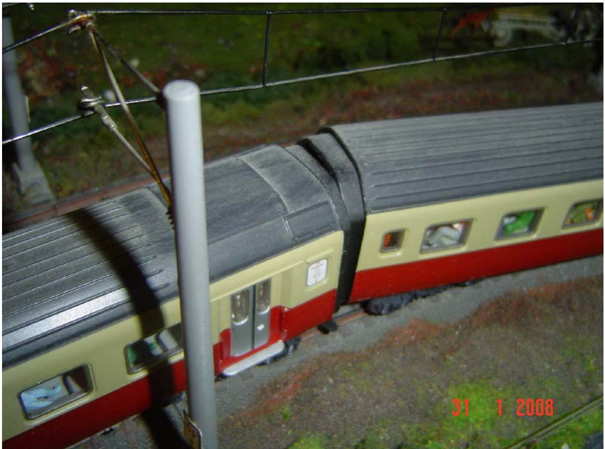
Anche nelle curve 24430 i soffietti sono aderenti (foto n. 11)
