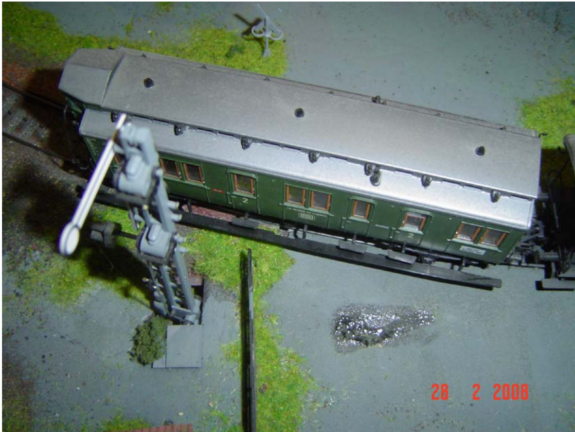
Sul tetto di "Prussiane" Roco gli aeratori tutti incollati (Foto n. 34)
