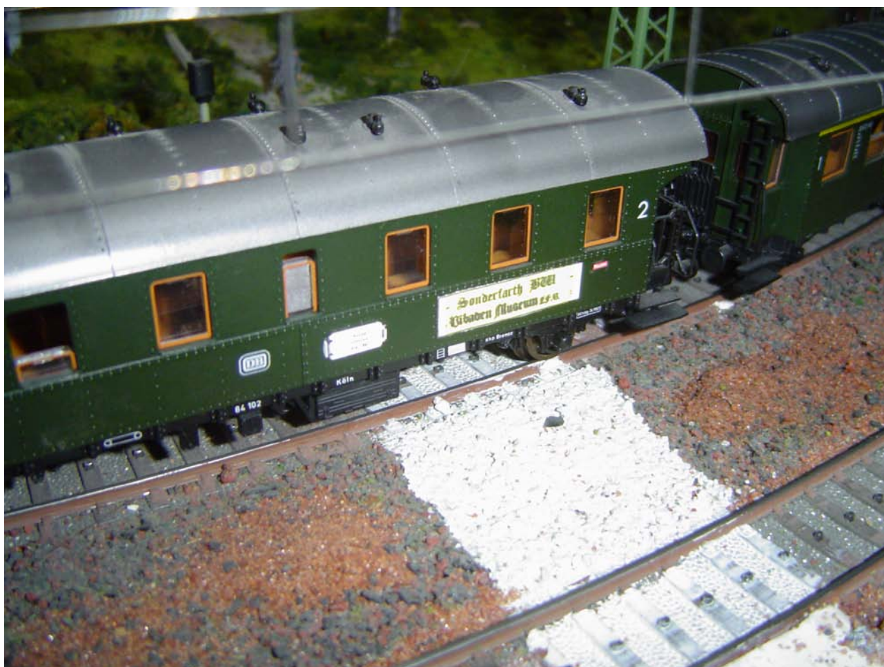
Sul tetto delle carrozze Roco (“scatole tonanti”) aeratori montati a parte (Foto n. 33)
