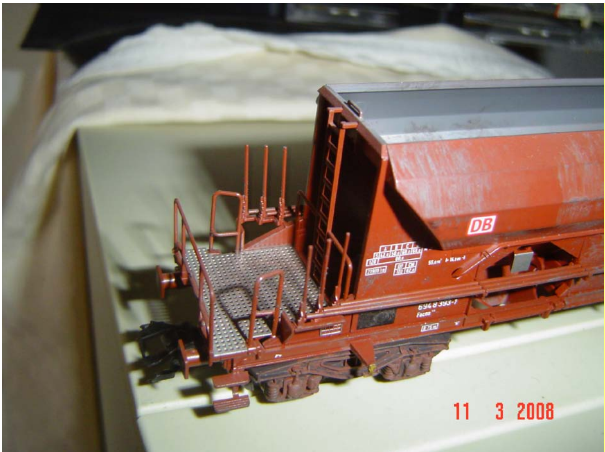
La pedana traforata del carro Facns 133 (Foto n. 75)
