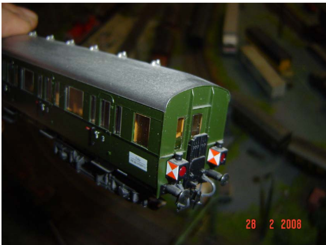
Sul tetto delle carrozze berlinesi Märklin gli aeratori sono stampati (Foto n. 35)
