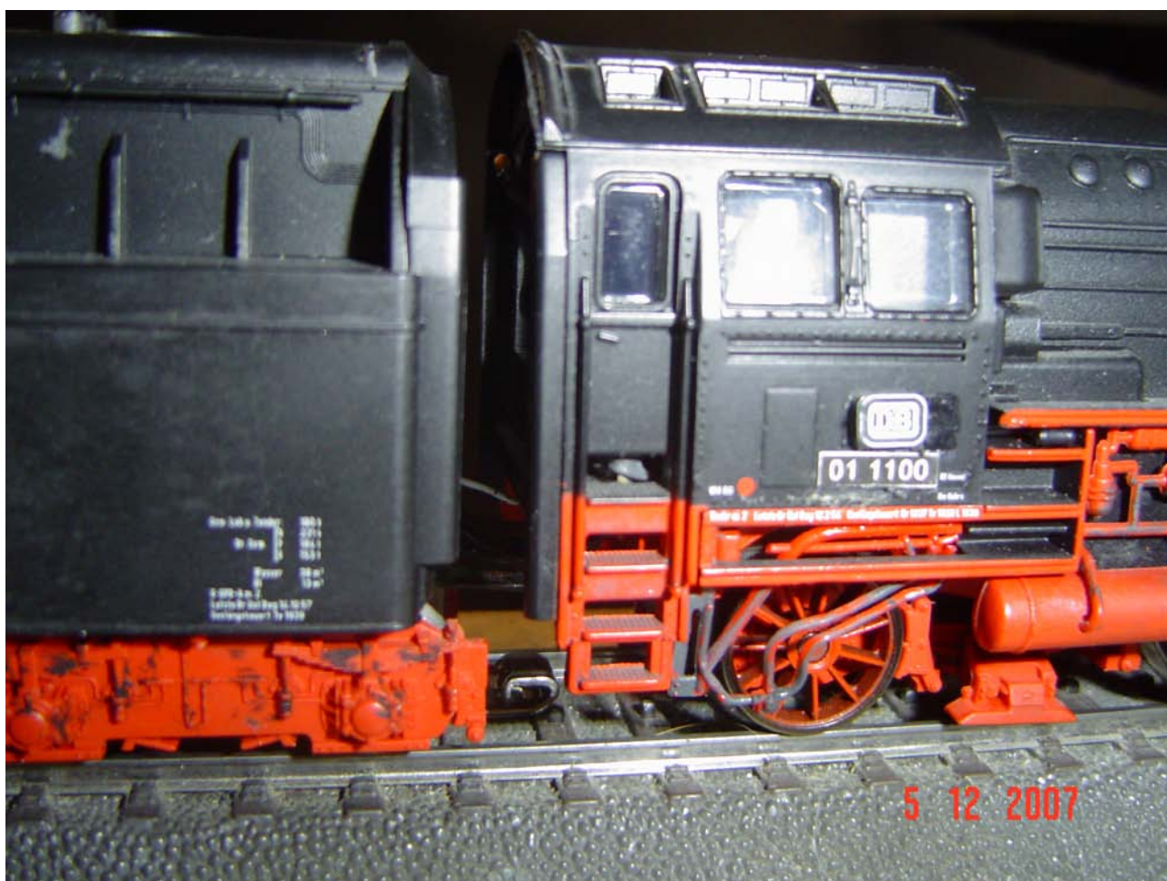
Il dispositivo Indusi nella Br 01 1100, situato proprio sotto il serbatoio rosso (Foto n. 14)
