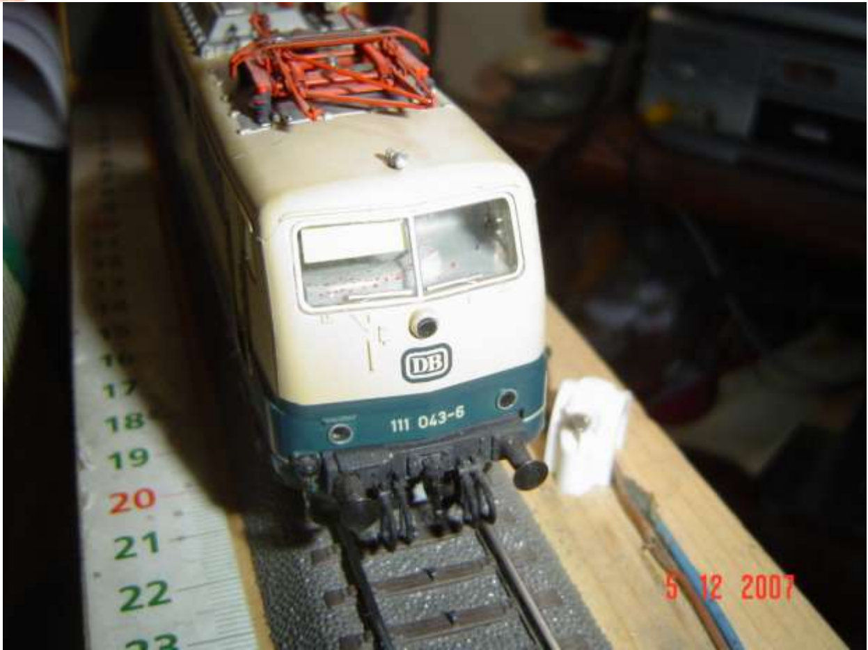
La 111, con tubi dei freni applicati dopo una lunga elaborazione (Foto n. 105)
