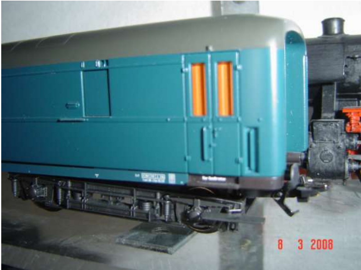
Uno dei tipi di scaletta o predellino di una carrozza ausiliaria (Foto n. 88)
