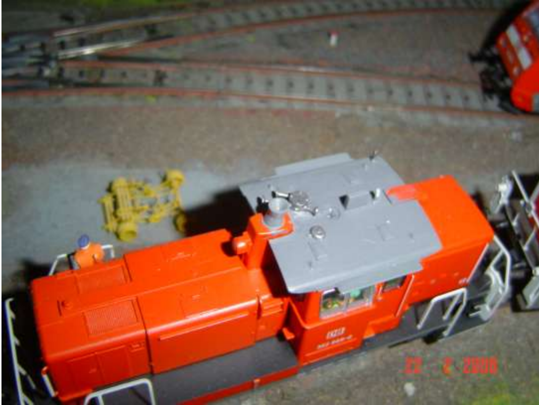
Fischio, antenne e trombe sul Dach (tetto) di una 362 DB AG (Foto n. 93)
