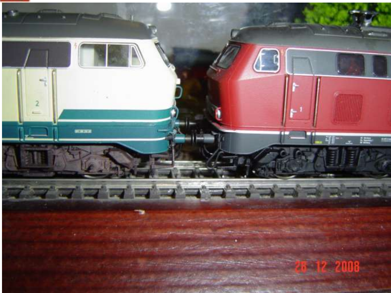
Due fori al posto della scaletta nella 218 a destra (foto n. 115)
