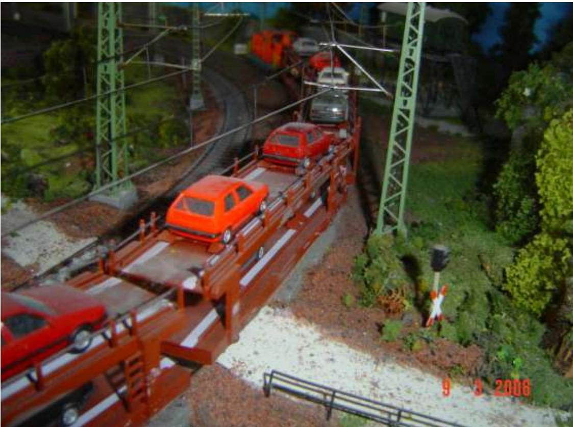
**Ricostruiti i tiranti del piano superiore, spezzati, con del refe (Foto n. 64)**
