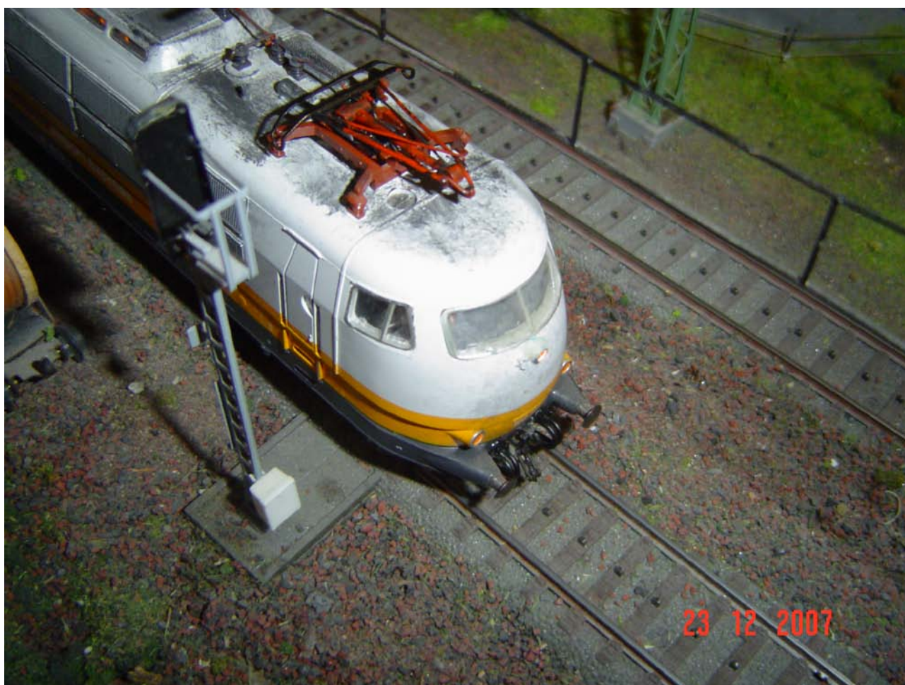
Pantografi nella 103 Lufthansa, con basetta e vite nuove (Foto n. 18)
