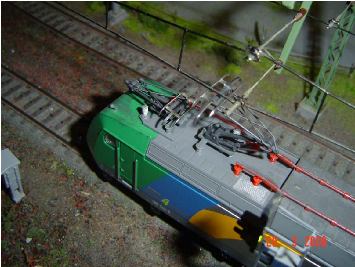
Nelle 185 bitensione si può alzare l'archetto interno in Germania (Foto n. 9)
