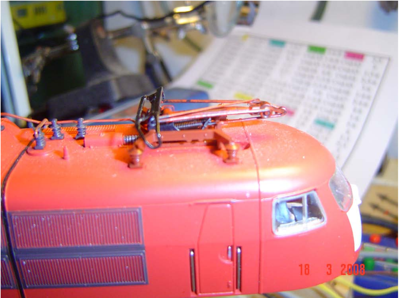
I pantografi 603391 sul tetto di una 103 (Foto n. 7)
