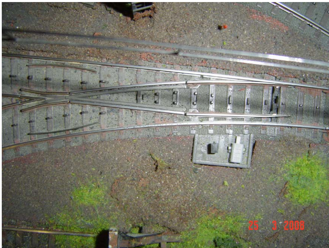
Le punte di contatto meno ravvicinate, nei deviatoi di raggio 24,3° (foto n. 5)
