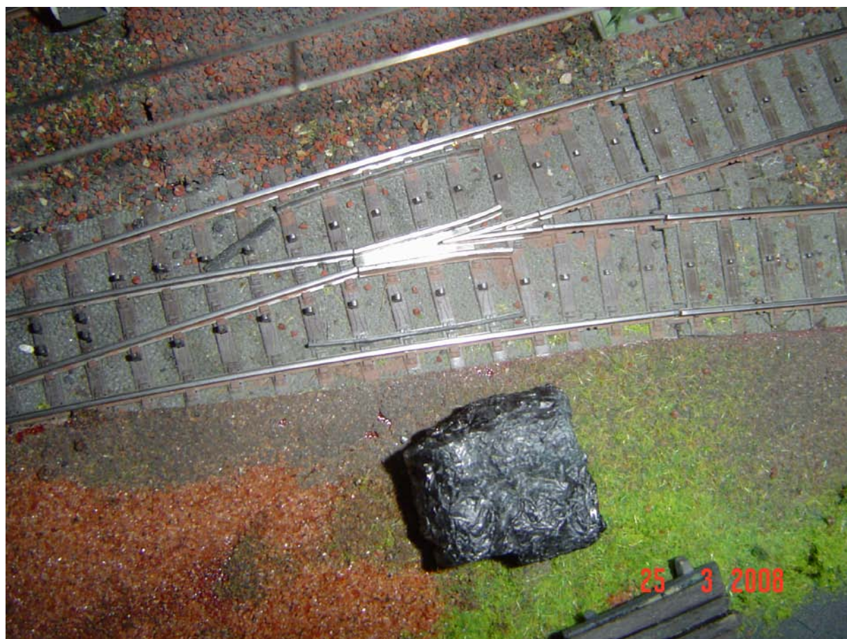
Il cuore del deviatoio slanciato può divenire un ostacolo per assi non perfetti (foto n. 3)
