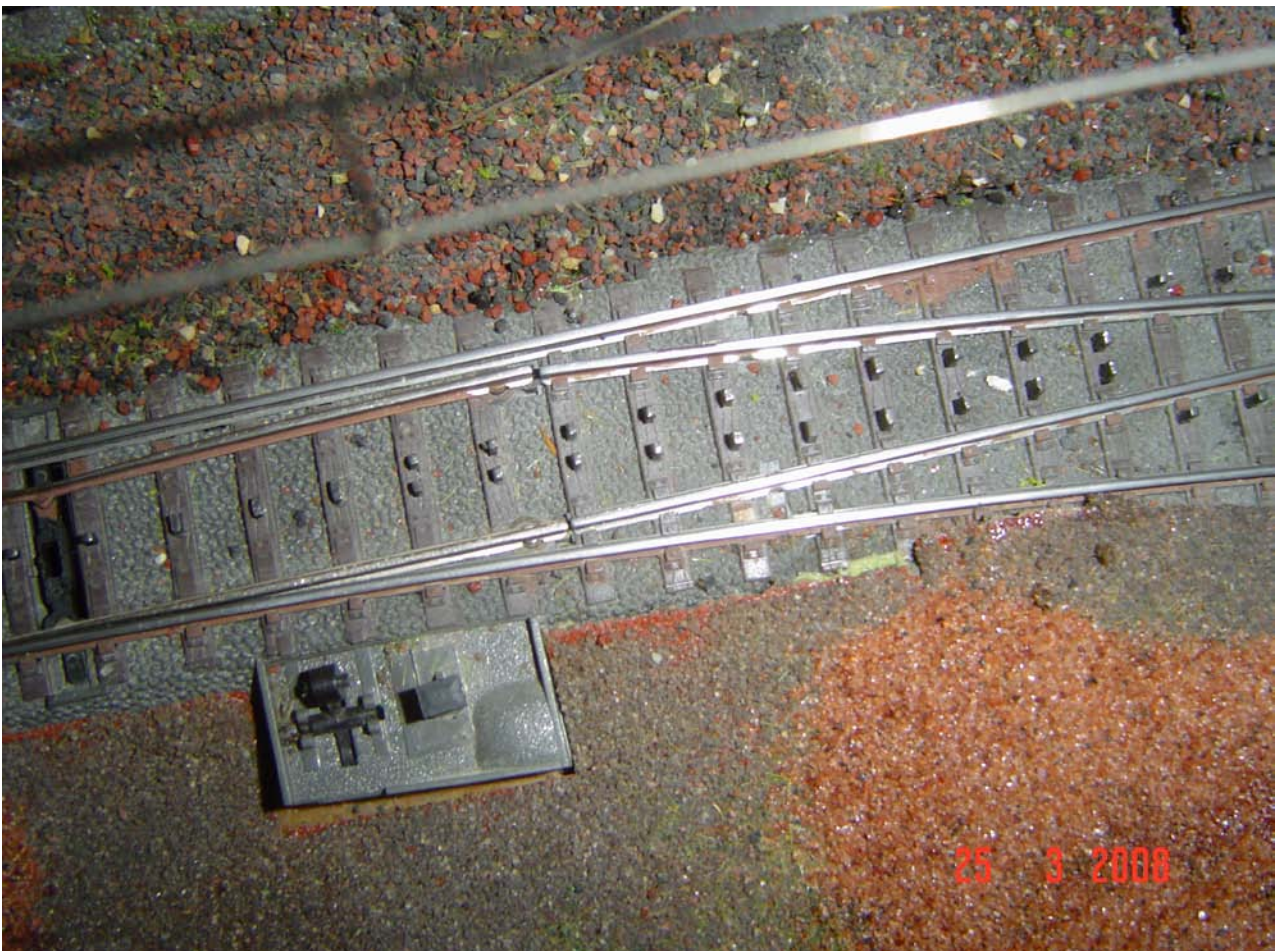
Le punte di contatto più ravvicinate ai binari causano corti con assi sotto i 14 mm (foto n. 4)
