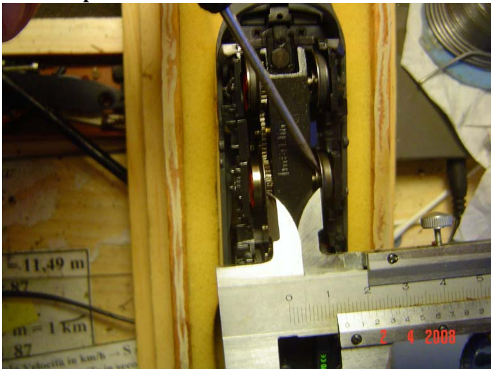
Ulteriore verifica con il calibro di un altro asse (foto n. 38)
