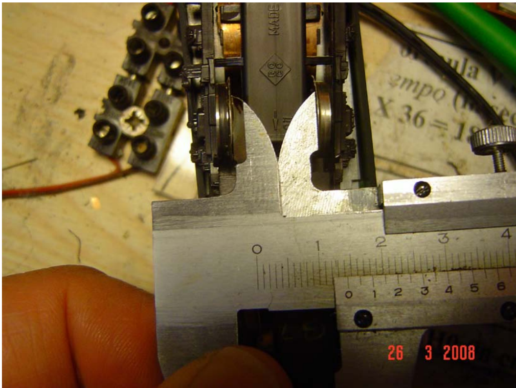
Il passo interno degli assi è di 14,3 mm (foto n. 14)
