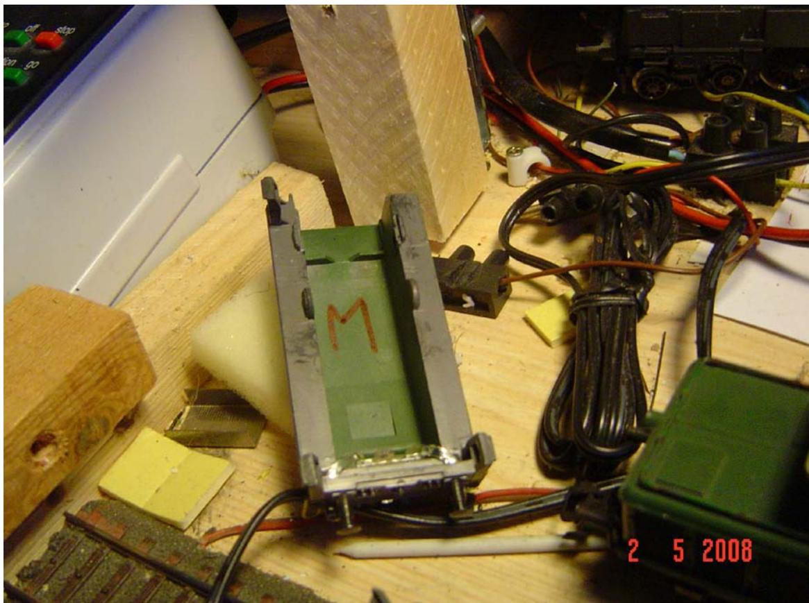
Il cofano motore marcato con una “M” per evitare errori nel rimontaggio (foto n. 12)
