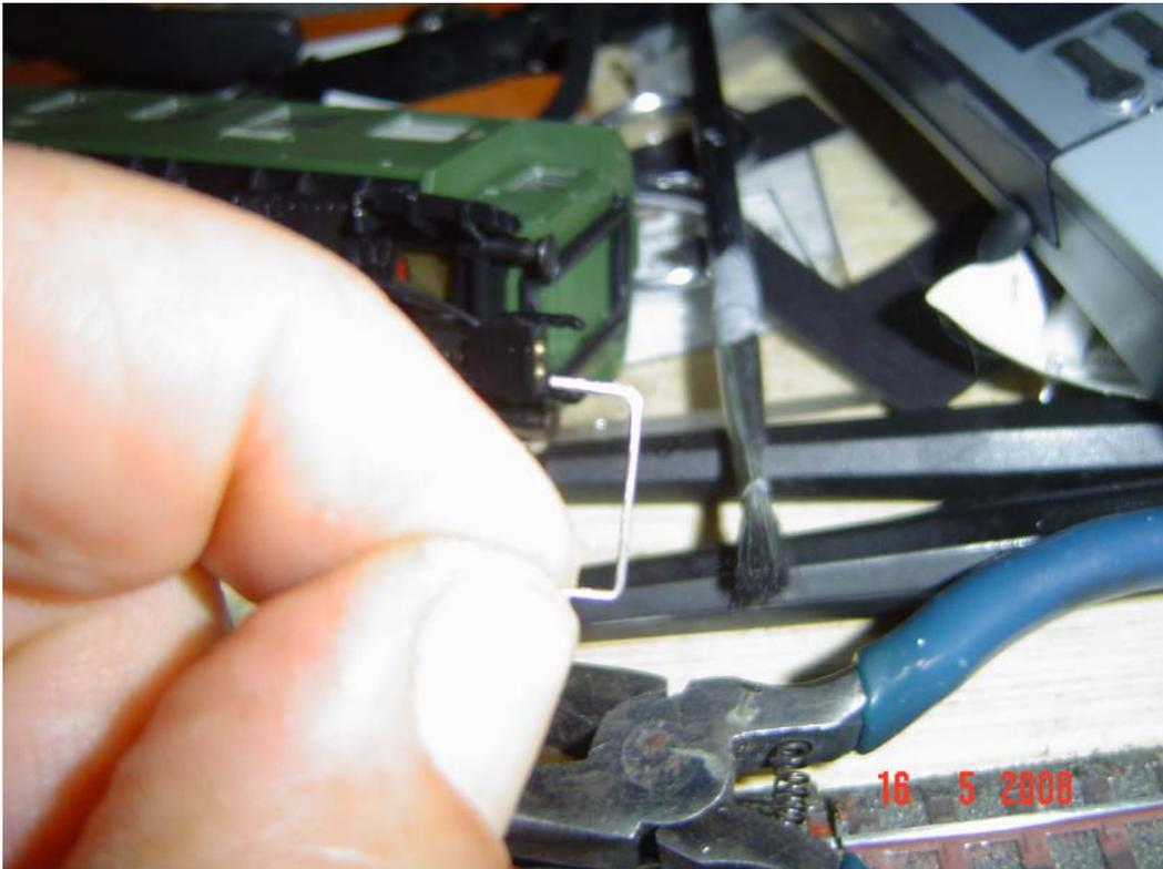
Con una pinzetta si separano i punti metallici (foto n. 35)
