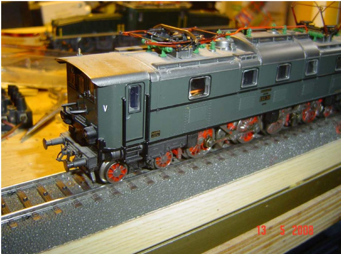
Si rimonta la carrozzeria dell'E 52 sul telaio del locomotore Br 152 (foto n. 26)
