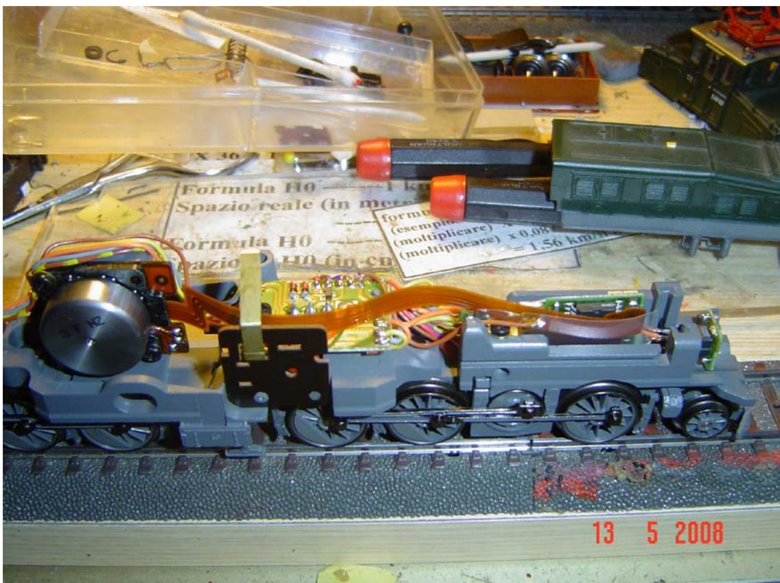
Il collegamento multipolare tra decoder e motore (foto n. 5)
