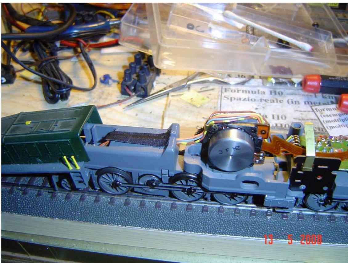
La zavorra per il motore C-Sinus prima versione nel Ce 6/8 III del 2001 (foto n. 4)
