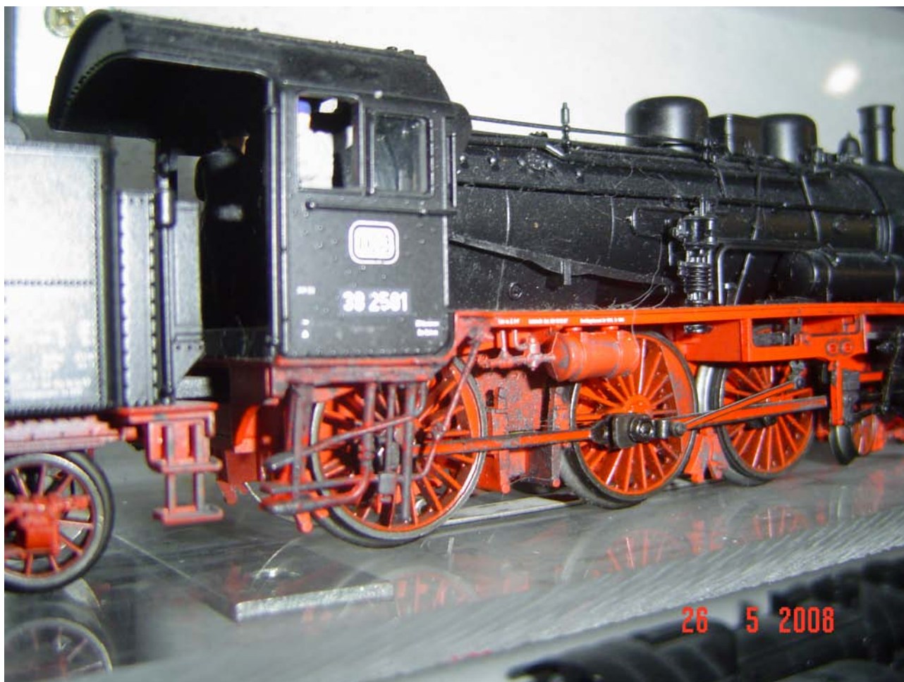
Nella mia Br 38 del 2003 le condutture rosse sostituite sul lato destro (foto n. 6)
