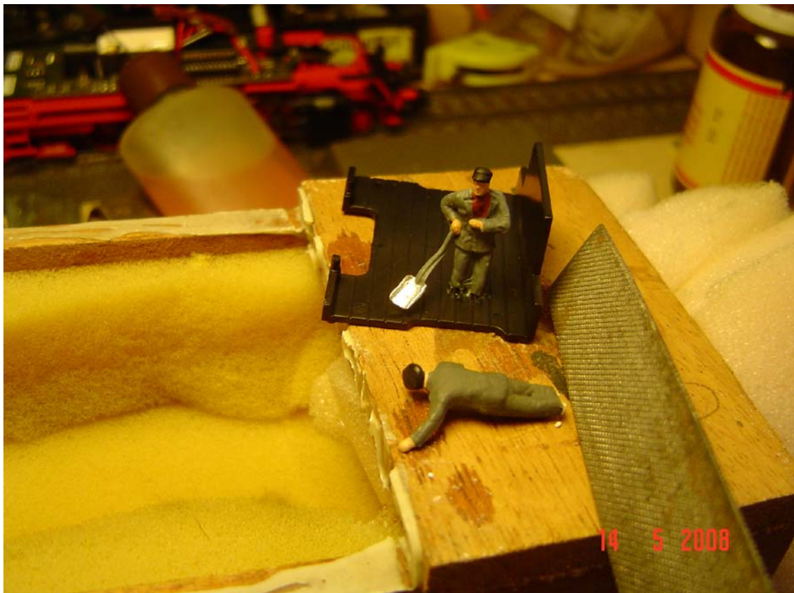
Al Lokführer viene limata la zona tagliata per facilitare l'incollaggio (foto n. 15)
