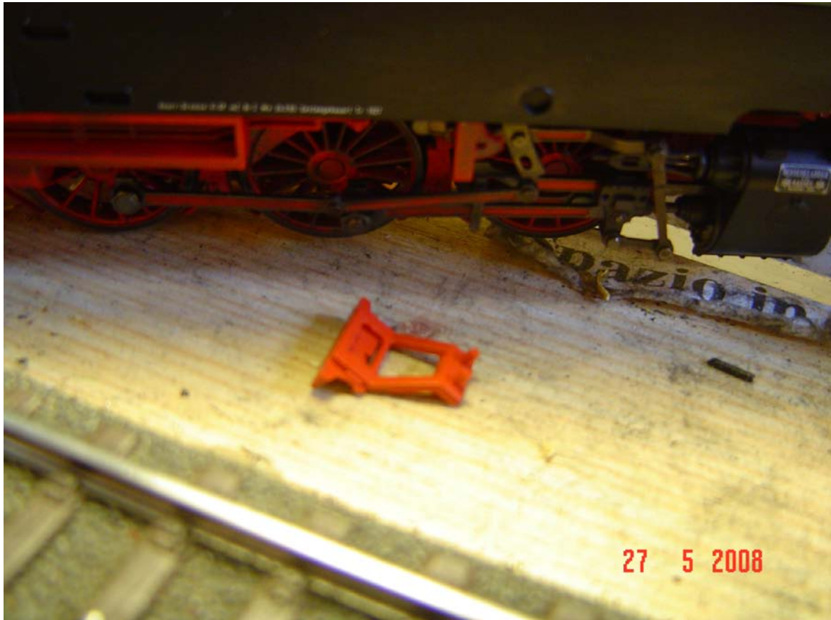
Uno dei due Indusi è uscito dalla sede (foto n. 25)
