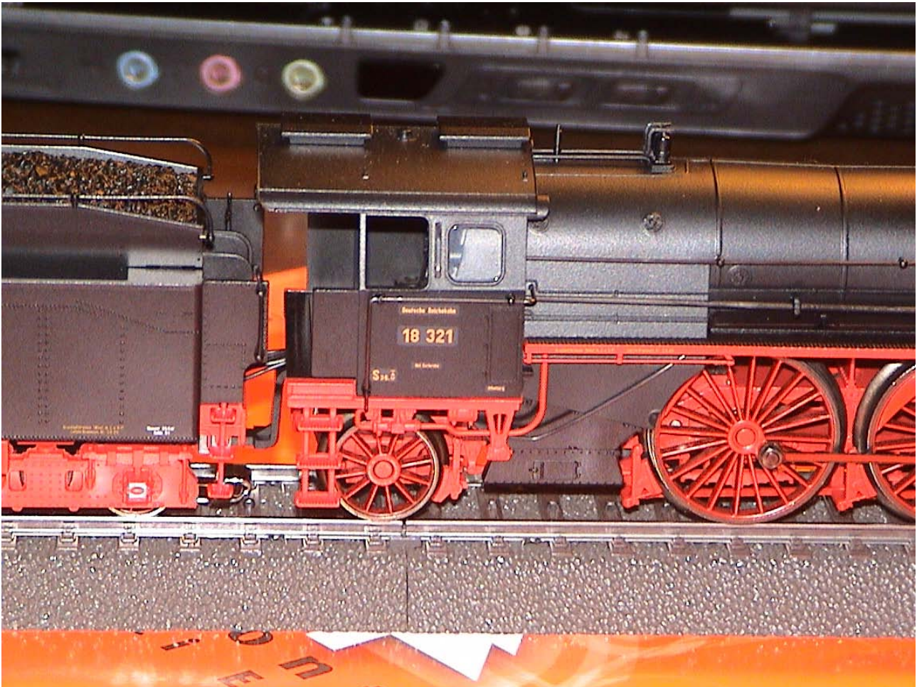
Lato destro, notare le chiodature delle portelle di spurgo in basso (foto n. 7, di D. Cusimano)
