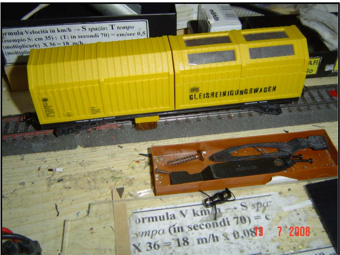
Carrelli del carro aspirapolvere, si noti lo spazzolone sotto il motore (foto n. 7)
