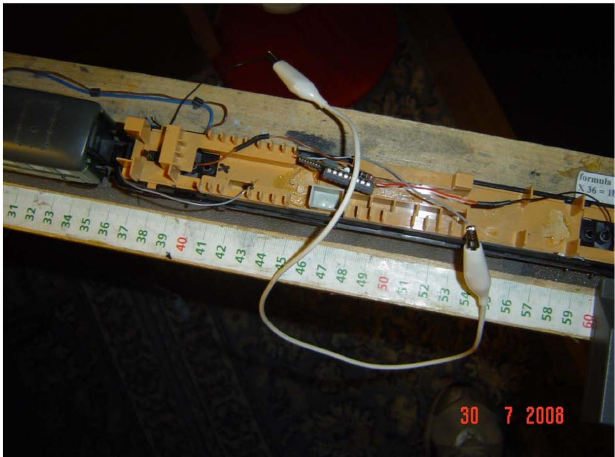
Collegamento con *banane* bianche per il filo di funzione, gli altri sono già saldati (foto n. 6)
