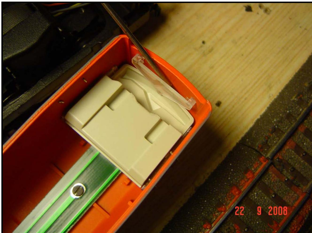
**Foto 23: si insinua delicatamente tra carrozzeria e diffusore un cacciavite**
