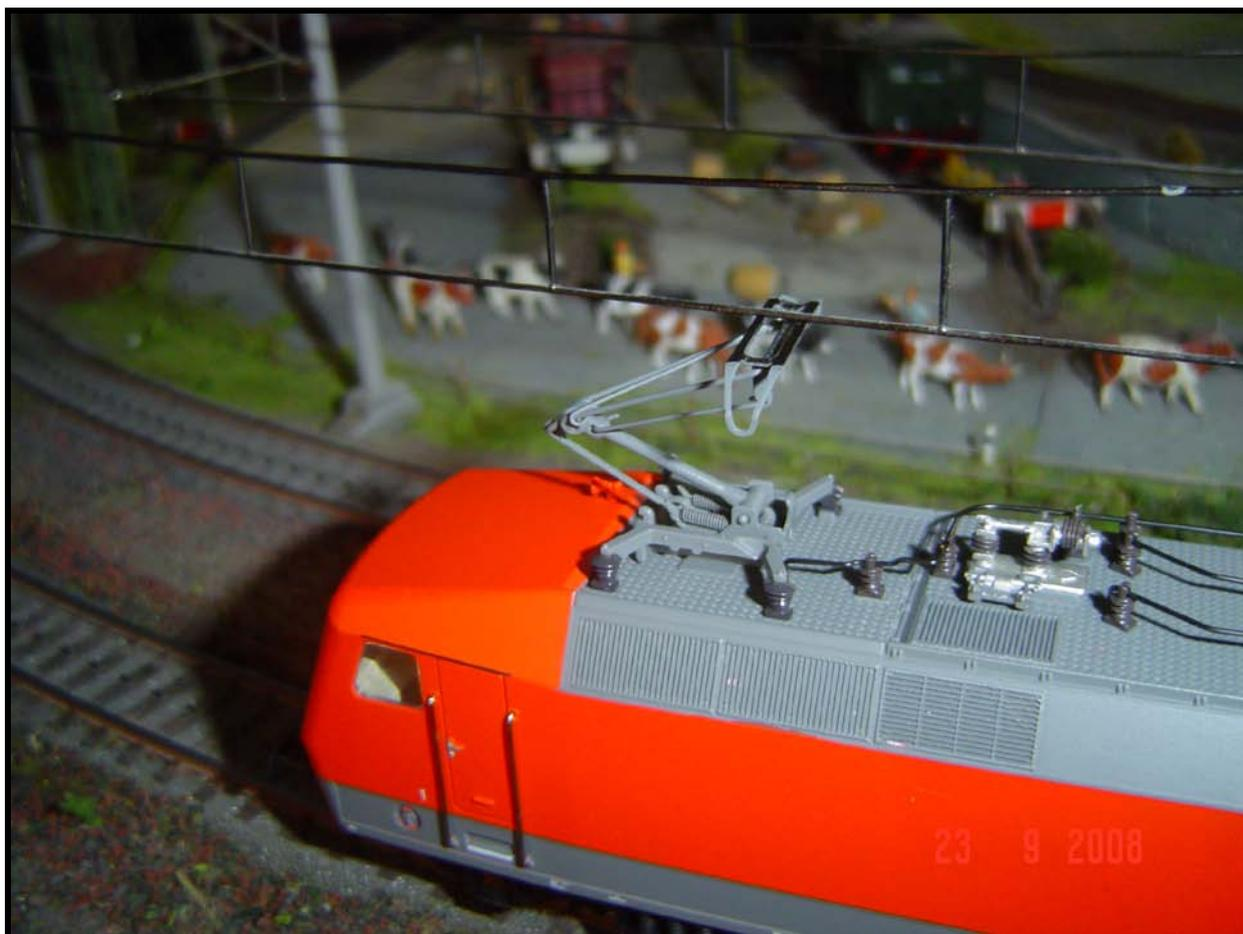
Foto n. 5: la 120 del 2008 monta pantografi e basette verniciati come al vero in grigio
