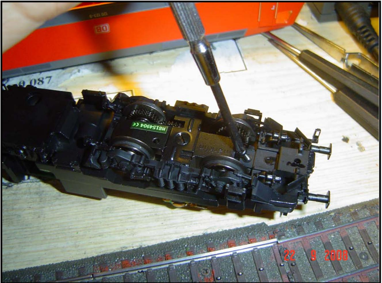
Foto n. 34: si rimonta il copri carrello, definitivamente, avvitando la vite anteriore
