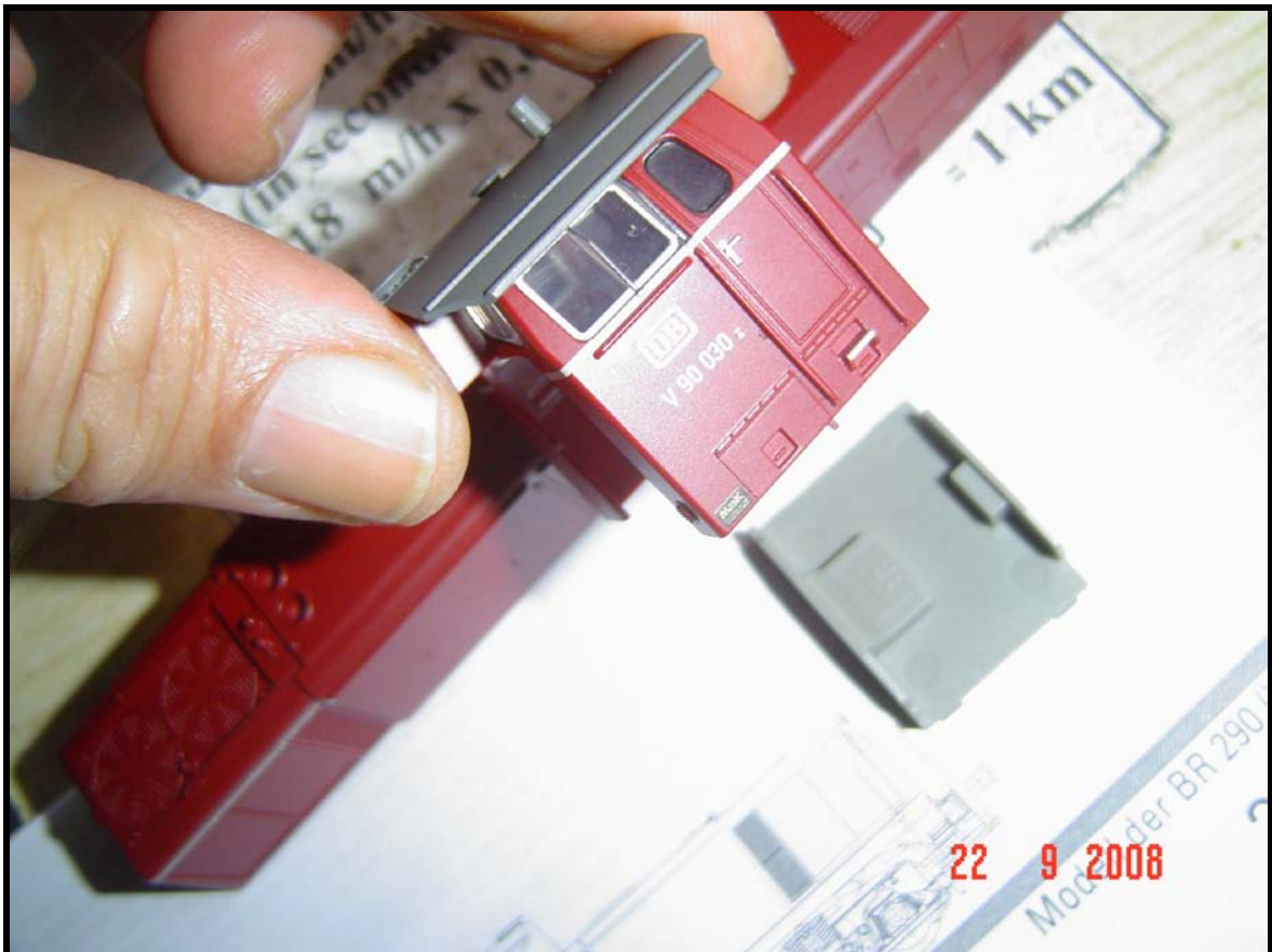
La cabina si sfilava dall'alto dopo aver disimpegnato il mantello dal telaio FOTO N. 10
