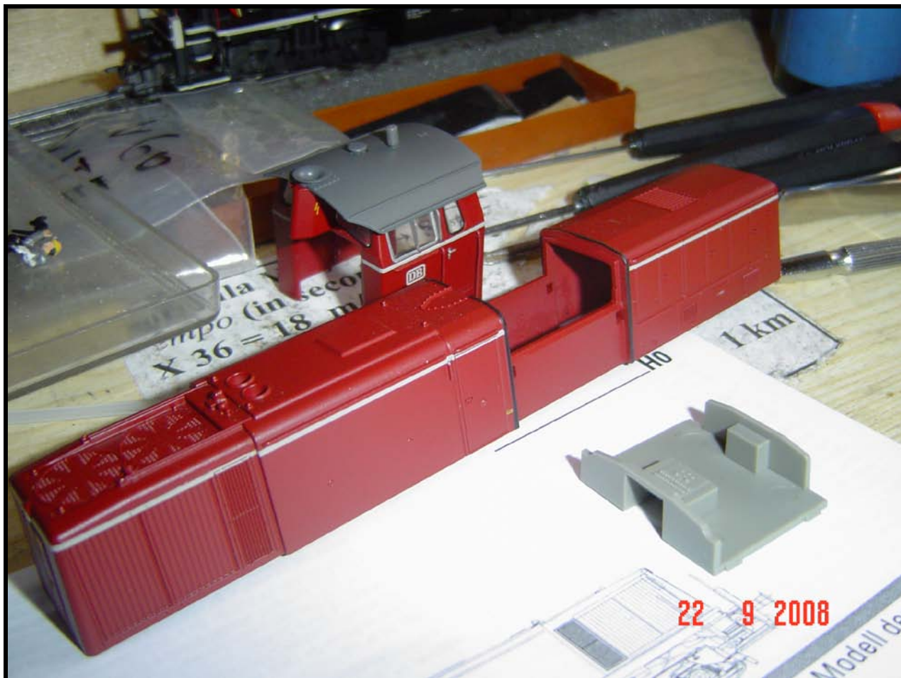
Locomotiva del gruppo V 90 030, con cabina e arredamento interno smontati FOTO N. 7
