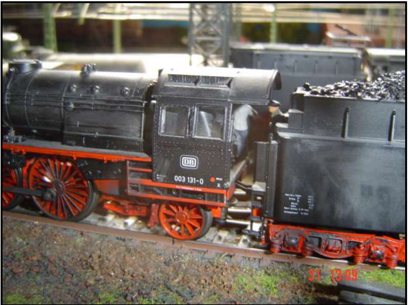
Pattino ben visibile nelle 003 a causa la eccessiva distanza del tender (foto n. 40)
