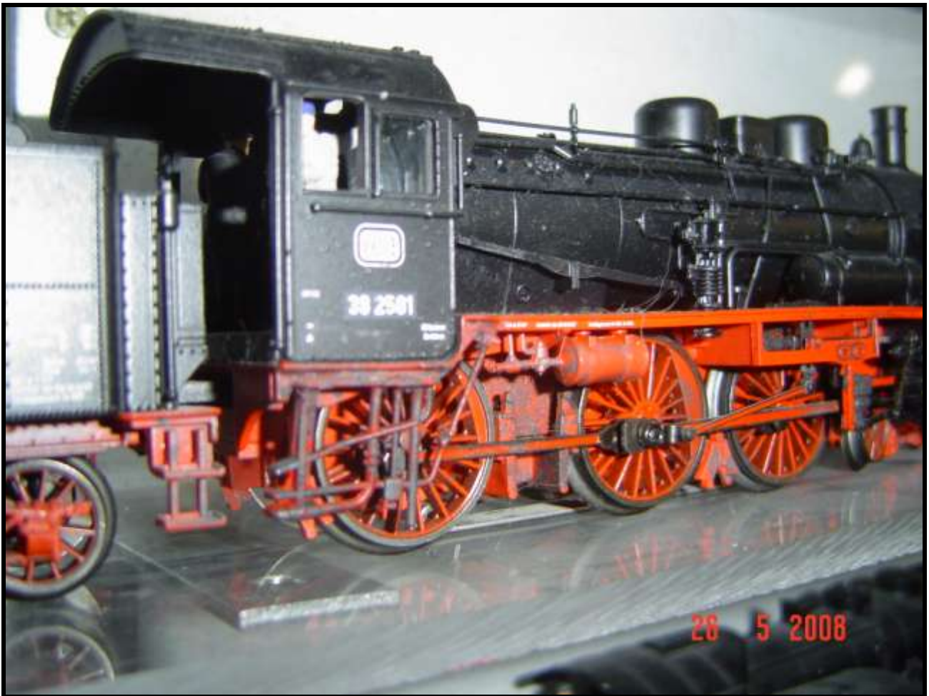
La Br 38 ha il pattino sotto la caldaia (foto n. 45)
