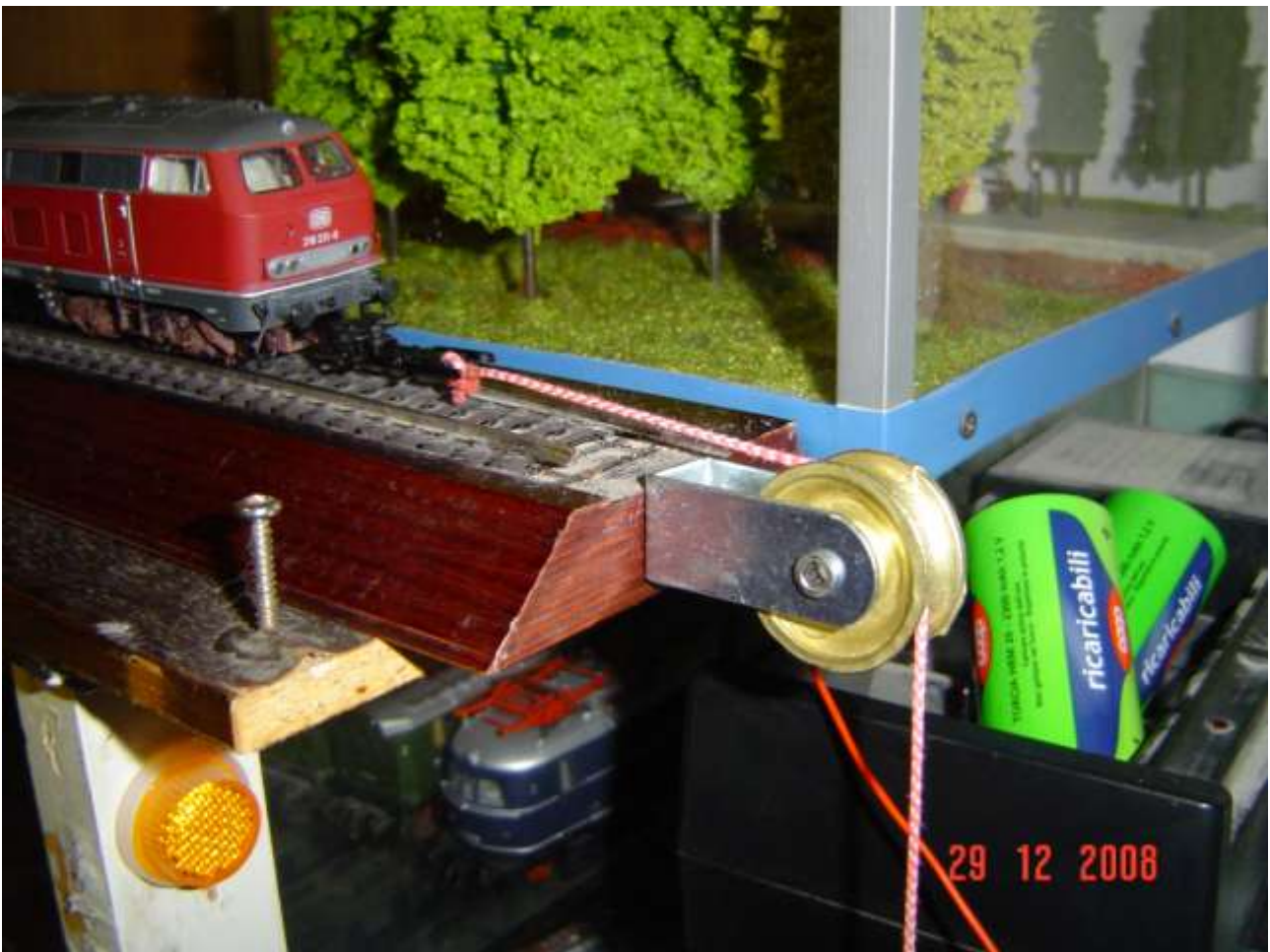
Particolare del banco Dinamometrico: la zona della carrucola (foto A)
