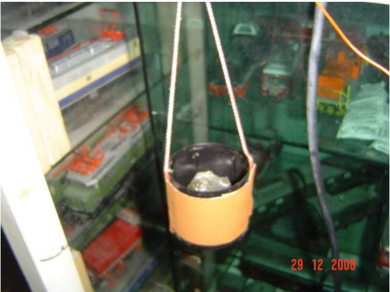
Particolare del cestello che raccoglie i pesi di piombo (foto D)
