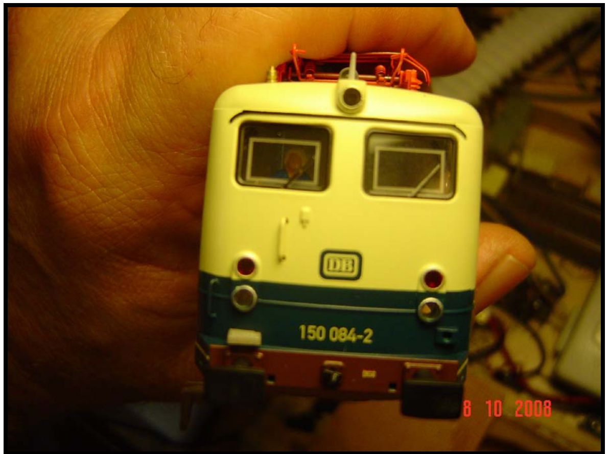
I finestrini con dispositivo sbrinamento e la macchinista (Foto n. 27 e 28)
