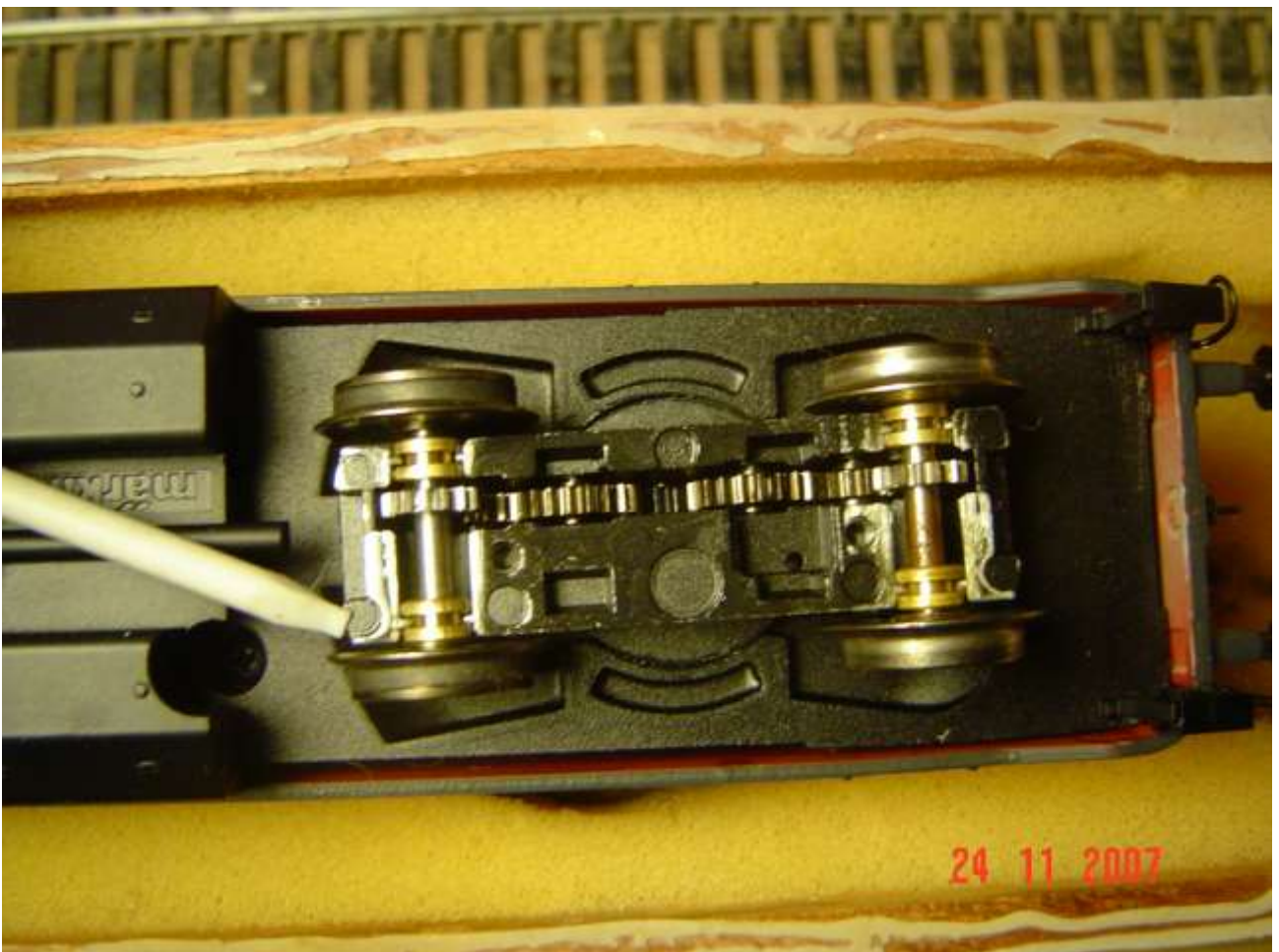
l'asse con cerchiature e posizione ingranaggi foto 13
