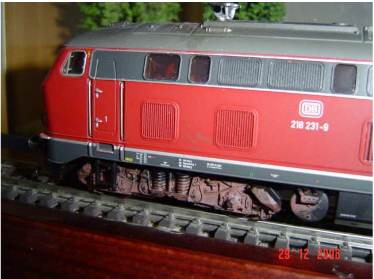
I carrelli delle due versioni di 218 sono sporcati con grafite rossa e nera, foto 19
