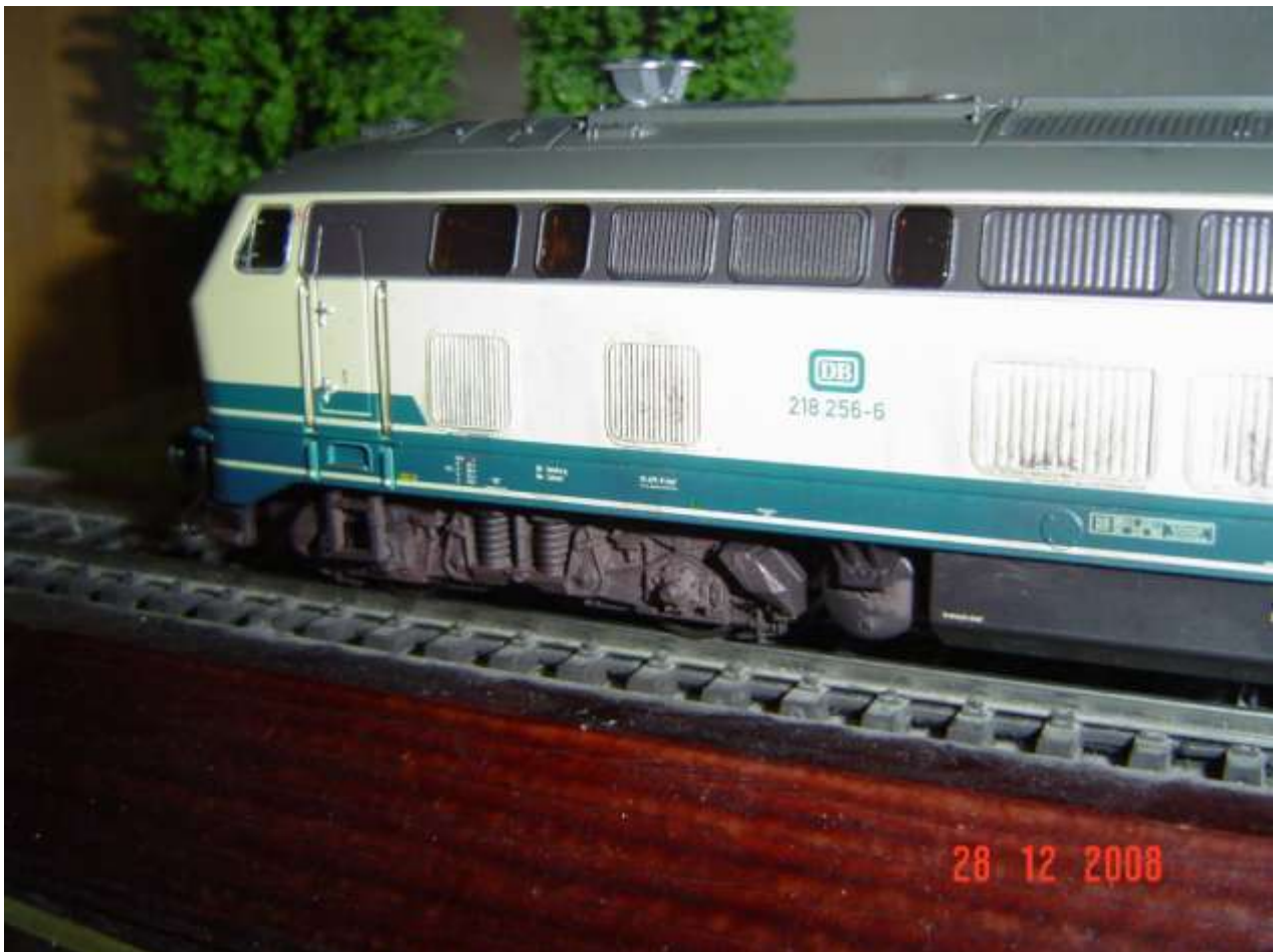
I carrelli delle due versioni di 218 sono sporcati con grafite rossa e nera, foto 20
