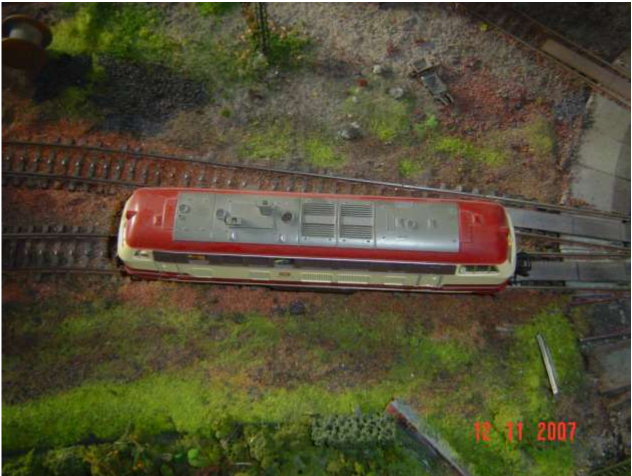
foto n. 4: sul tetto della 218 Hobby c'è ancora la vistosa vite delle 216, la posizione degli essiccatori è comunque corretta e nei primi periodi non erano nemmeno presenti
