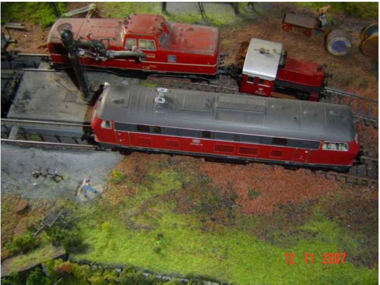
foto n. 5: diversa (e corretta) la posizione degli essiccatori sul tetto nella nuova 218
