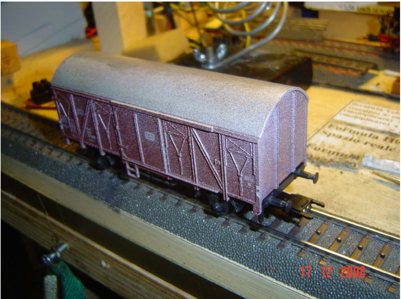
Foto n. 38 e 39: i piombini e il montaggio della sovrastruttura del carro Gs.
