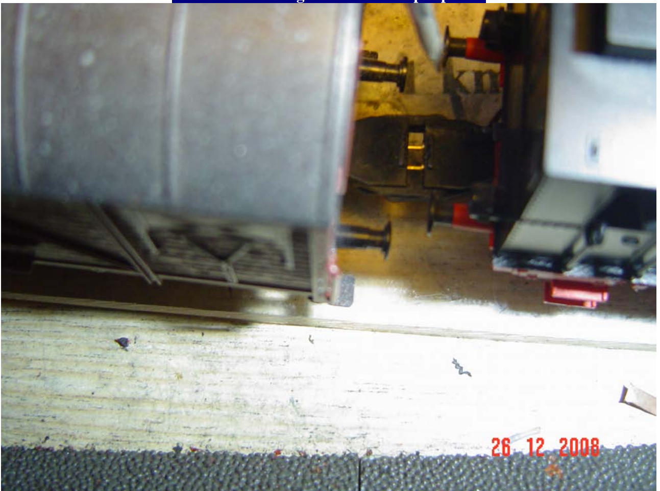
Foto n. 30 e 31: il gancio innestato per prova.
