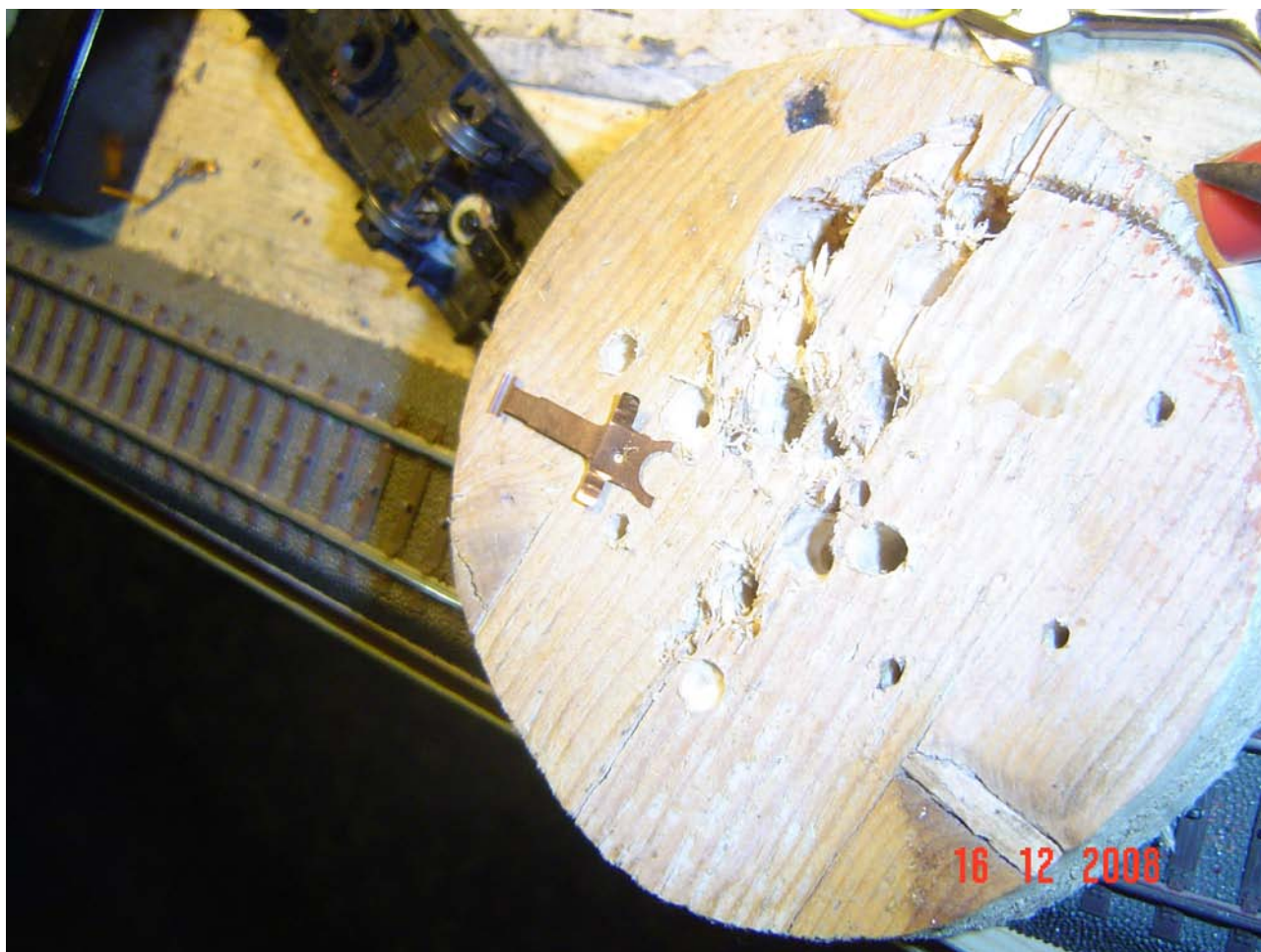
Foto n. 22: la lamella del vecchio pattino è pronta.
