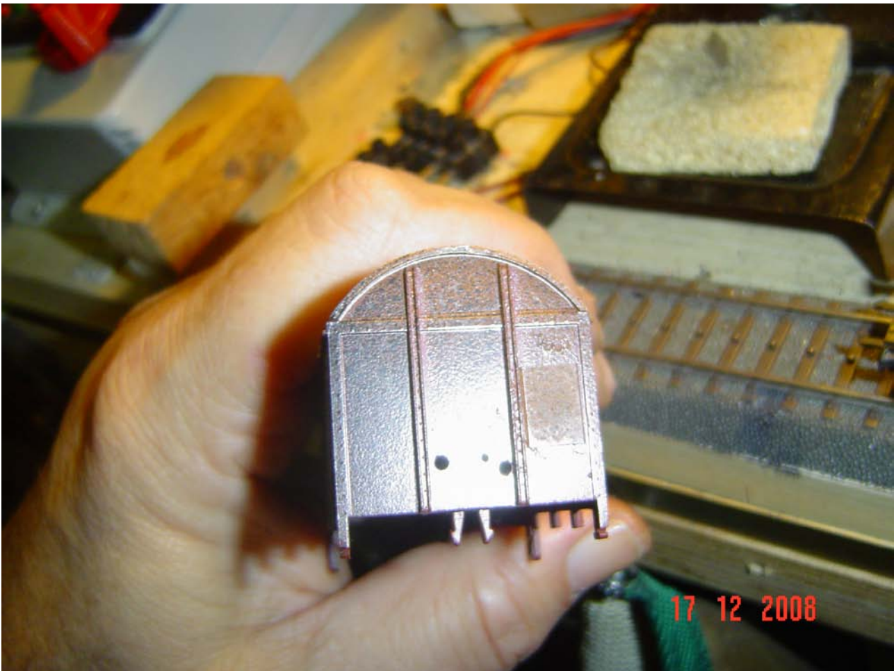
Foto n. 3: fori per il passaggio dei fili in uno dei due carri “Gs uv-213”
