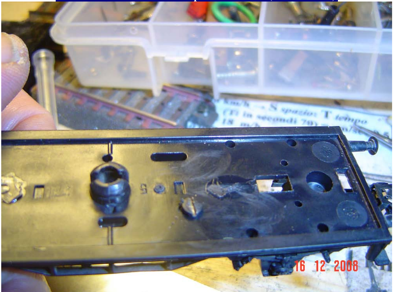
Foto n. 24: la lamella del vecchio pattino è avvitata (vista dall'alto).
