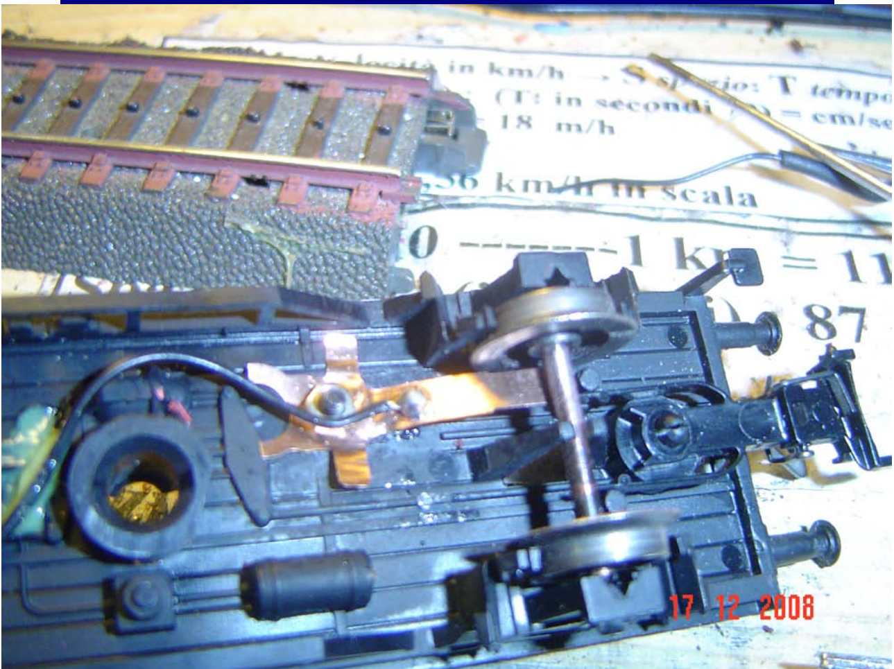
Foto n. 33 e 34: si salda un filo alla lamella di massa e si ferma il cavo con silicone.
