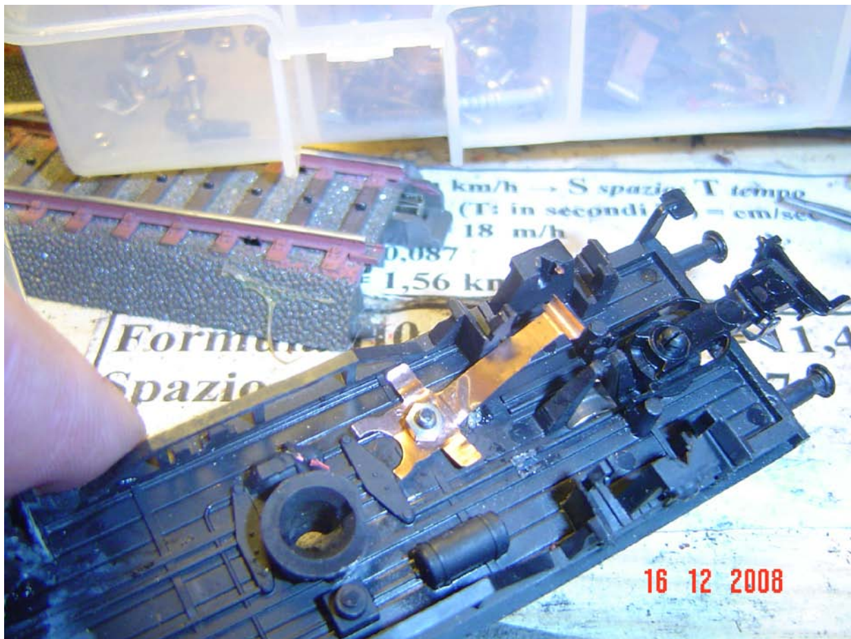
Foto n. 25: la lamella del vecchio pattino è avvitata e pronta a ricevere l'asse
