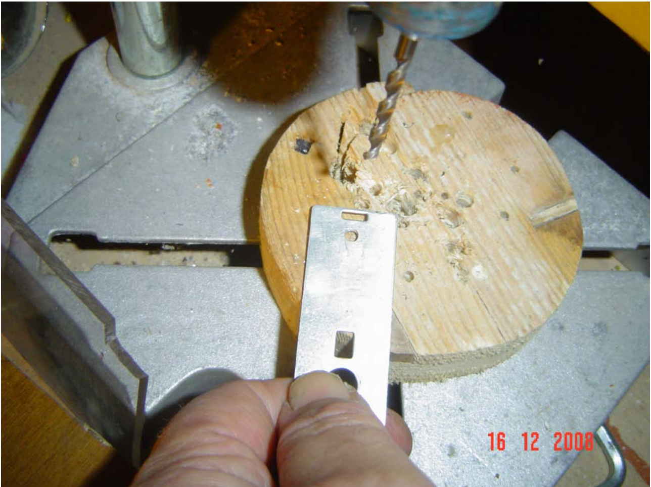
Foto n. 16: col trapano e punte successive si allarga il foro "A"
