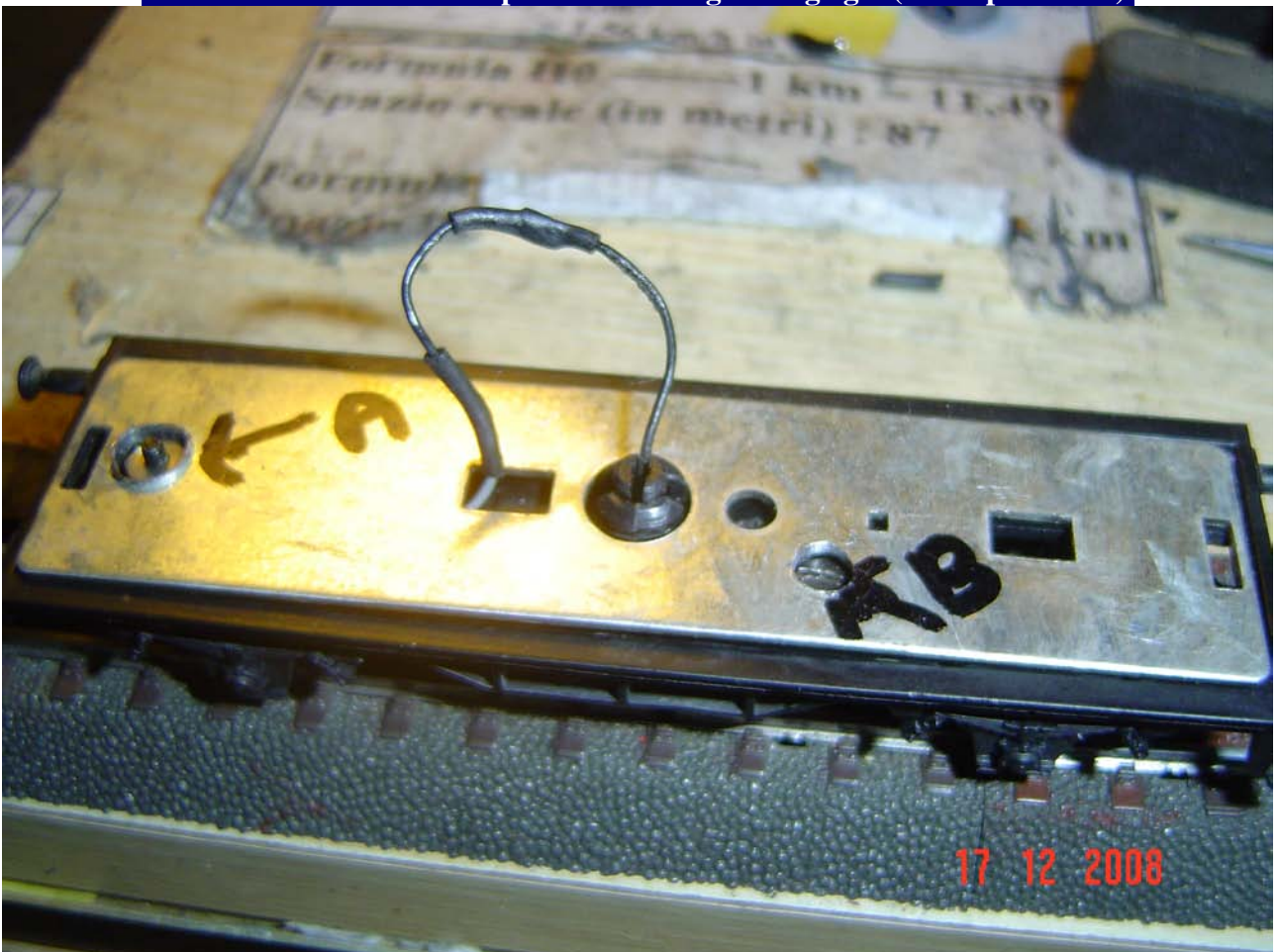
Foto n. 36 e 37: il cavo del pattino va collegato al grigio (scelta personale).
