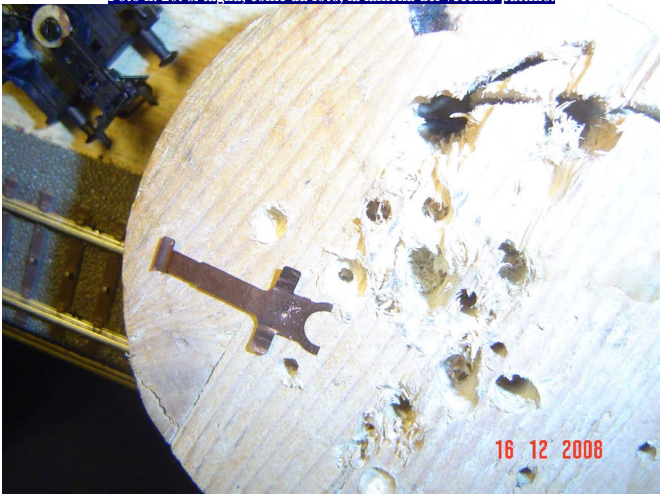
Foto n. 21: si "punzona" e poi si fora, come da foto, la lamella del vecchio pattino.
