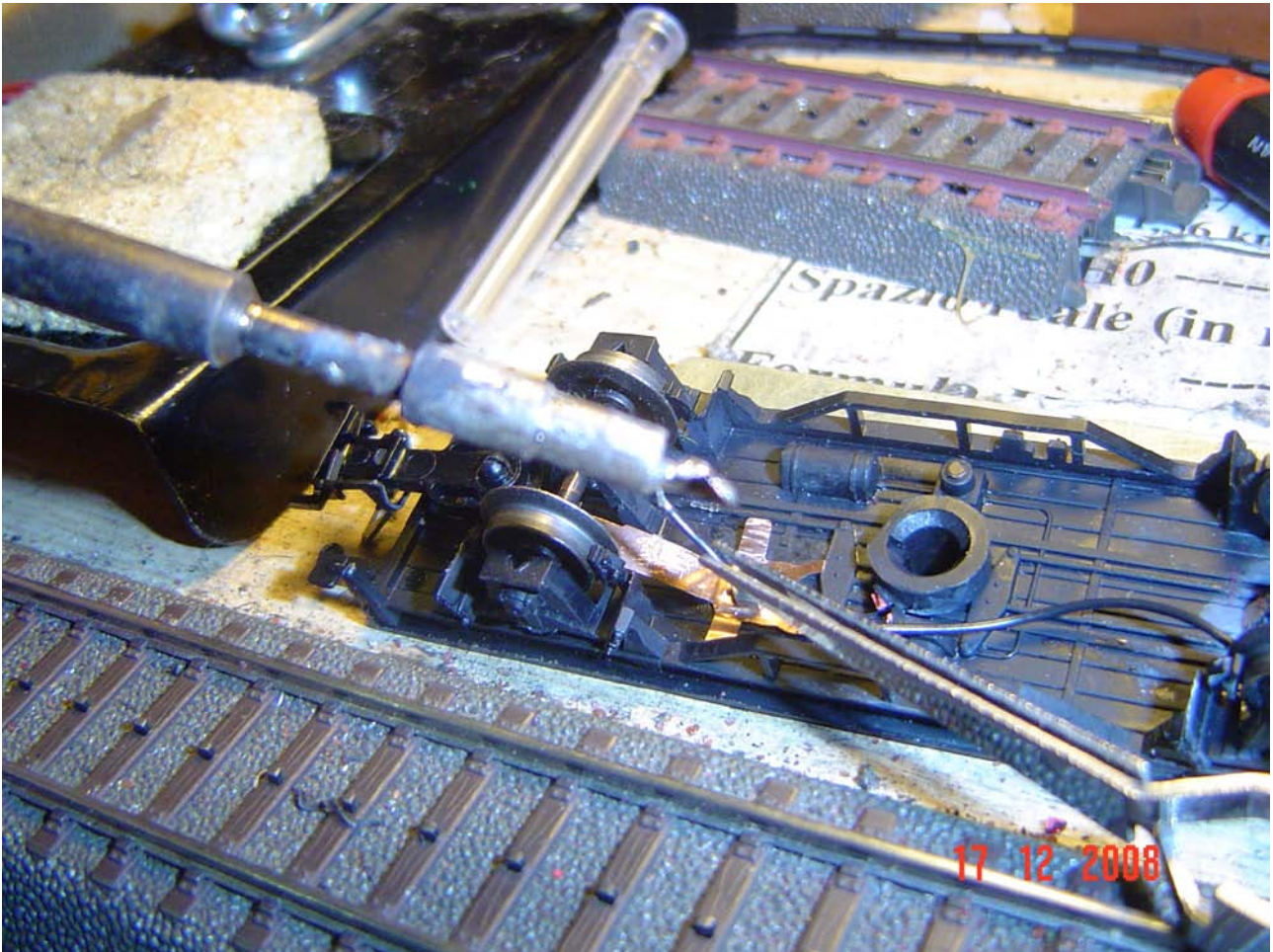
Foto n. 33 e 34: si salda un filo alla lamella di massa e si ferma il cavo con silicone.
