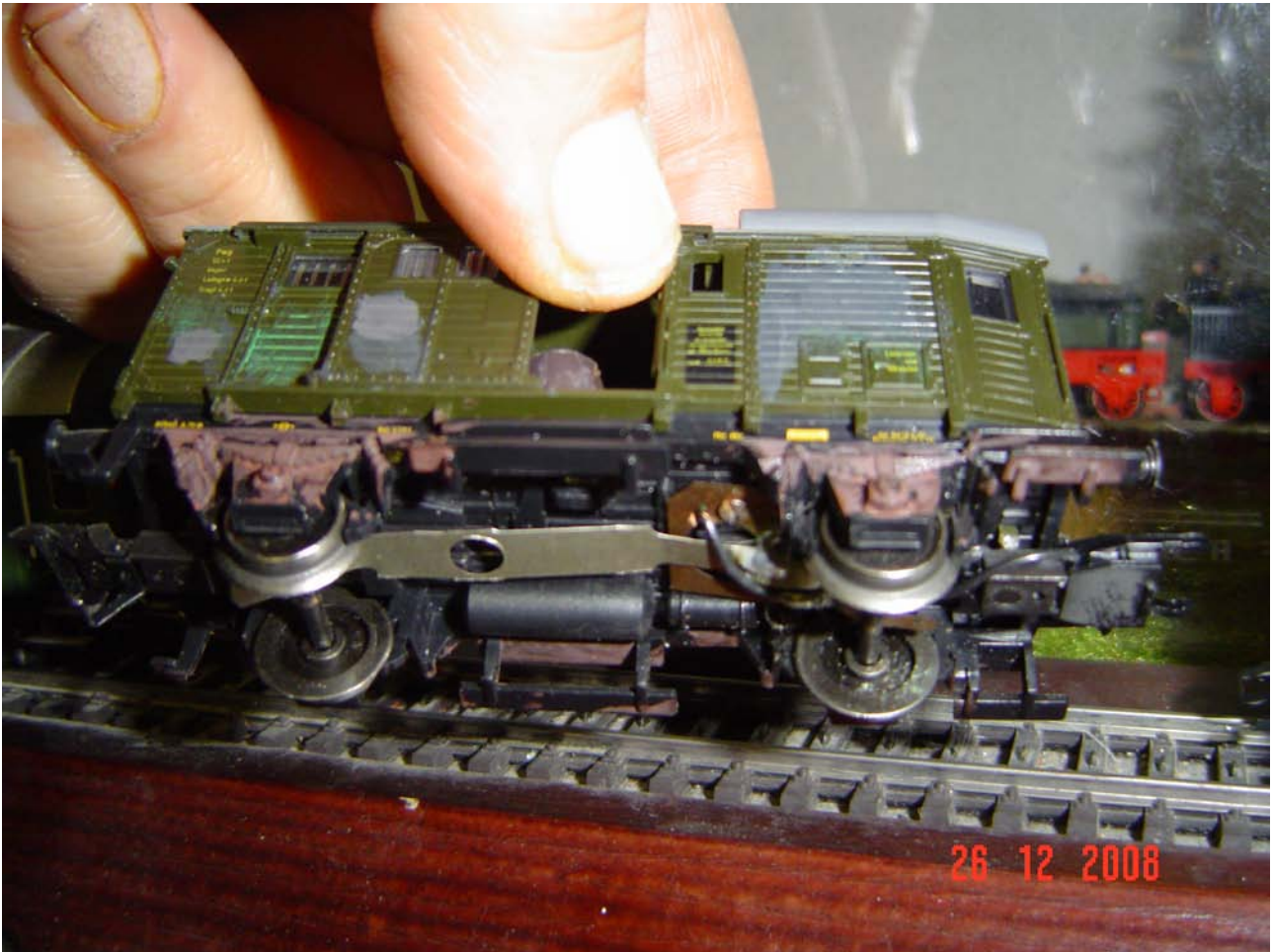
Foto n. 52: il carro Pwg con una lamella porta massa per ambedue gli assi.
