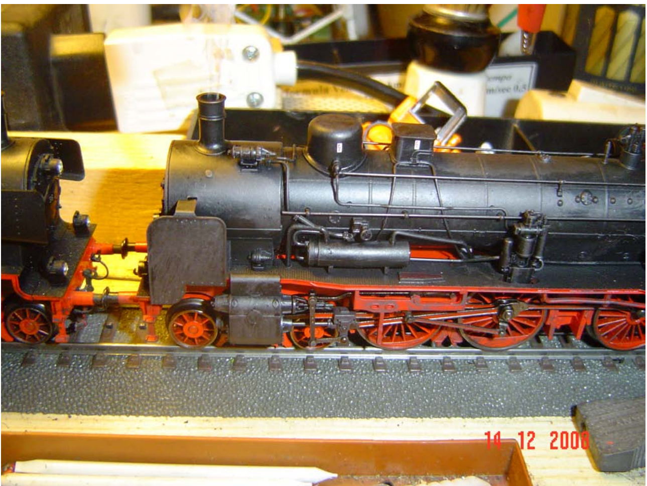
Foto n. 55: particolare della caldaia grafitata della Br 38 1885 sul banco di prova
