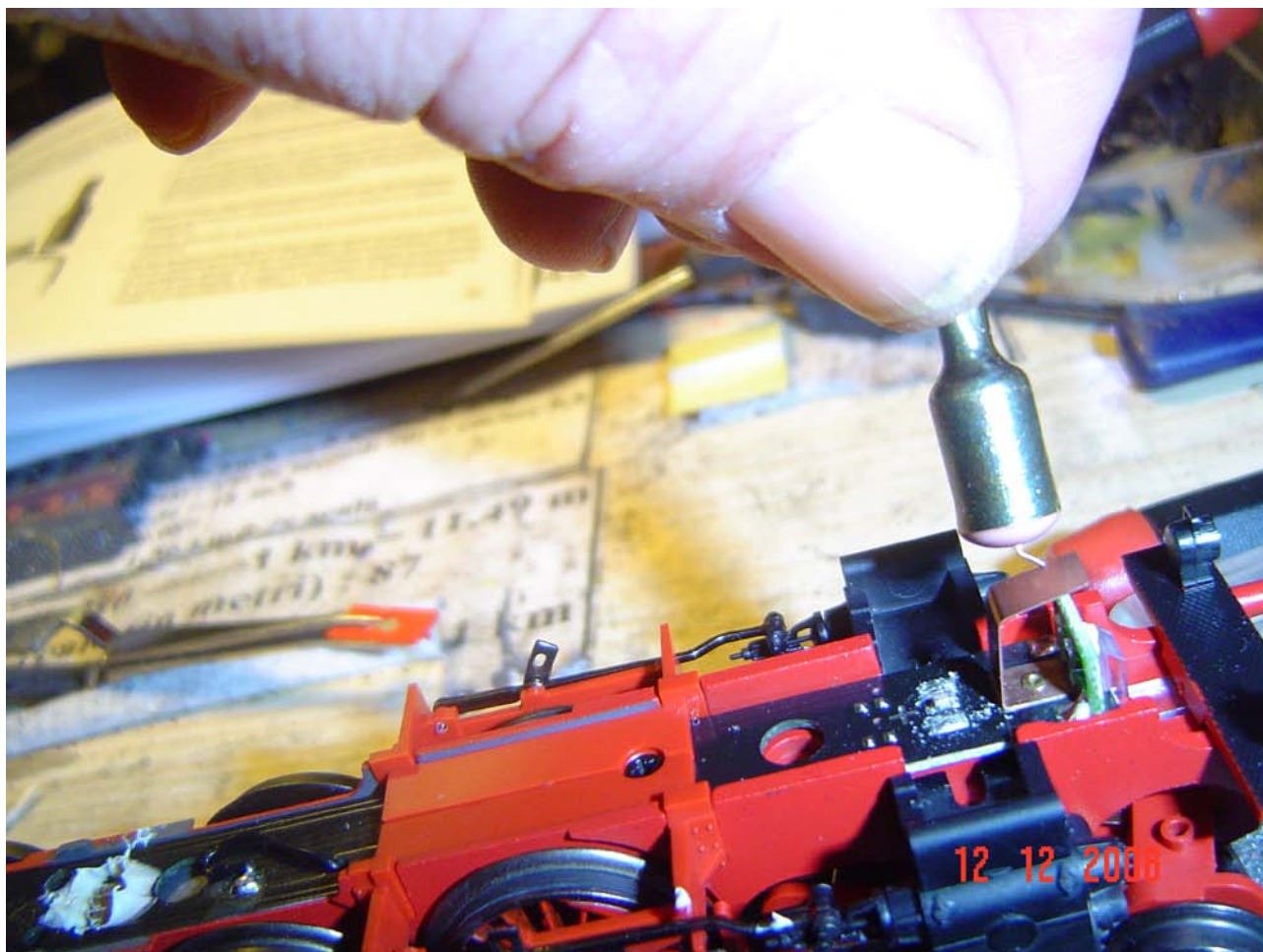
Foto n. 33: la corretta posizione del contatto del 72270 con la lamella
