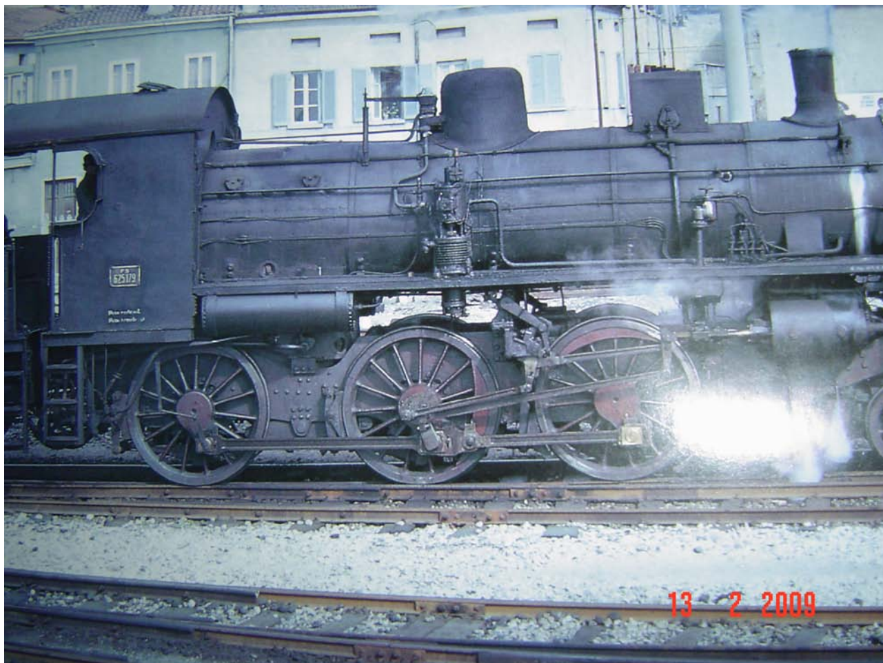
Foto n. 59: la 675 179 FS a Mantova in epoca recente (notare la sabbiera anteriore al duomo, notare che l’asta di comando non è più a destra, la pompa Westinghouse è rimasta nello stesso punto, ma valvole e tubazioni sono profondamente cambiate)
