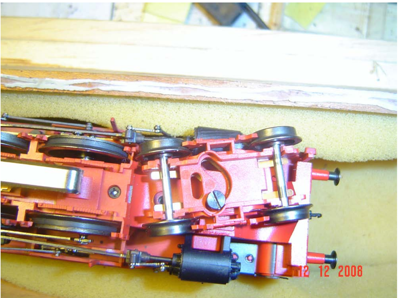
Foto n. 53: il carrello di una 38 sarebbe intralciato nel movimento dalle custodie
