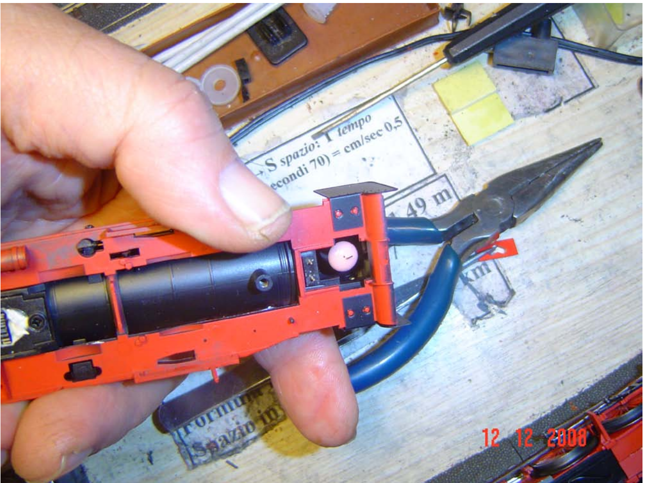
Foto n. 34: il 72270 inserito con lamella avanti e notare il supporto per la vite
