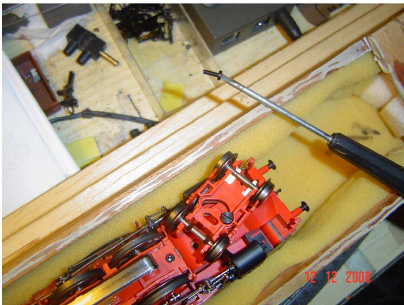
Foto n. 28: la vite anteriore corta, il foro è subito dietro il carrello anteriore
