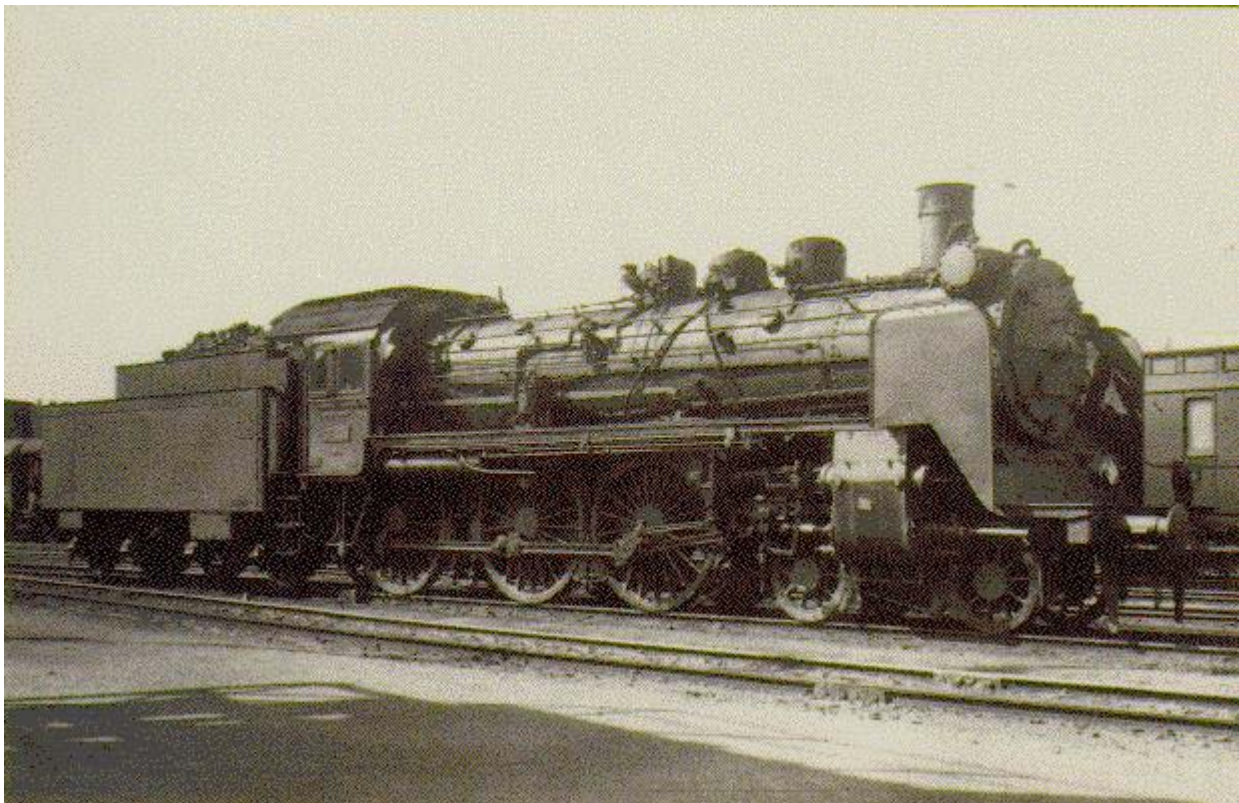
Foto n. 5: una 38 con deflettori Wagner, 2 duomi, 1 sabbiera centrale (riconoscibile dai tubi che vanno verso le ruote motrici) e preriscaldatore collocato anteriormente, cabina squadrata
