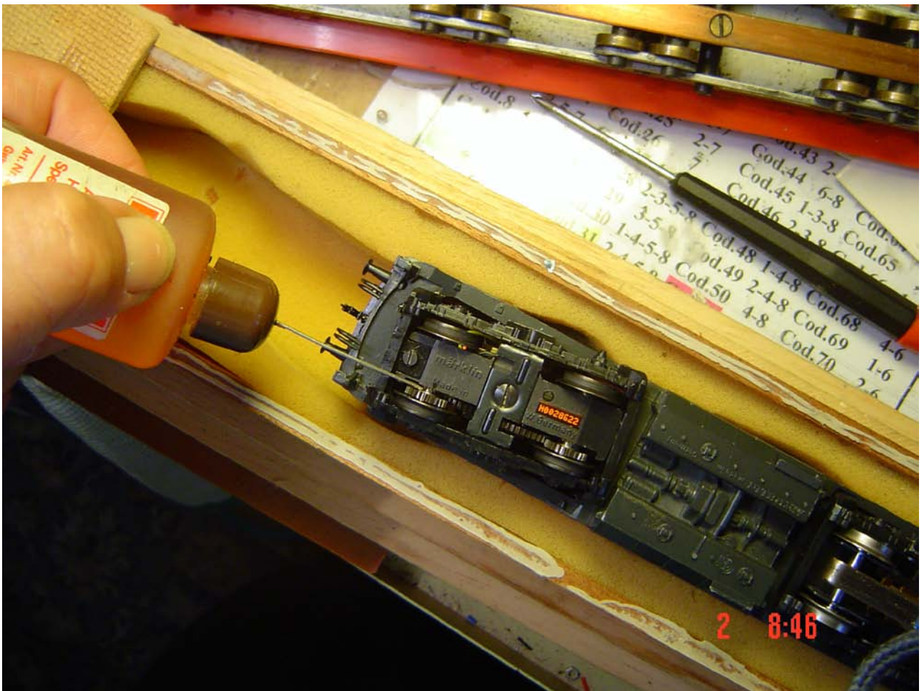
Foto n. 26: oliatura degli assi in una locomotiva capovolta nella “culla”
