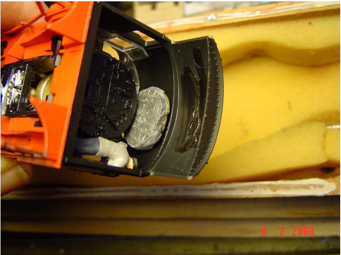
Foto n. 39: un ulteriore piombino si può “nascondere” sotto il cielo della cabina
