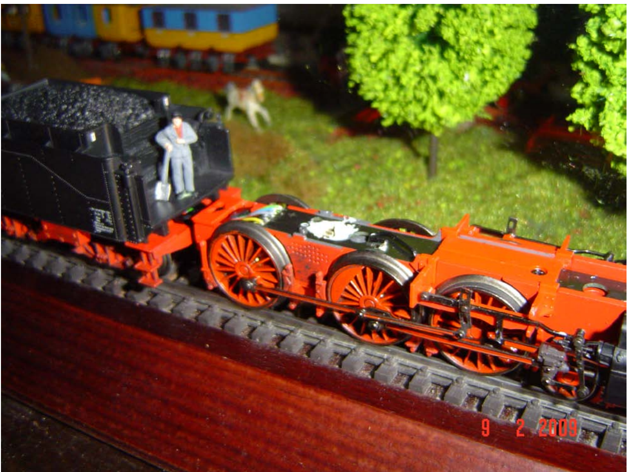
Foto n. 46: il Kulisse, subito avanti al fochista, deve essere ben aderente al telaio
