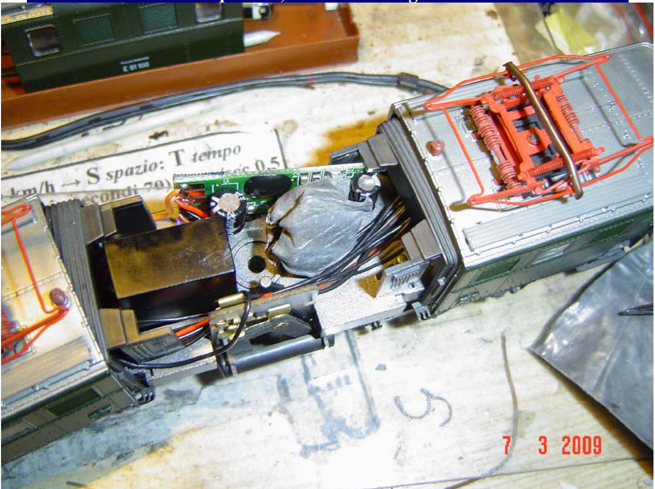
Foto n. 19: il peso di circa 15 grammi nella parte centrale della E 91
