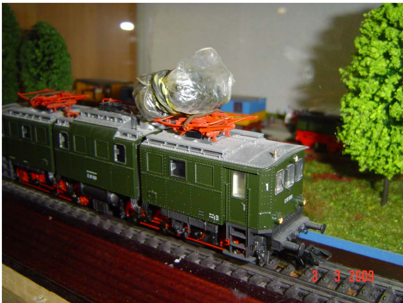
Foto n. 15: la E 91 appesantita con circa 47 gr. di piombo nella zona del motore.
