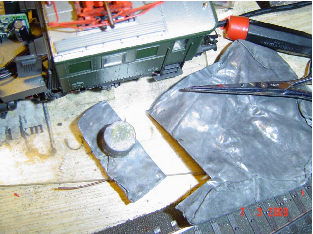
Foto n. 18: la lamina di piombo, facilmente ritagliabile con normali forbici
