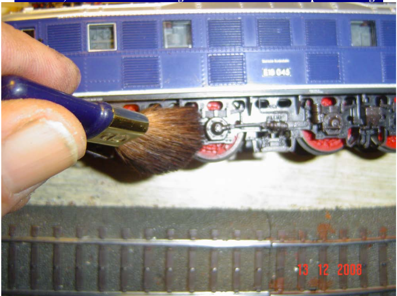
Foto n. 31, si sfuma dopo qualche minuto con un pennello da trucco.
