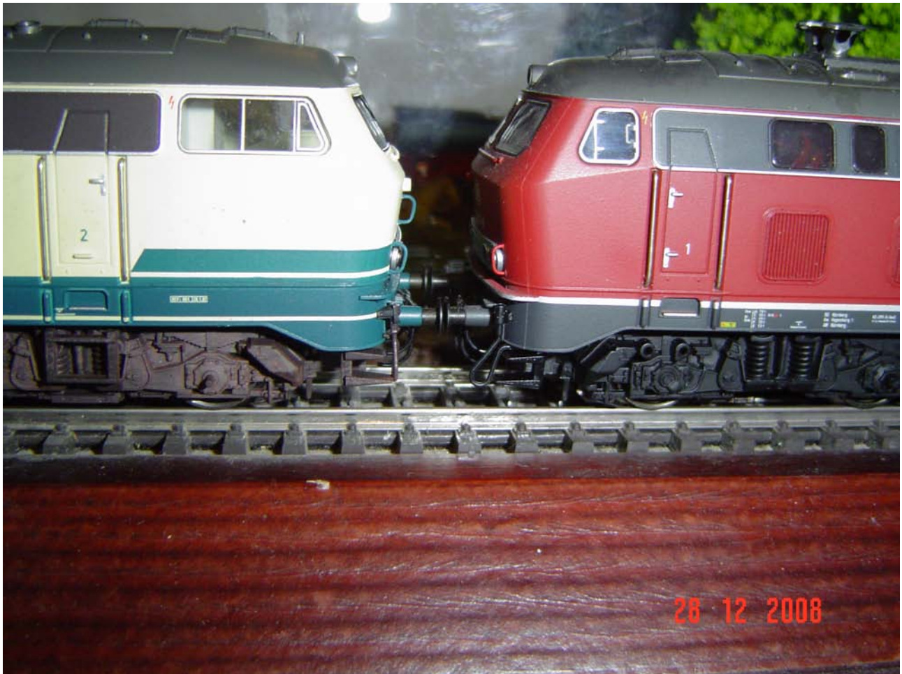
Foto n. 33, la netta differenza di colore tra carrelli di due 218.
