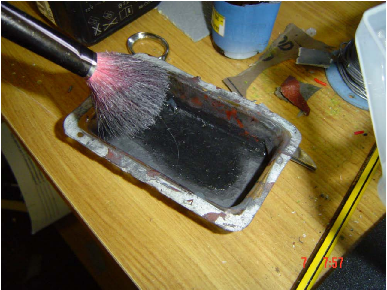
Foto n. 13, il pennello da trucco per la grafite, già trattata con il “fumo”.
