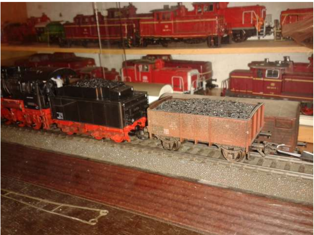
foto n. 43: causa il gancio telex, per le prove aggiunto un carro che ha al gancio un peso di 5/6 grammi circa.
