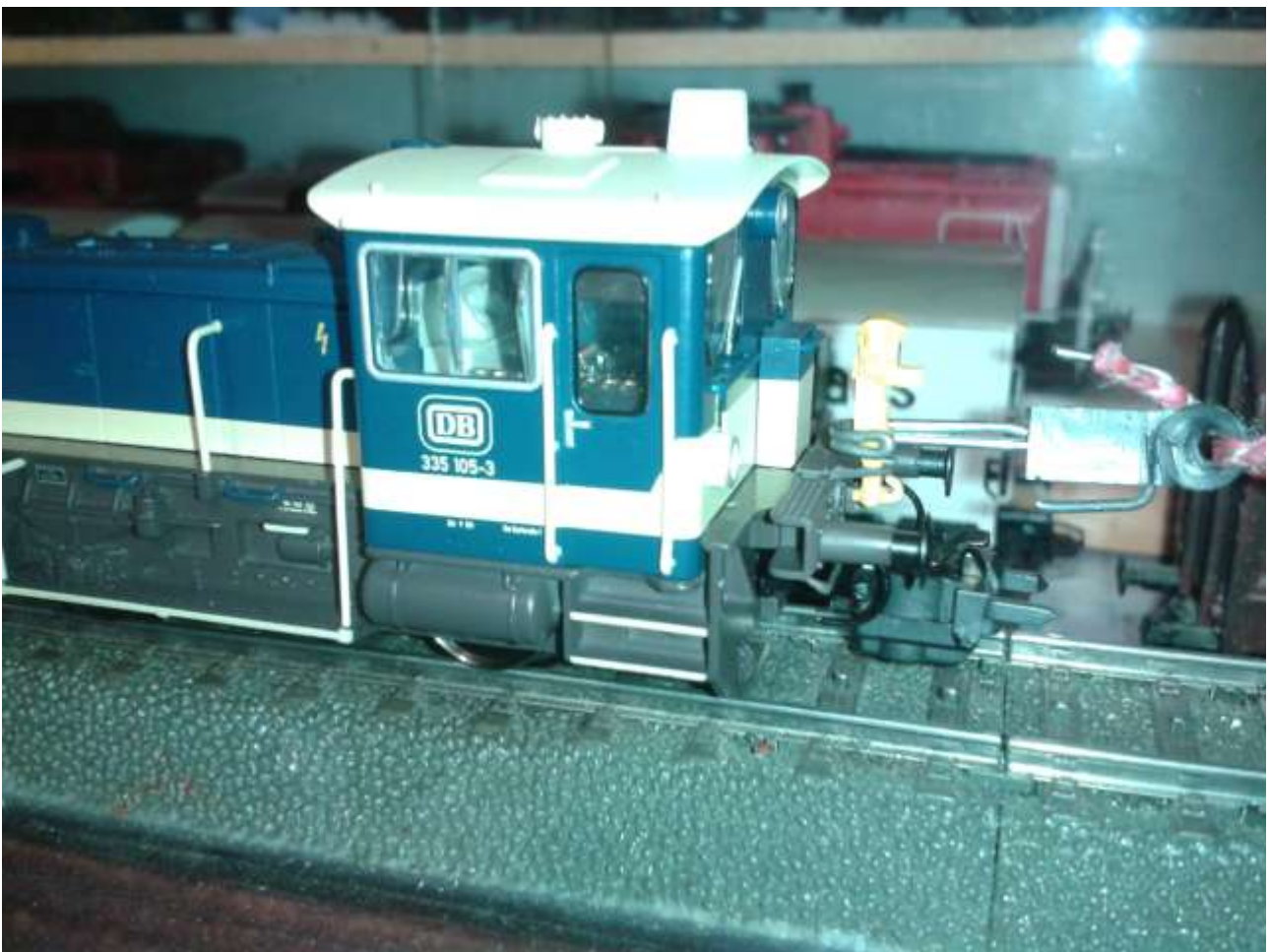
foto n. 44: il gancio del banco dinamometrico si può collegare al gancio giallo (solo con funzioni estetiche) di una 335, qui la 335 105-3 del 2013.
