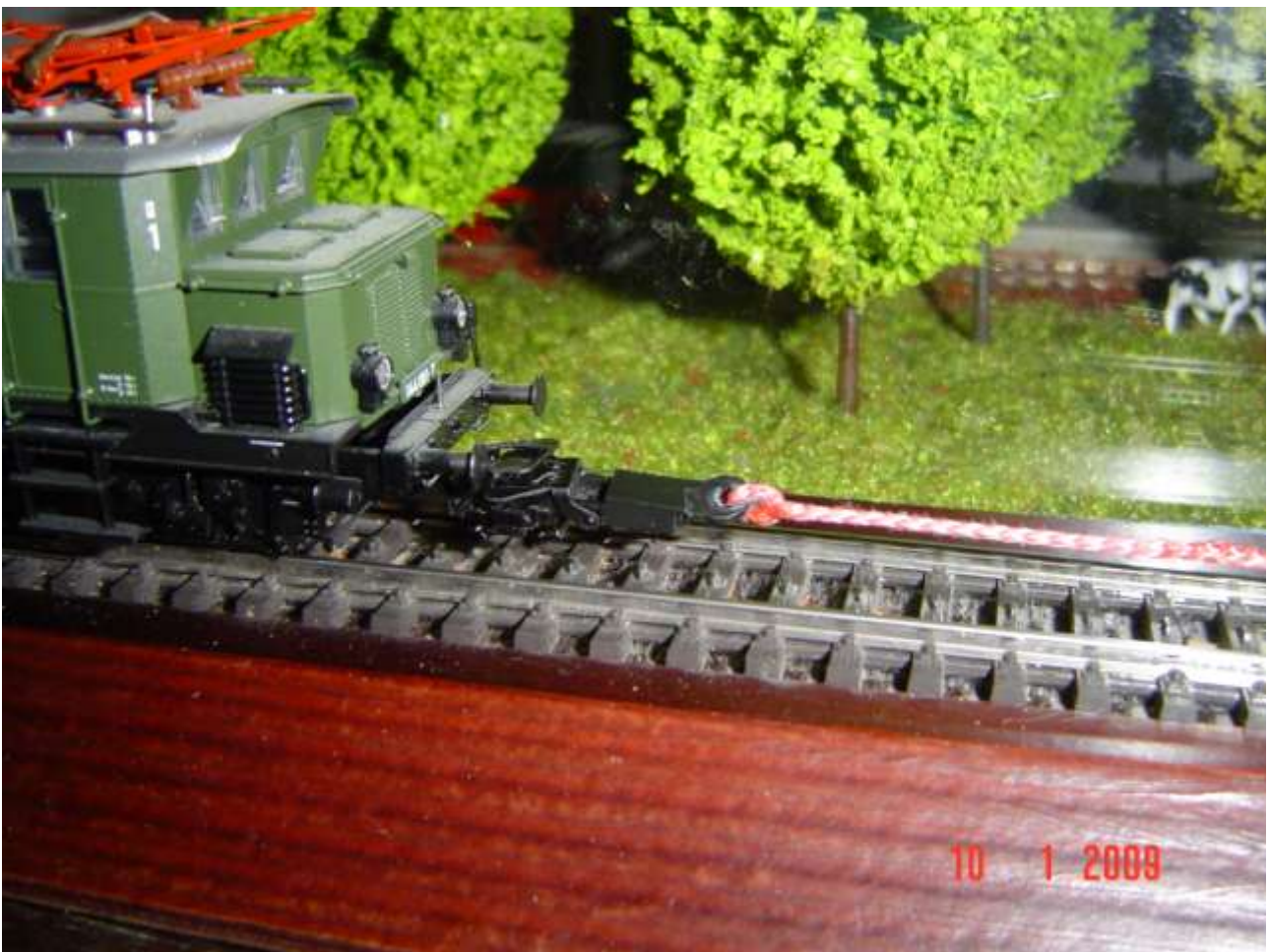
foto n. 8: il vecchio gancio corto era pericoloso
