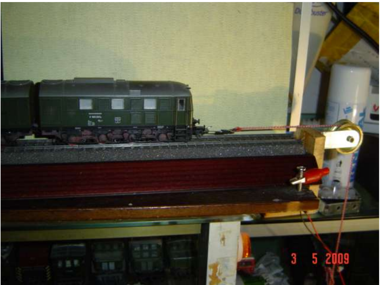
foto n. 12: l'ultima versione del banco Dinamometrico con binario "C"
