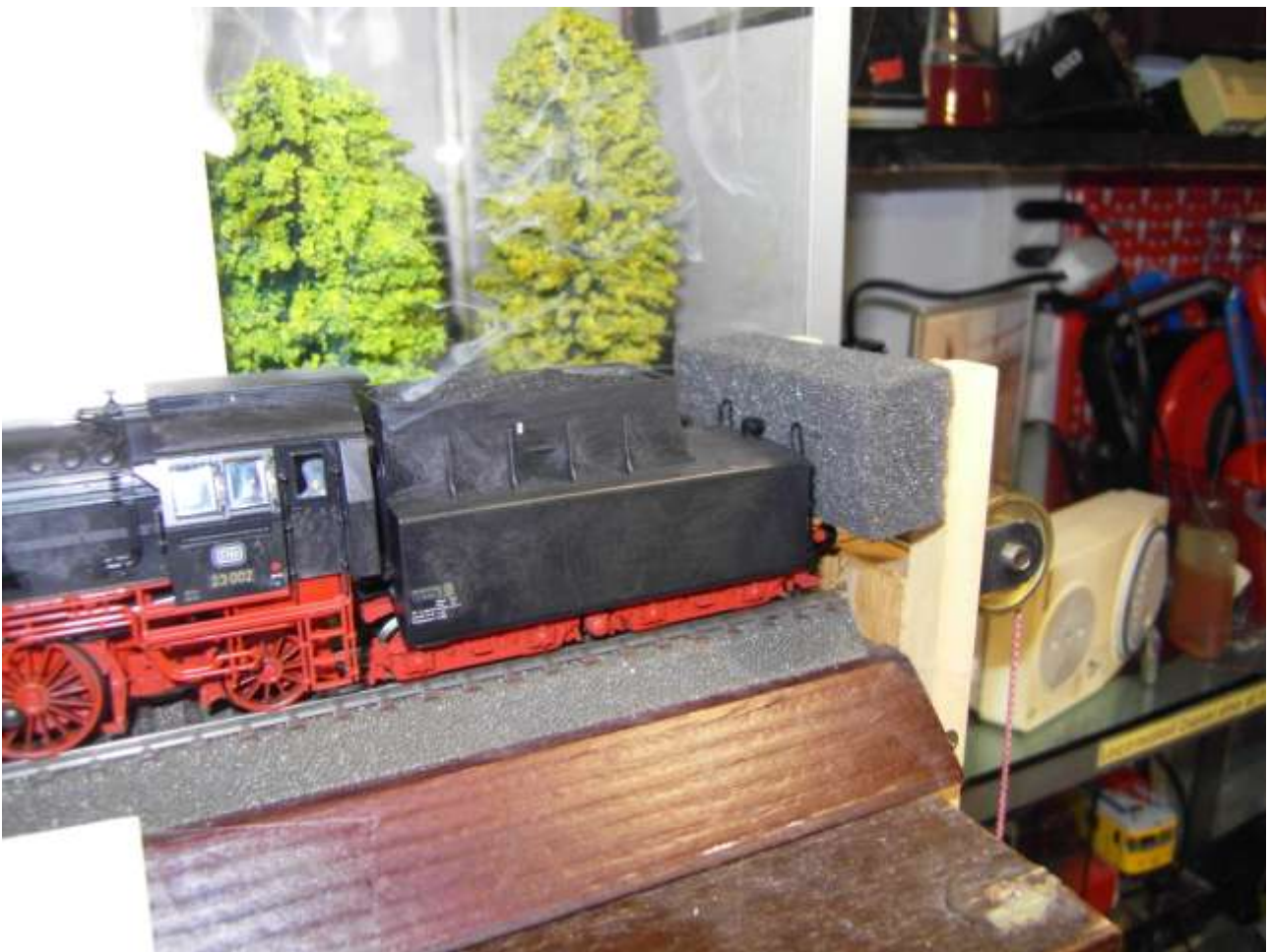
foto n. 15: paraurti in gommapiuma nell'ultimo banco Dinamometrico -
