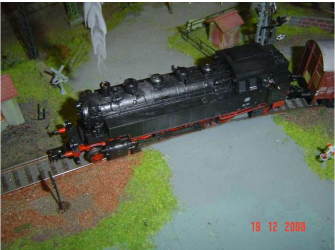
Foto n. 17: la Br 86 132 dopo la verniciatura del sottocassa ed il trattamento con la grafite
