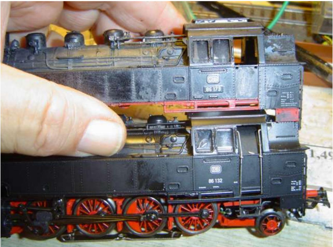
Foto n. 2: targhe in rilievo nella 86 173 del 1971, solo stampigliate nella 86 132 serie Hobby del 2006, le scalette sono state già da me trasferite da una loco all'altra (leggi il testo)
