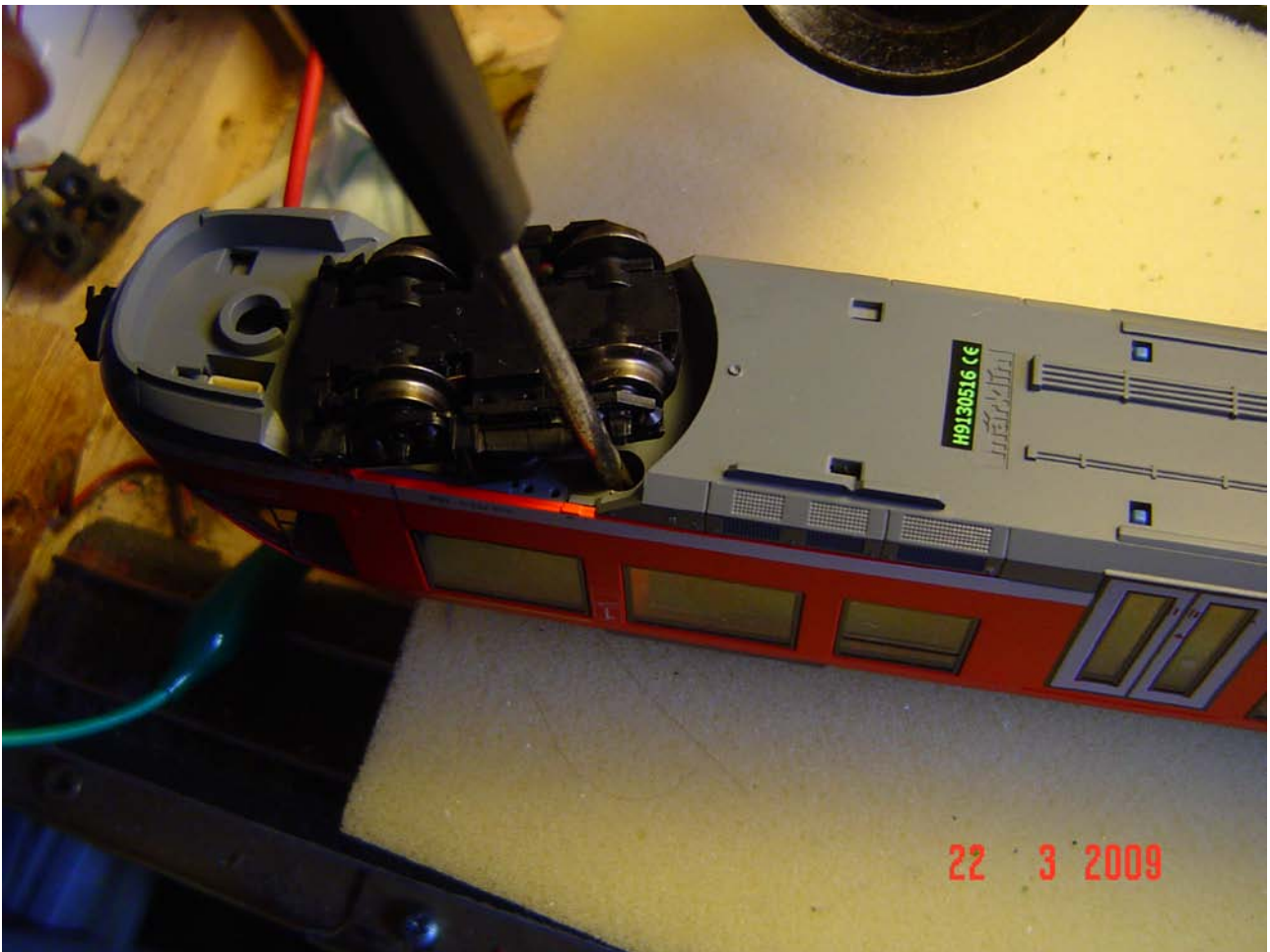
Foto n. 29: posizione del foro vicino al carrello anteriore di una semicassa
