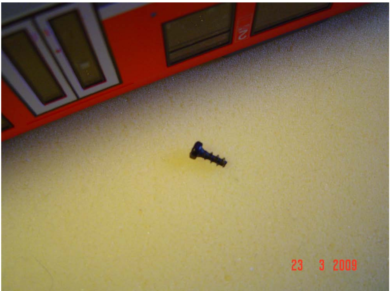
Foto n. 32: la vite a croce Märklin di tipo speciale
