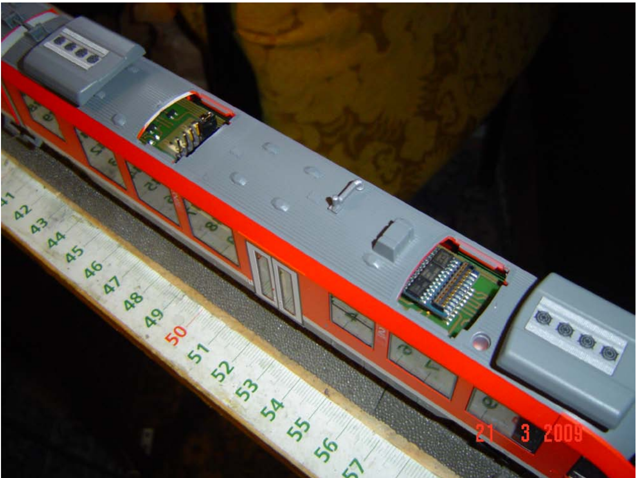
Foto n. 14 il decoder è posizionato sulla stessa semicassa dei ponticelli
