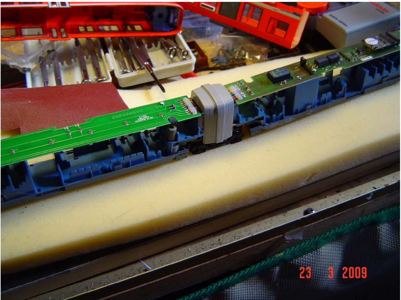
Foto n. 34: smontaggio completato delle semicasse
