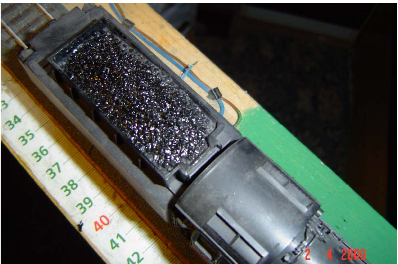
Foto n. 42: nella Br 044 534-6 il carbone nel tender va dipinto con nero lucido, che imita al meglio la lucentezza del materiale, tra l'altro spesso inumidito dalle intemperie, il carbone non va grafitato
