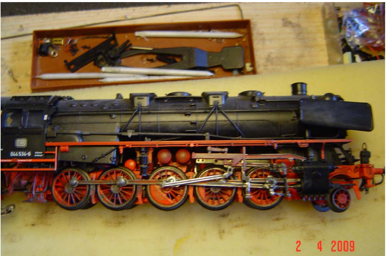
Foto n. 40: nella Br 044 primi interventi su mantello e biellismo
