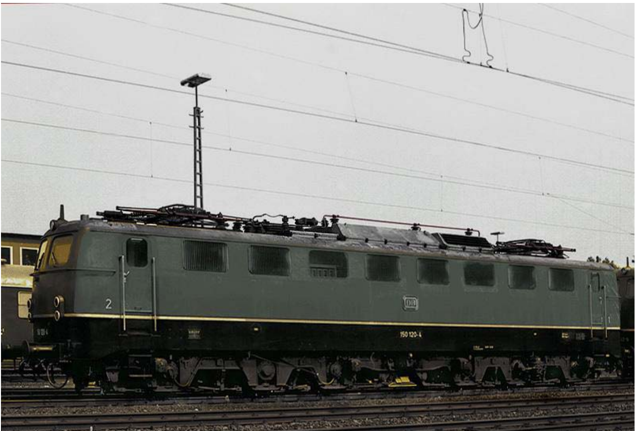
Foto n. 10: la 150 120-4 conserva ancora il corrimano anteriore e le gronde perimetrali del tetto
