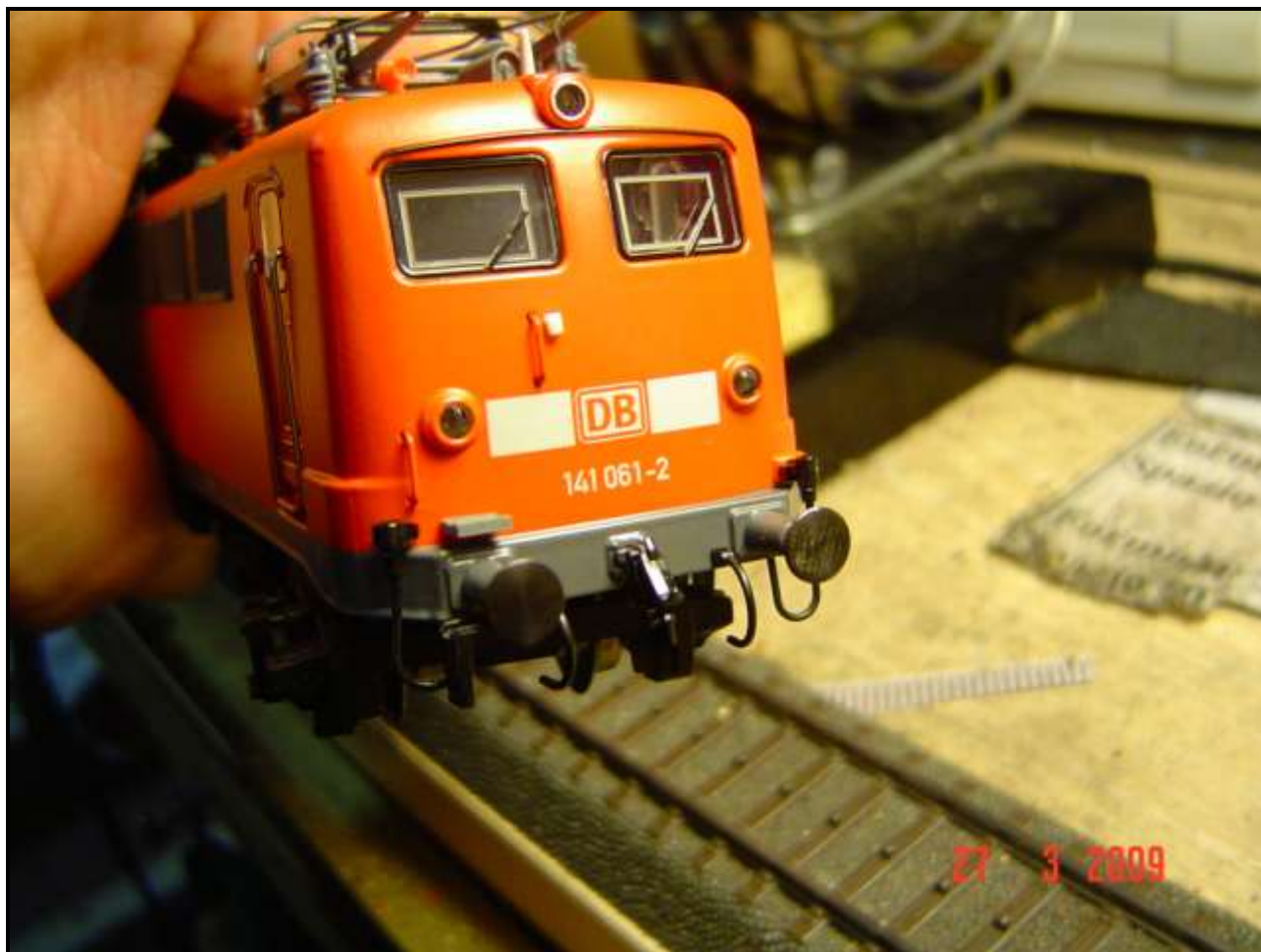
Foto n. 13: 141 con due Rec, gancio realistico e due soli tubi dei freni
