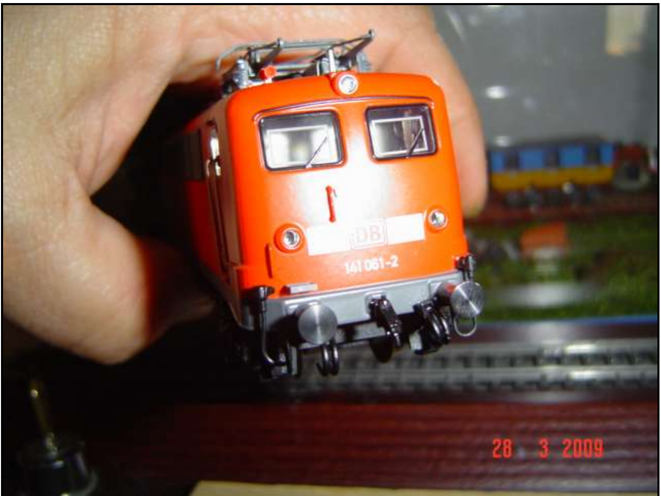
Foto n. 14: 141 061-2 con gancio realistico e tubi dei freni leggermente storti, da sistemare prima che il Bostik possa asciugarsi
