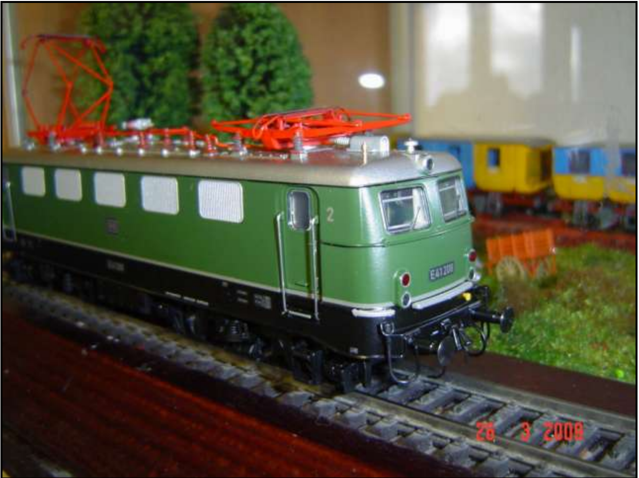
Foto n. 11: E 41 con isolatori verniciati, gancio, tubi dei freni e due Rec!
