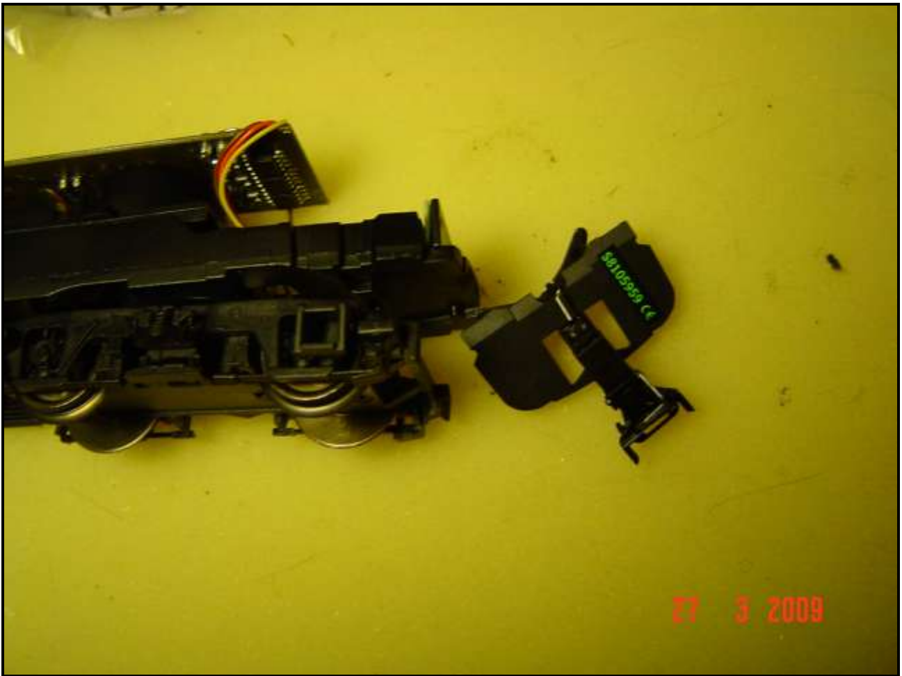
Foto n. 2: le parti che compongono il porta gancio nell'E 41 DB Märklin
