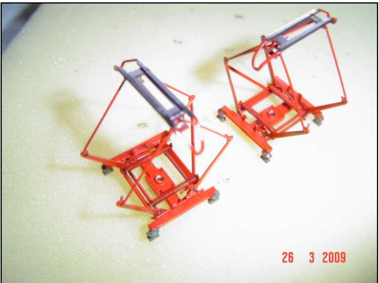
Foto n. 10: gli isolatori verniciati, attendere sino ad essiccazione completa!
