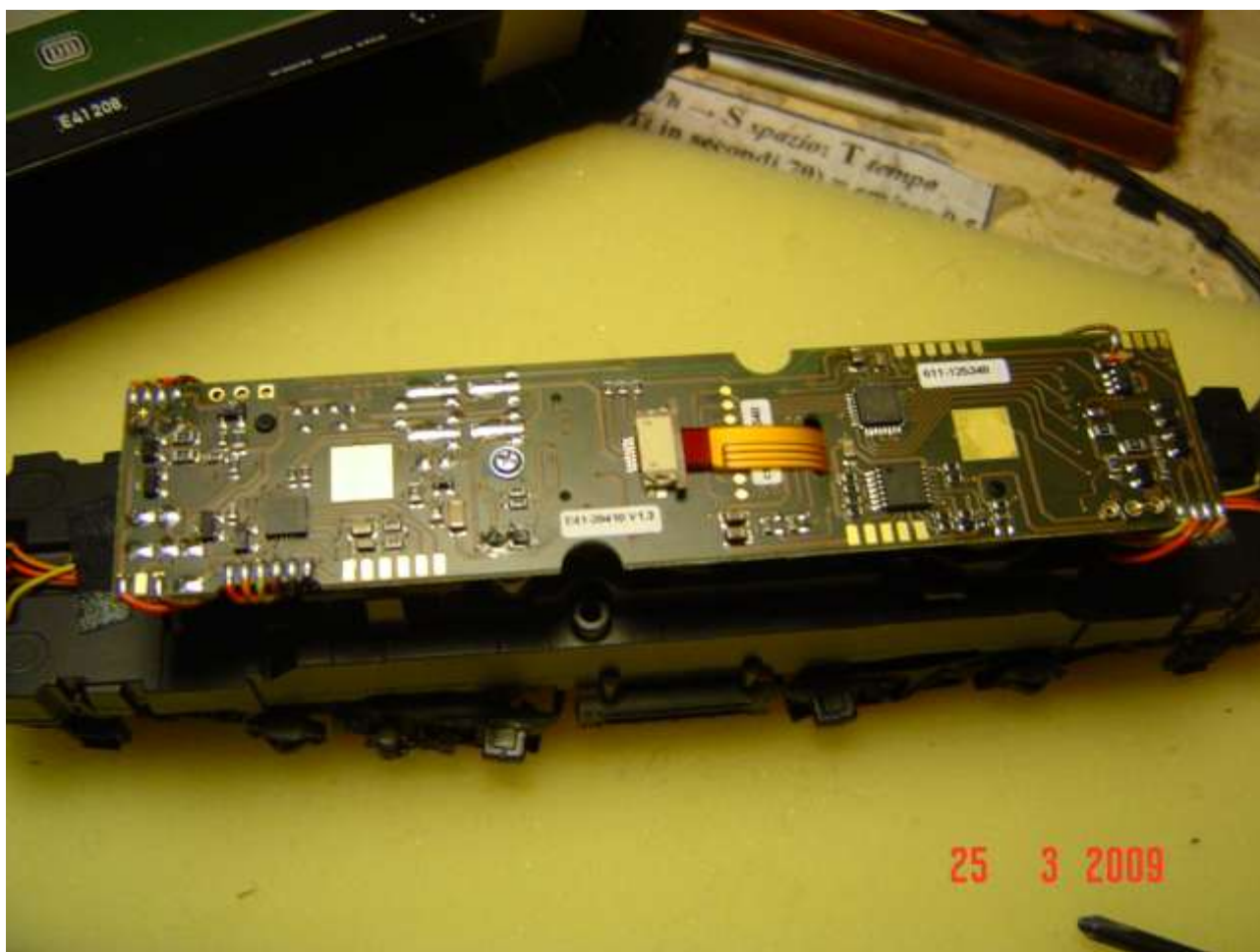
Foto n. 22: l'interno di una E 41 DB Märklin, osservate la piattina agganciata al connettore centrale
