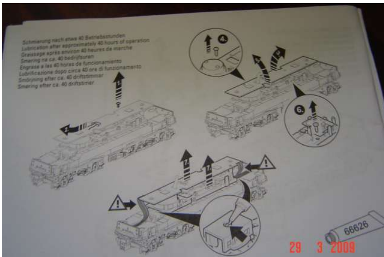
Foto n. 19: le istruzioni per ingrassare il motore nella E 41 DB
