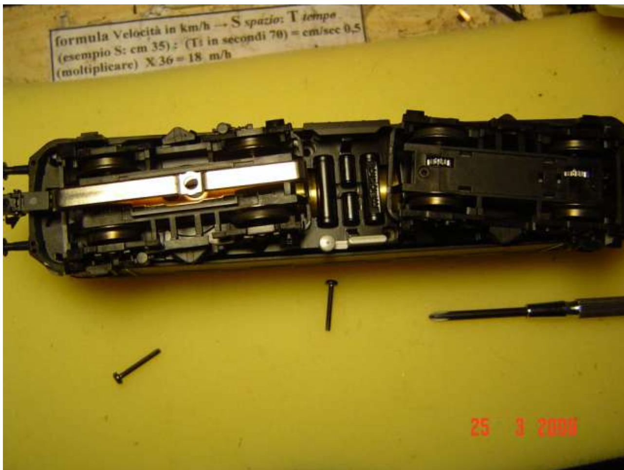
Foto n. 18: la serpentina e le lunghe viti che bloccano il mantello nella E 41 DB
