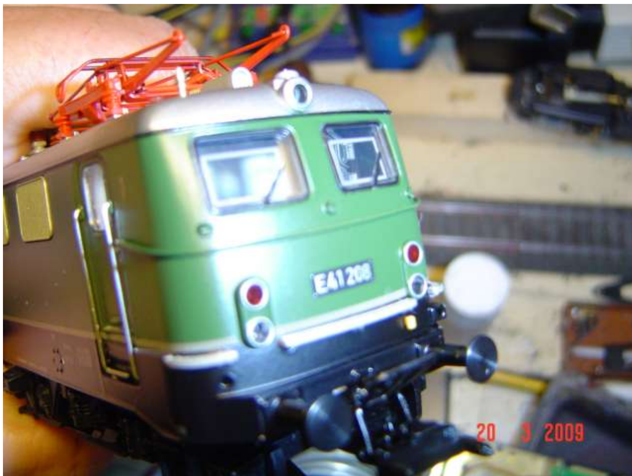
Foto n. 11: il corrimano uscito dalle guide nella E 41
