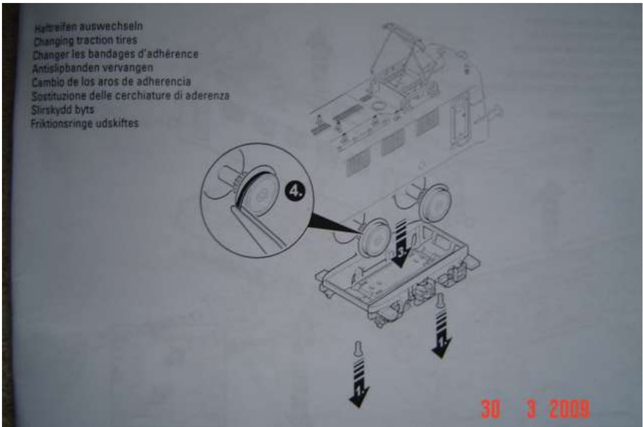
Foto n. 20: le istruzioni per sostituire una cerchiatura nella E 41 DB
