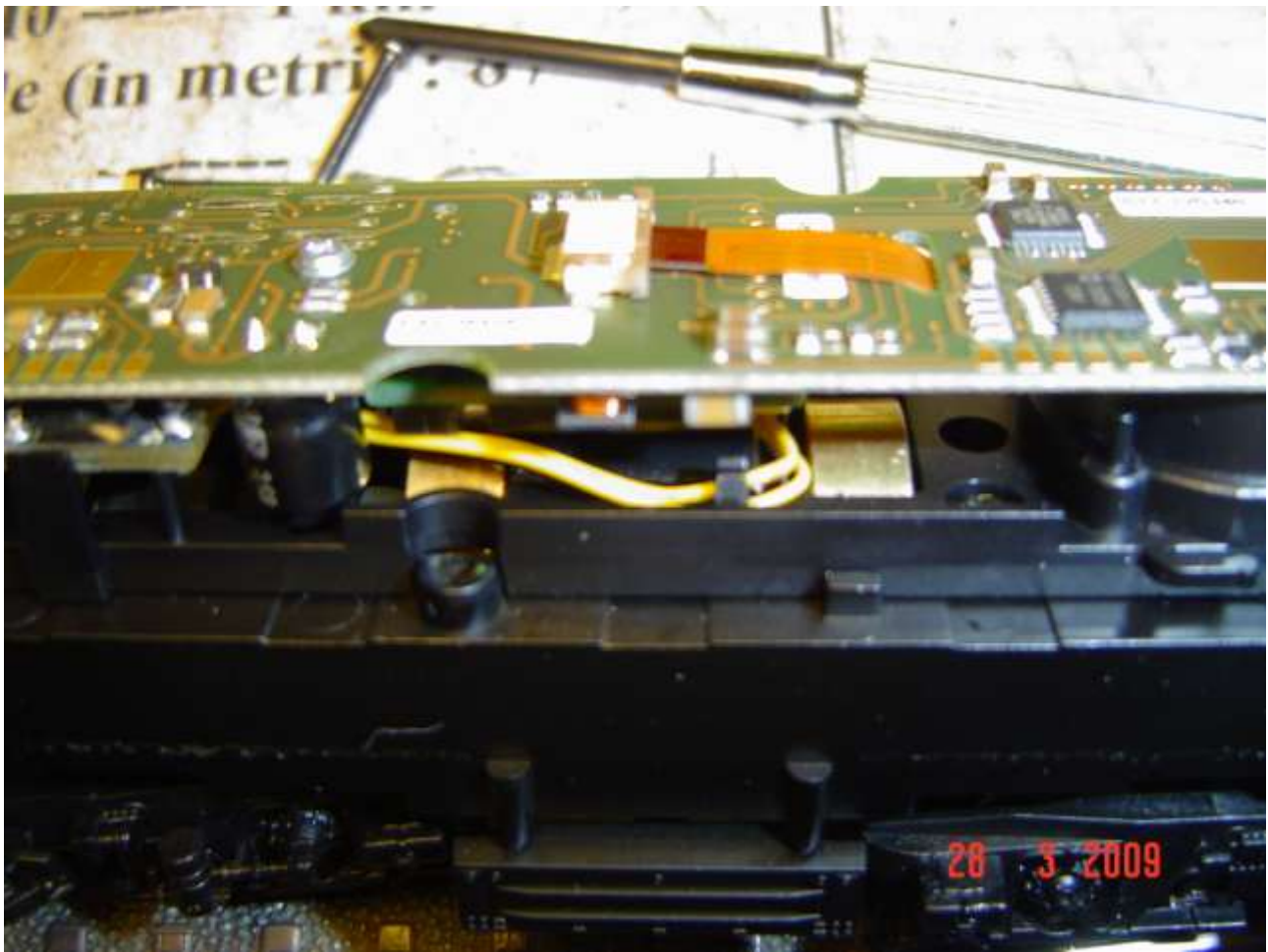
Foto n. 23: particolare della sede invito delle viti che fermano il pesante mantello nelle E 41/141 DB Märklin
