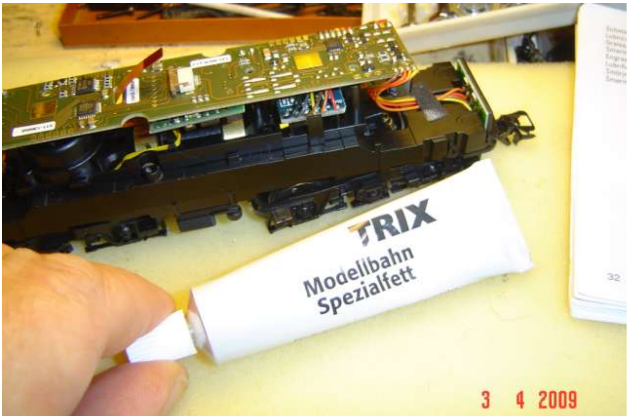
Foto D: il grasso da utilizzare per gli ingranaggi del motore degli E 414/141
