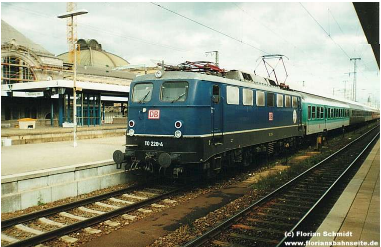
Foto n. 14: una 110 in epoca DB AG con 4 tubi dei freni e i rec tipo 103
