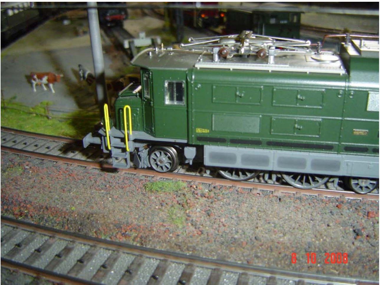
Foto n. 48: i mancorrenti della SBB CFF Ae 8/14 sono stati applicati dalla Fabbrica
