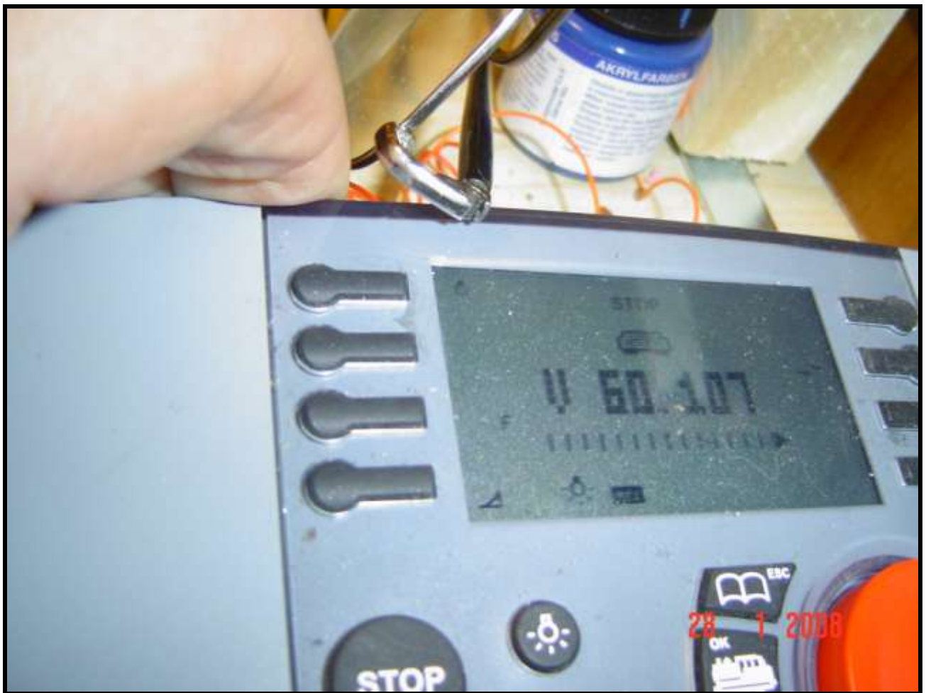
Foto n. 24: il corto avviene solo quando la carrozza ha un gancio conduttore e il pattino)
