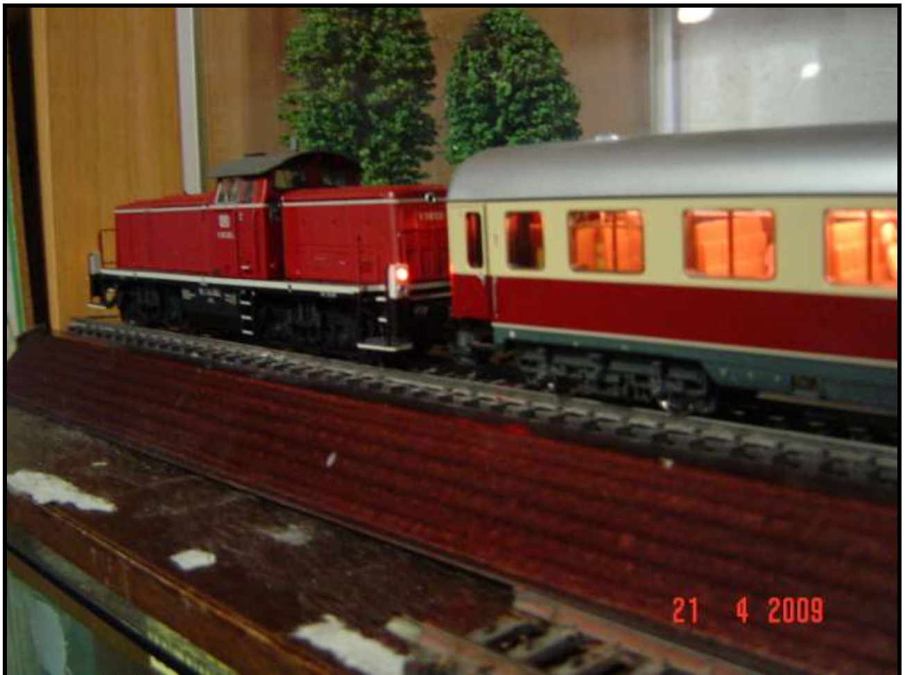
Foto n. 25: la V 90, con il telex NON provoca un corto circuito se aggancia una carrozza dotata di ganci conduttori
