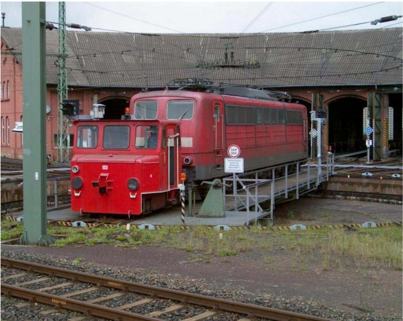
La 151 DB AG trainata da un trattore diesel su un ponte girevole pur dotato di linea elettrica. Foto n. 79
