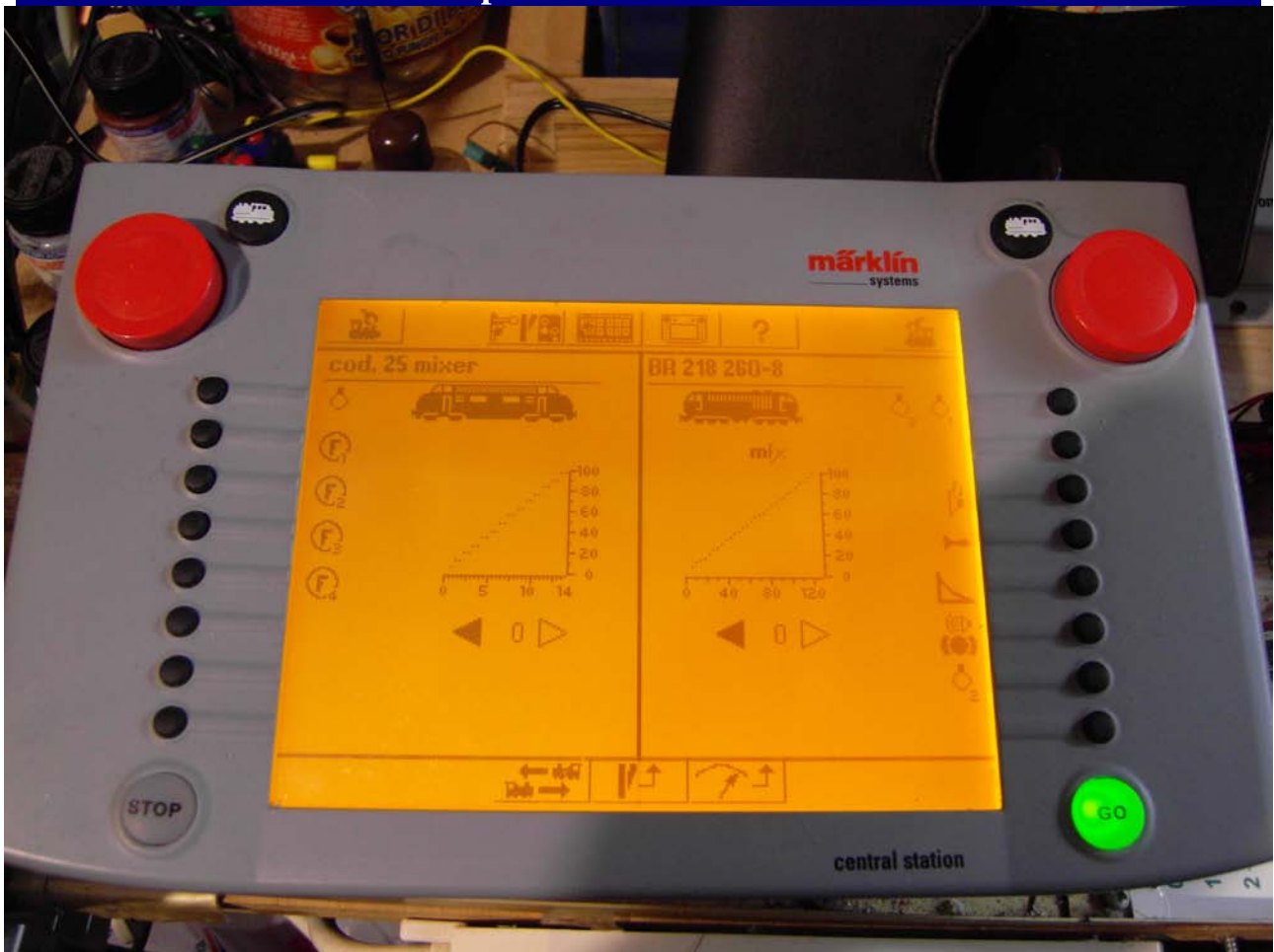
Foto n. 5 e n. 6: nessun problema se sono richiamate loco mfx o Motorola
