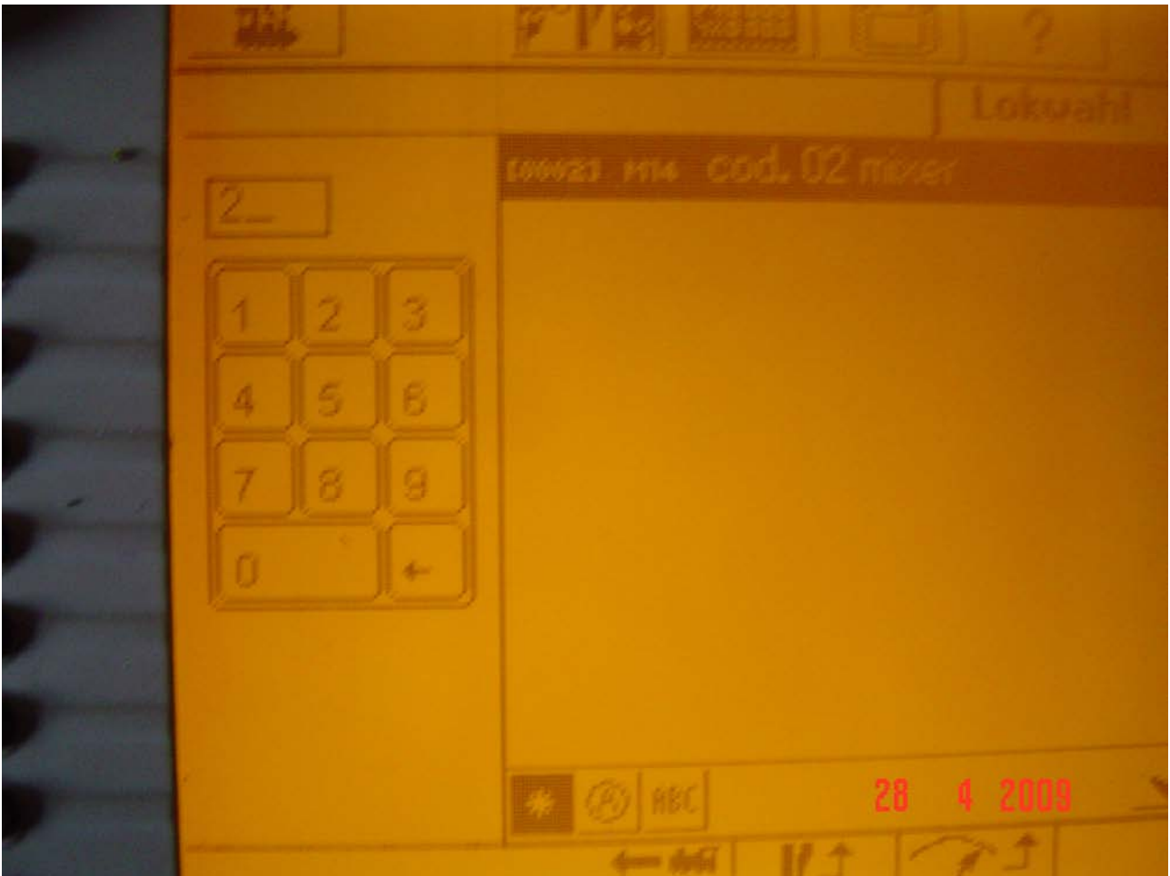
Foto n. 3: la tastiera virtuale consente un richiamo istantaneo dei decoder (Motorola o mfx) e non è più necessario anteporre lo 0 per i primi 9 codici
