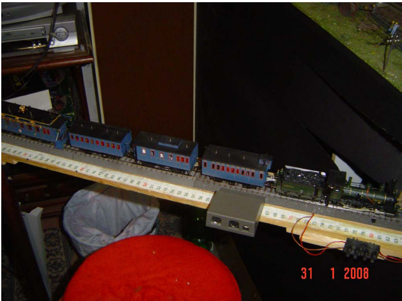
Foto n. 22: il binario di ingresso o programmazione
