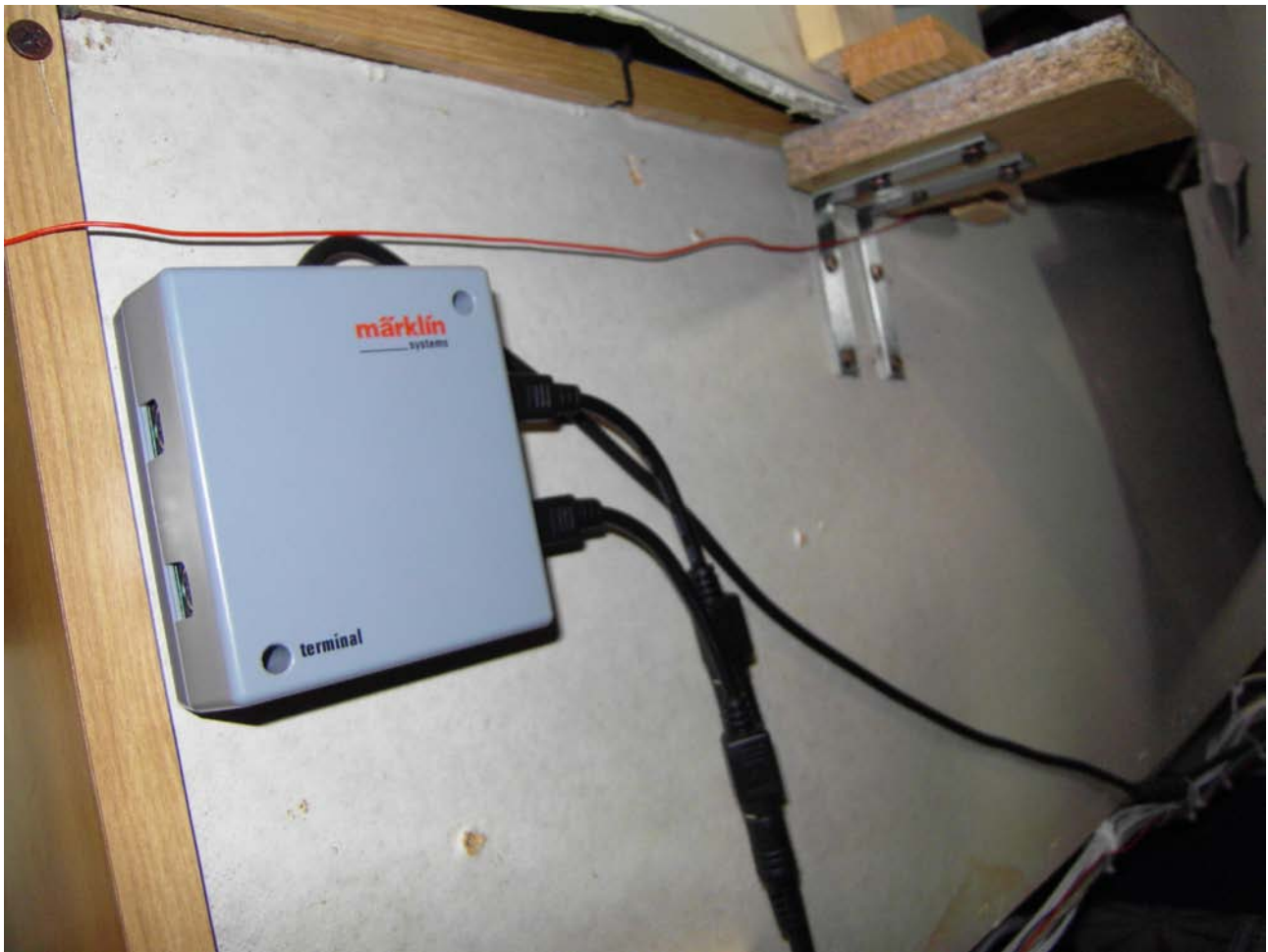
Foto n. 4: il Terminal che può essere collegato o alla Central Station o a un altro Terminal, o ad una prolunga; i suoi 4 attacchi per Mobile Station devono essere completati da cavetti adattatori (qui due, a destra nella foto).
