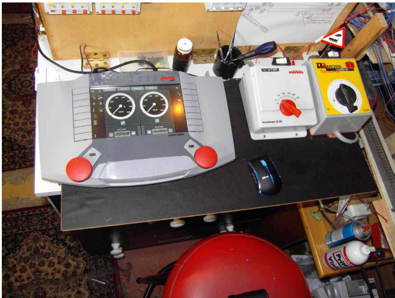
Foto n. 2: la Central Station 2 e il cavo di collegamento al 1° Terminal 60125
