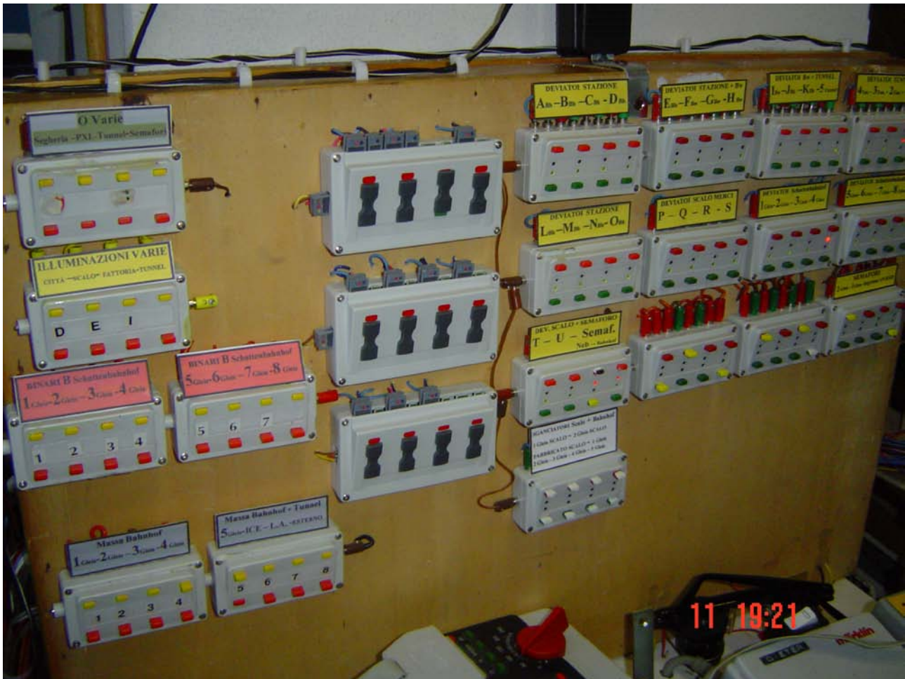
Foto n. 9: a sinistra, in basso, le 4 scatole (art. 72730) con i pulsanti che consentono l'esclusione della trazione (B)
