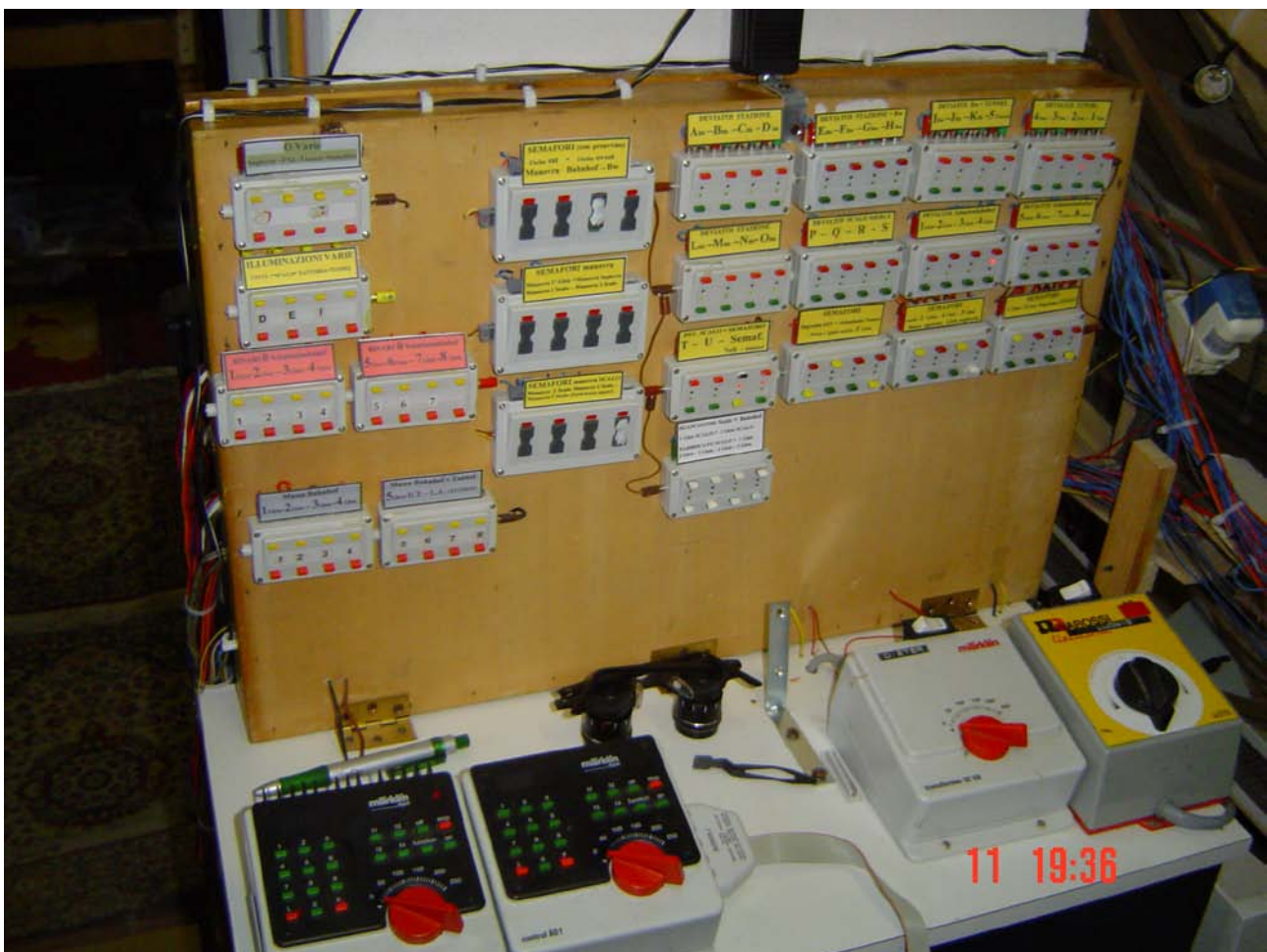
Foto n. 5: l'intero banco di comando, a destra della Control Unit due trasformatori analogici per alimentare la linea aerea.
