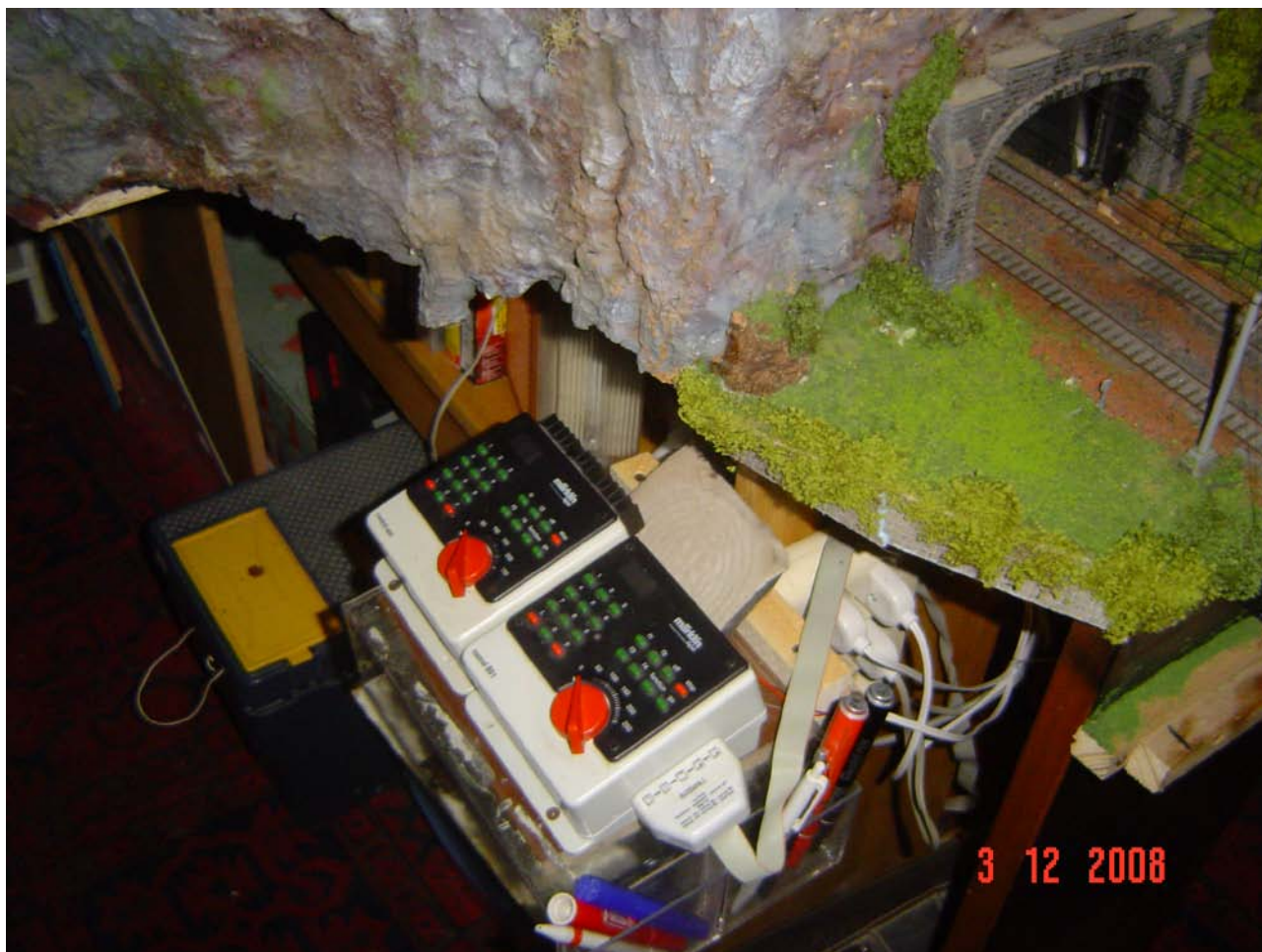
Foto n. 12: la 6021 abbinata ad una delle control 80 f ha lavorato, comandata dalla Central Station 1 per circa un anno a Vibaden 3 con risultati deludenti. Il trasformatore che alimenta la Control Unit è invisibile perché collocato nel riquadro del mobiletto.
