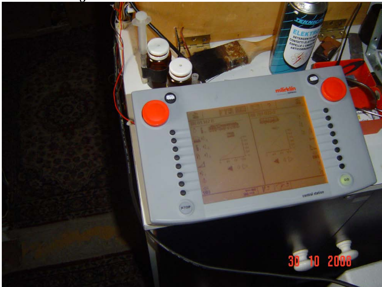
Foto n. 11: la Central Station 1 a Vibaden; notate, sulla sua sinistra, due cavi che si collegano alla Control Unit a circa 4 metri di distanza.
