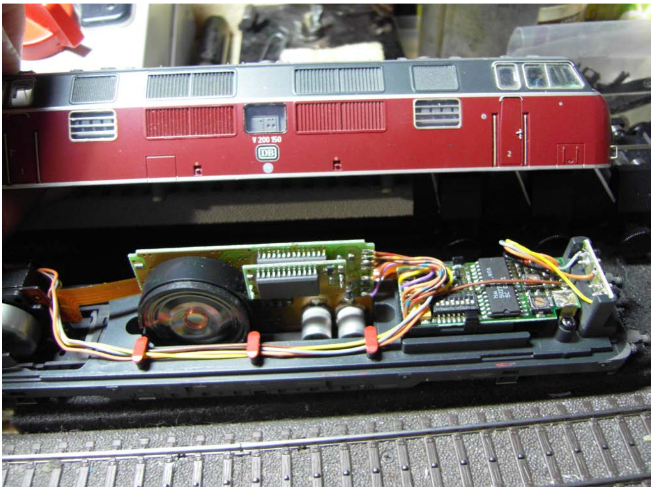
Foto n. 2: il complesso decoder Motorola di ultima generazione.
