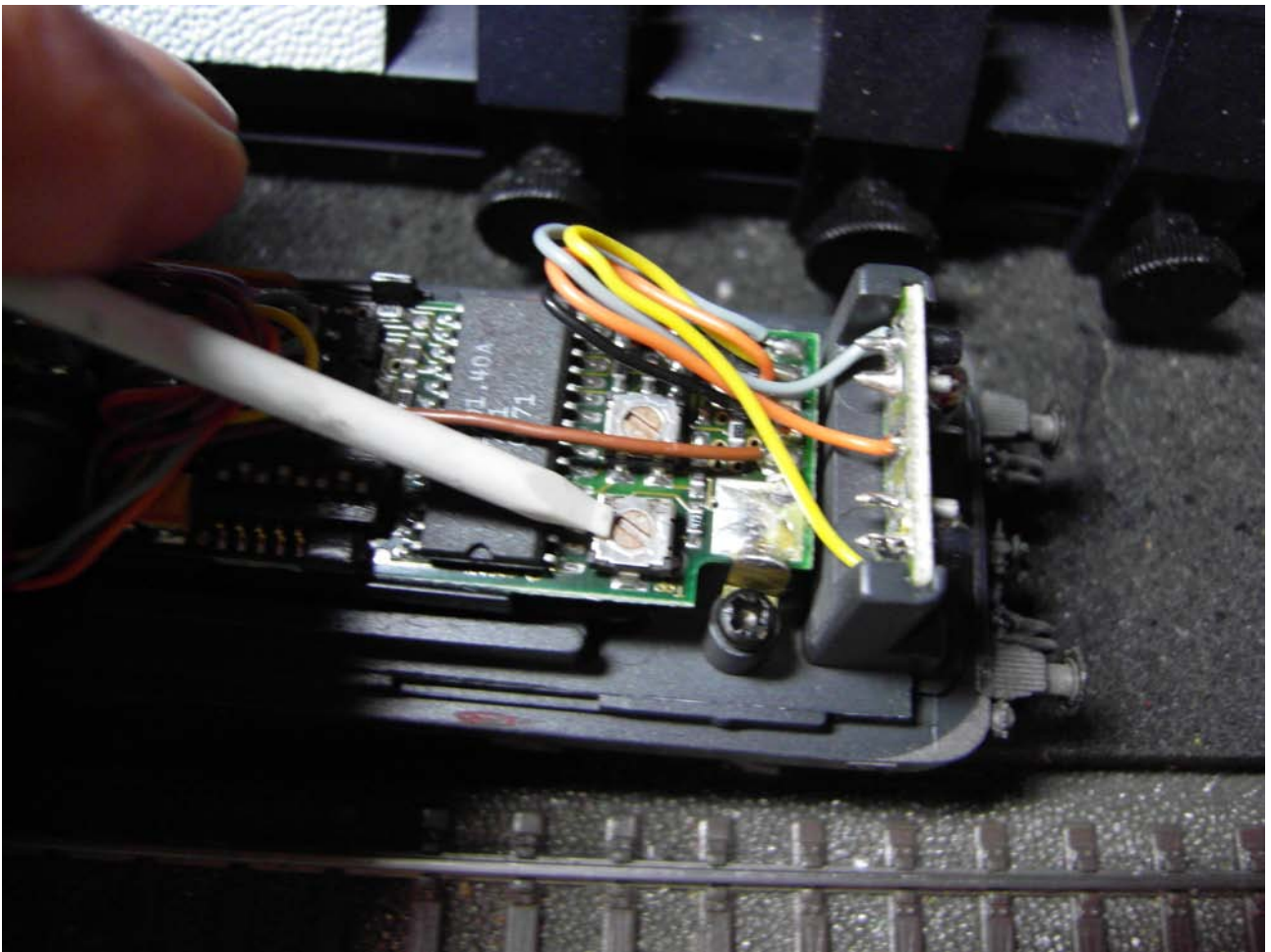
Foto n. 5: il cacciavite e i regolatori della velocità e accelerazione/rallentamento.
