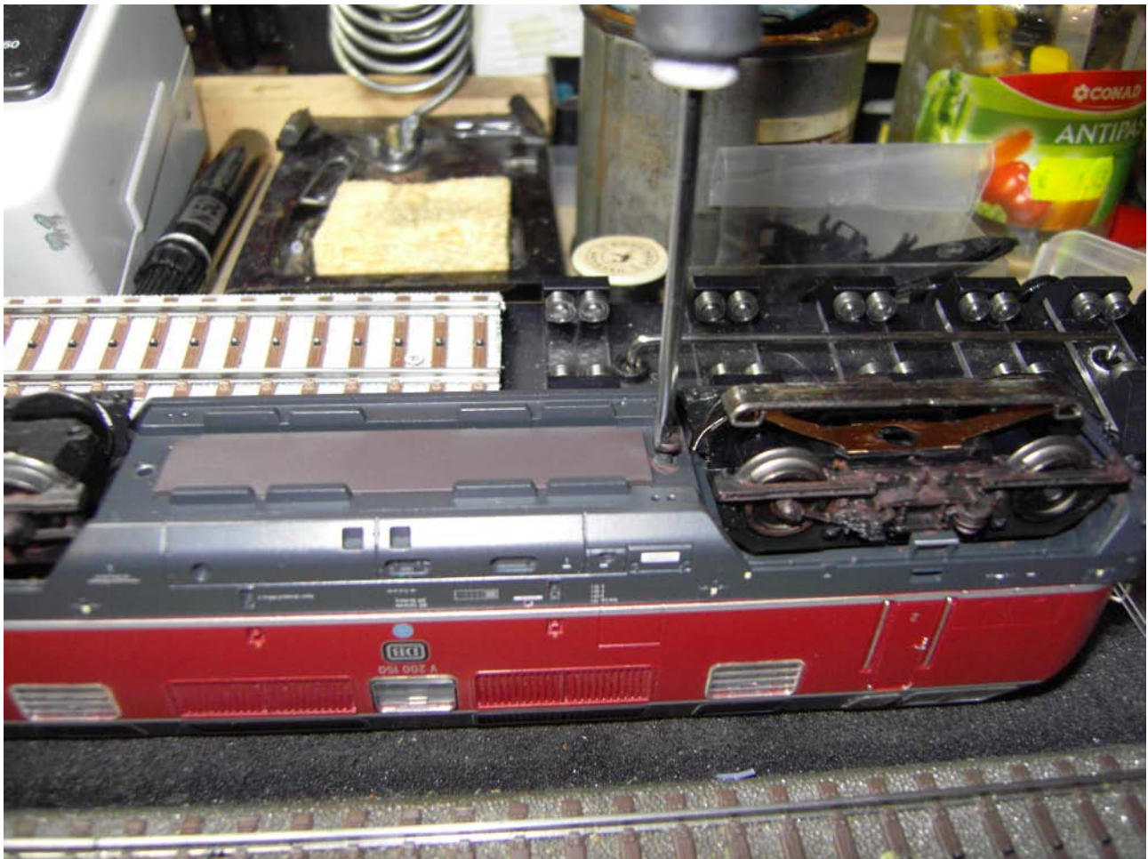
Foto n. 1: smontaggio del mantello di una V 200.1, con decoder Motorola.
