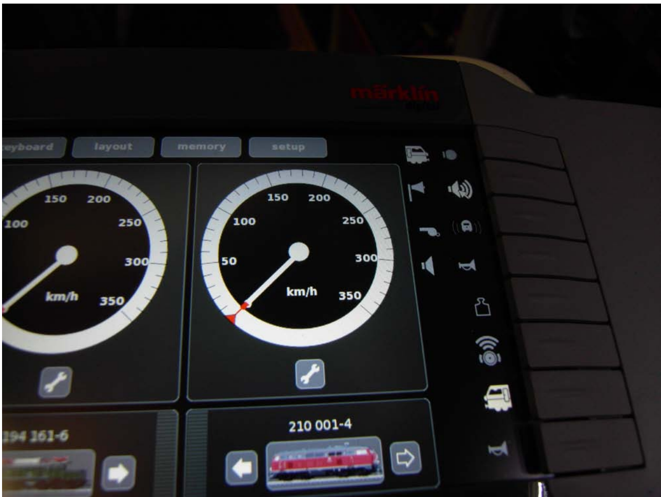
Foto n. 21: i simboli delle luci di coda (in alto a sinistra e in basso a destra sopra la tromba) nella 210 001-4 da poter gestire tramite la nuova CS 2
