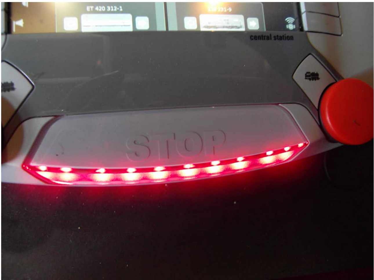
Foto n. 13 III fase: subito si accende la tastiera dello stop e viene interrotta l'alimentazione nei binari.
