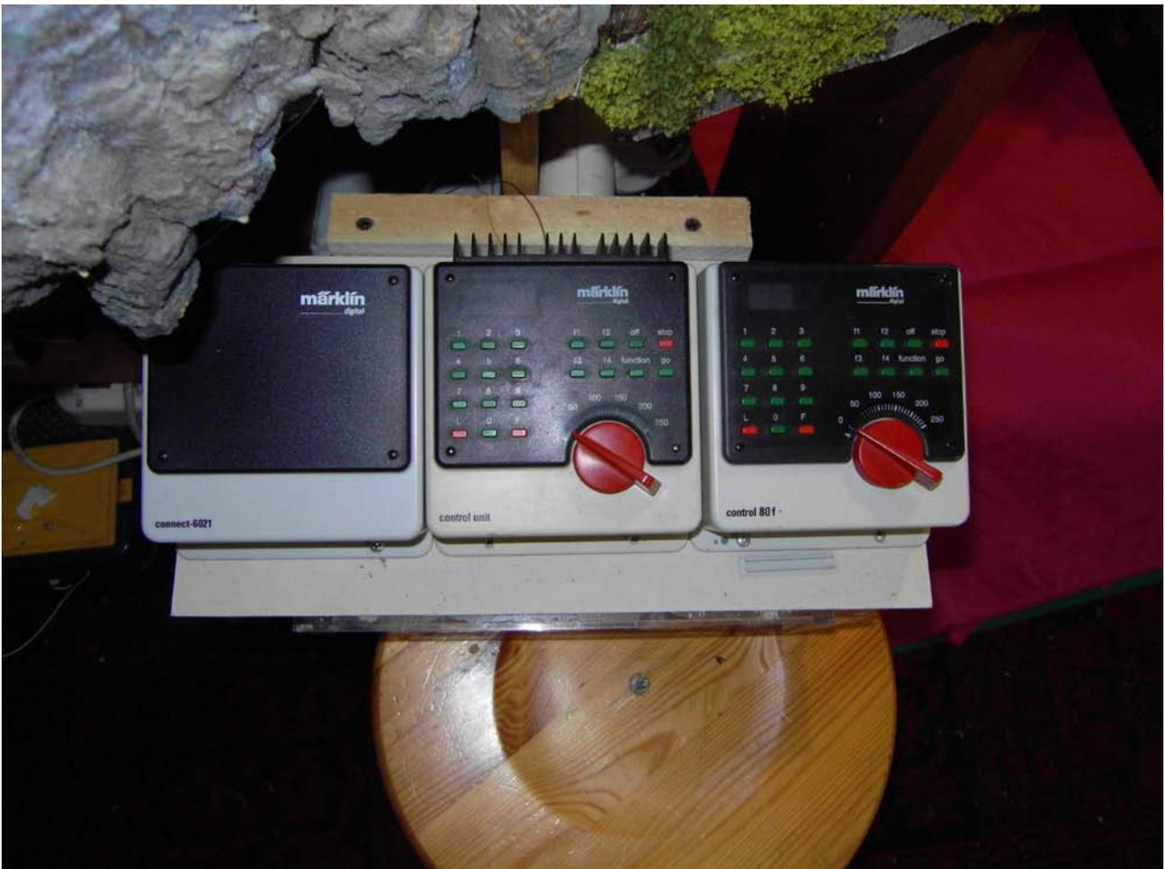
**Foto n. 19:** il Connect 6021 a sinistra della Control Unit e di una control 801 F a Vibaden; nella foto n. 20 il suo collegamento al Terminal 60125 più vicino
