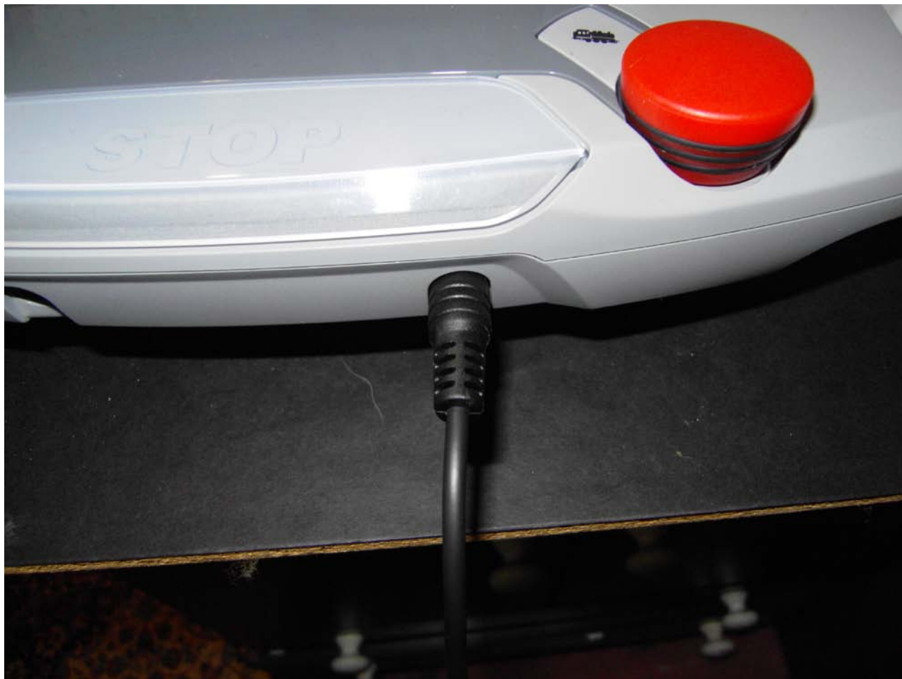
Foto n. 5: la CS 2 e il cavo di collegamento della MS 2 (la freccia NON si deve vedere!)
