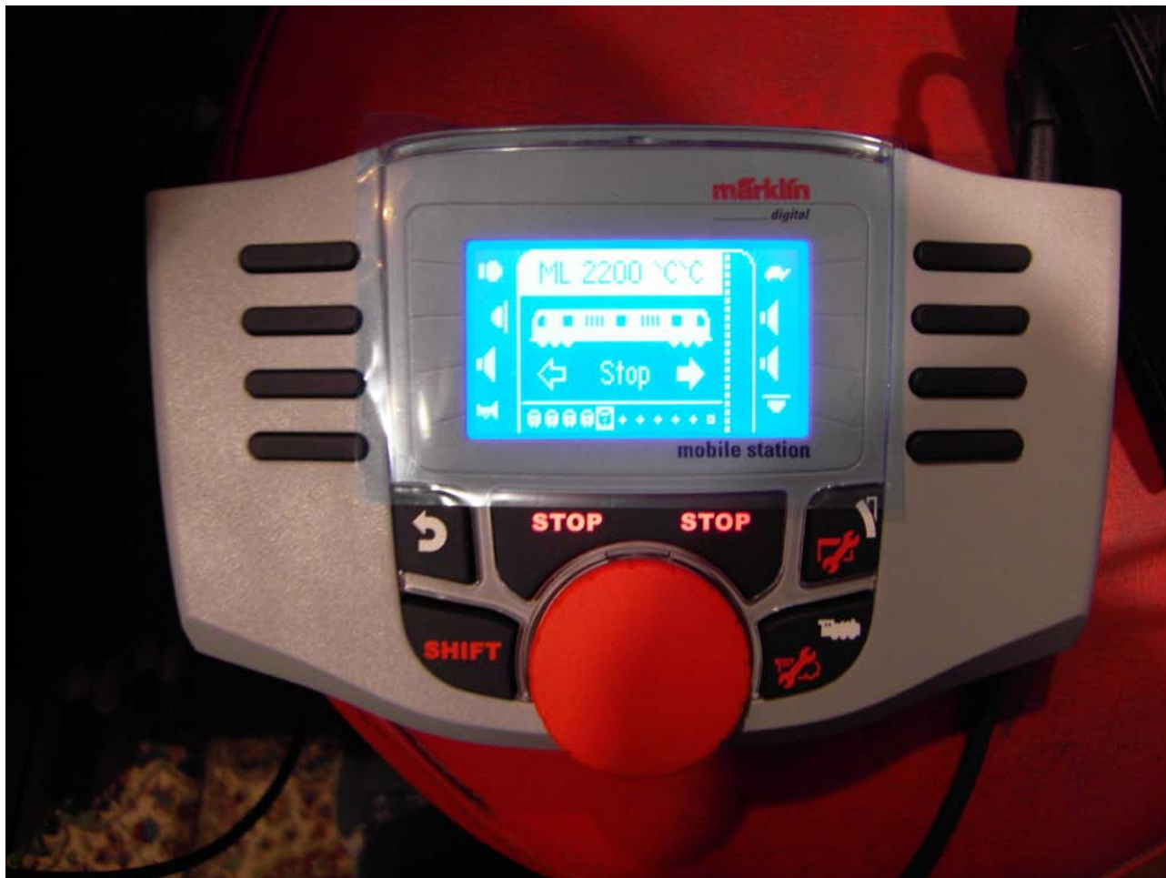
Foto n. 6: Mobile Station 2, nuova, con 5 loco (su 11 possibili) già programmate
