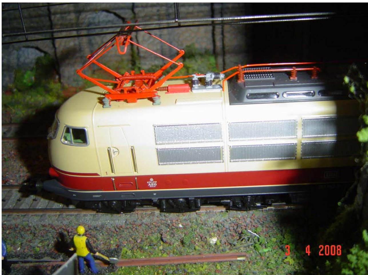
Foto n. 15: pantografi, con isolatori verniciati personalmente, nella 103 193 DB
