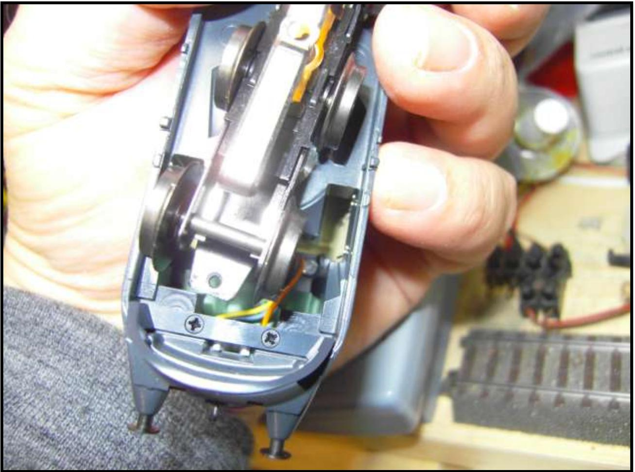
**Foto n. 30: gancio e copri carrelli allontanati, si devono togliere ora le viti per sostituire le carenature aperte operative in H0**
