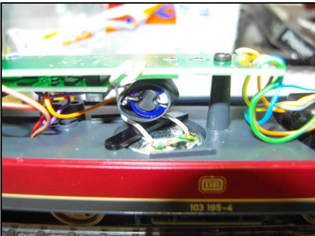
**Foto n. 34: posizione dell'altoparlante nel telaio della 103 195-4**
