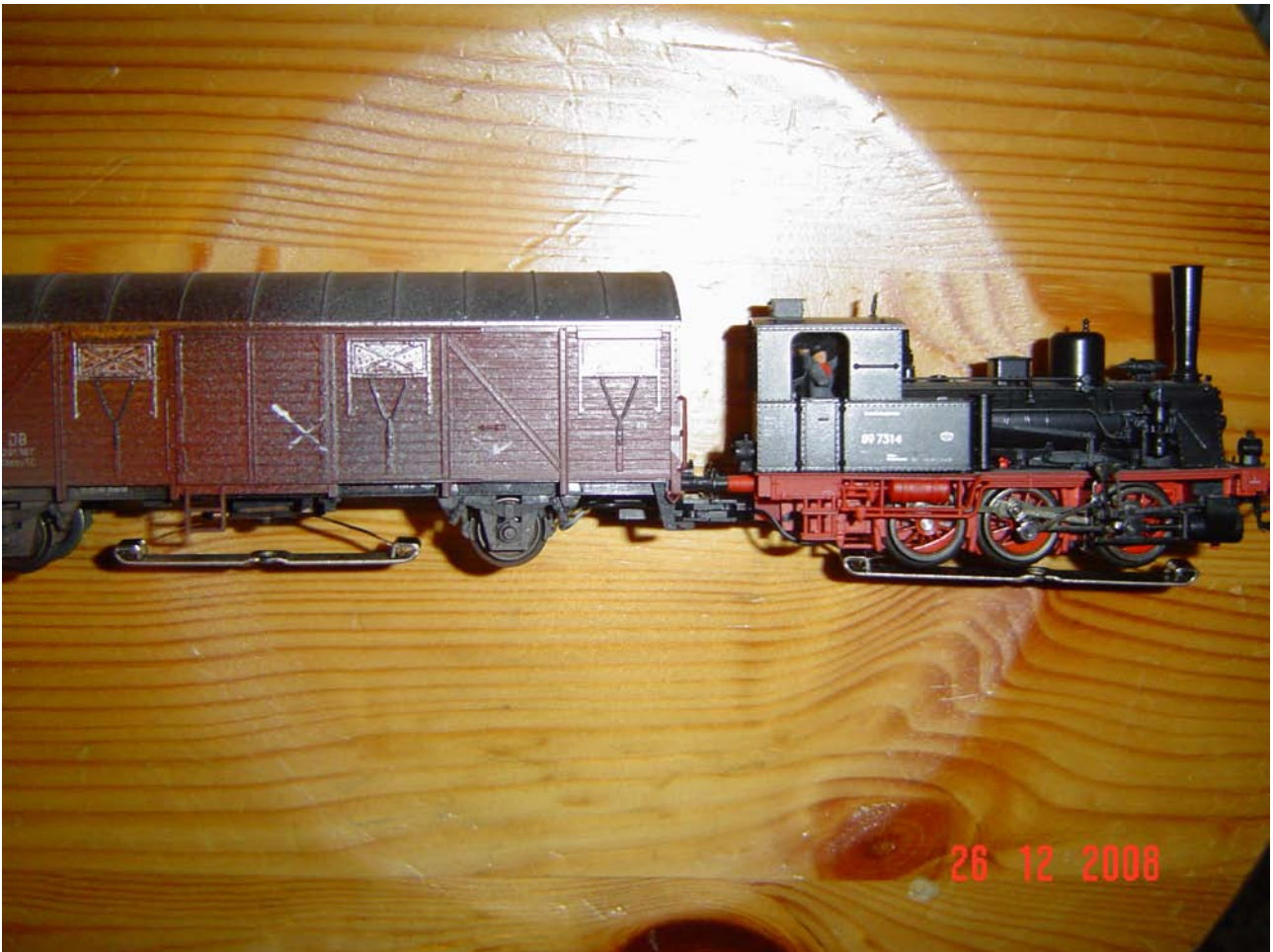
Foto n. 5 esempio di un utilizzo dei ganci per migliorare la presa di corrente
