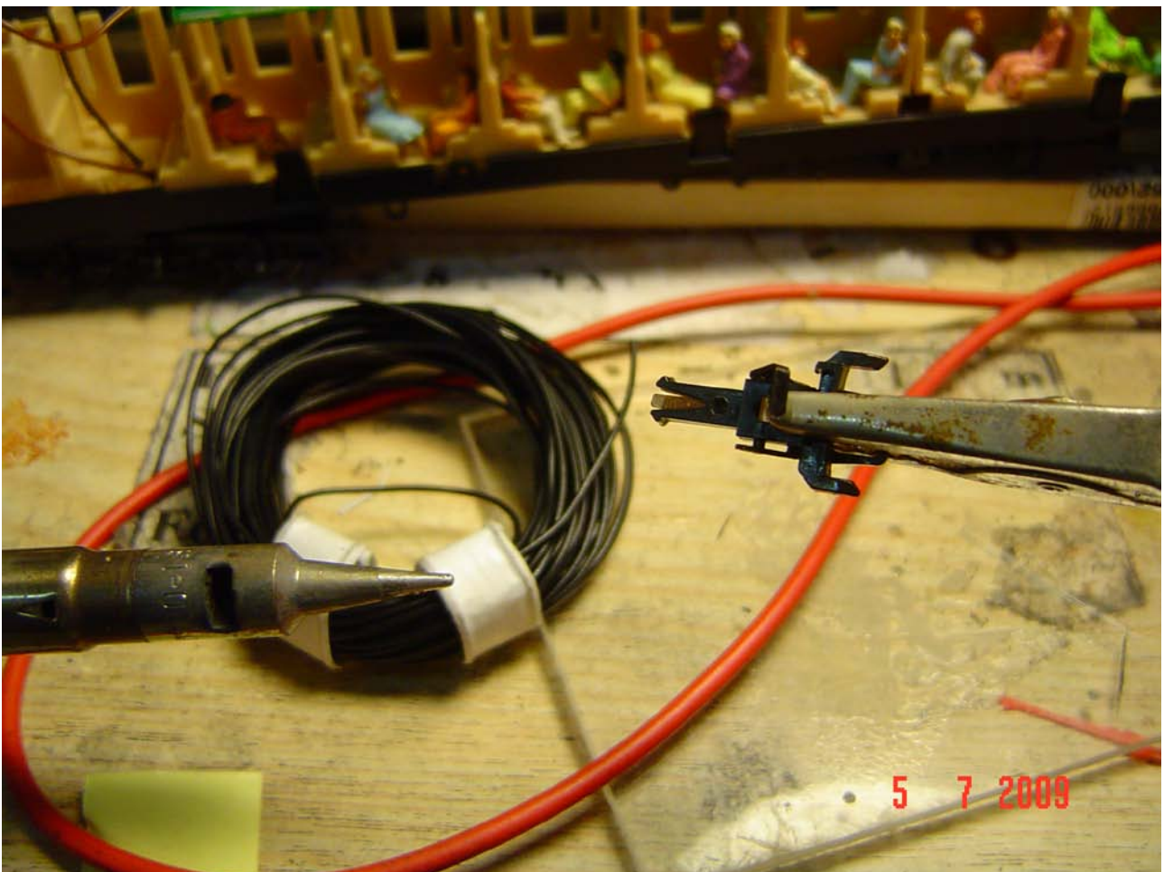
Foto n. 23: la saldatura del gancio conduttore, nel sistema adottato dall'autore e descritto nel Capitolo n. 1
