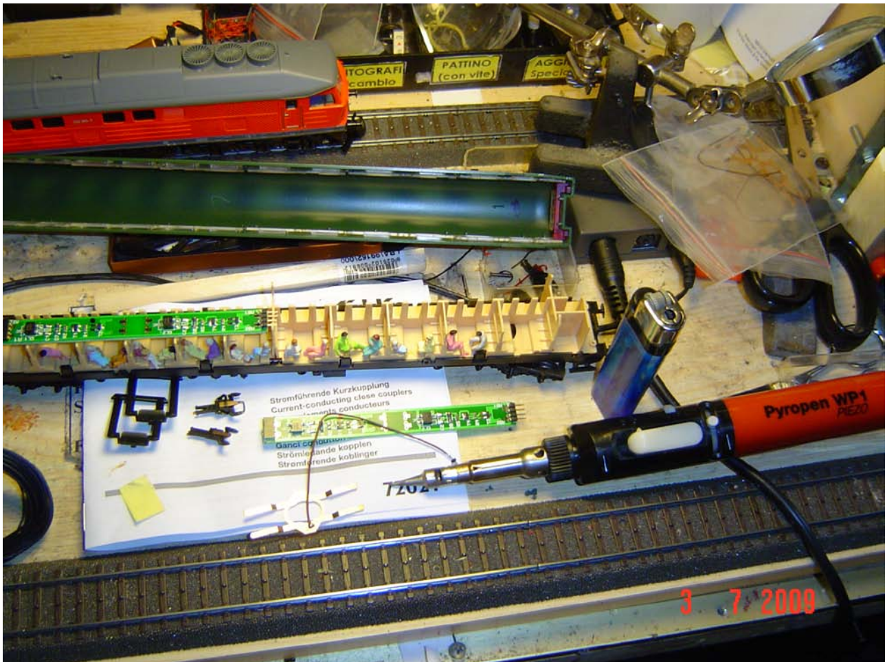
Foto n. 15: il saldatore a gas e la lamella di massa per illuminazioni 73400/01
