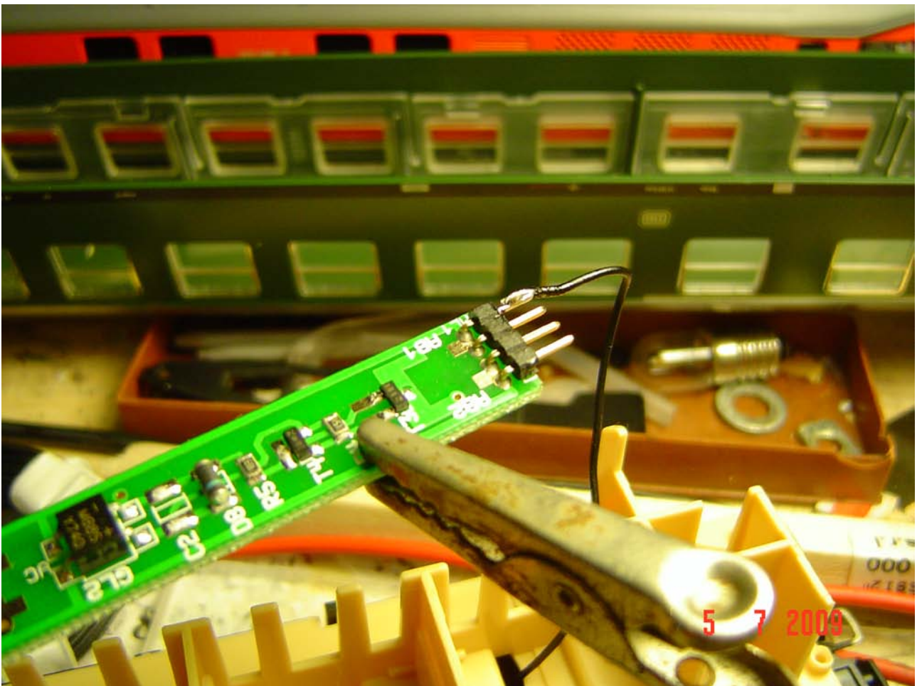
Foto n. 25: la possibile saldatura sul circuito stampato per ovviare alla mancanza di spinotti specifici Märklin.
