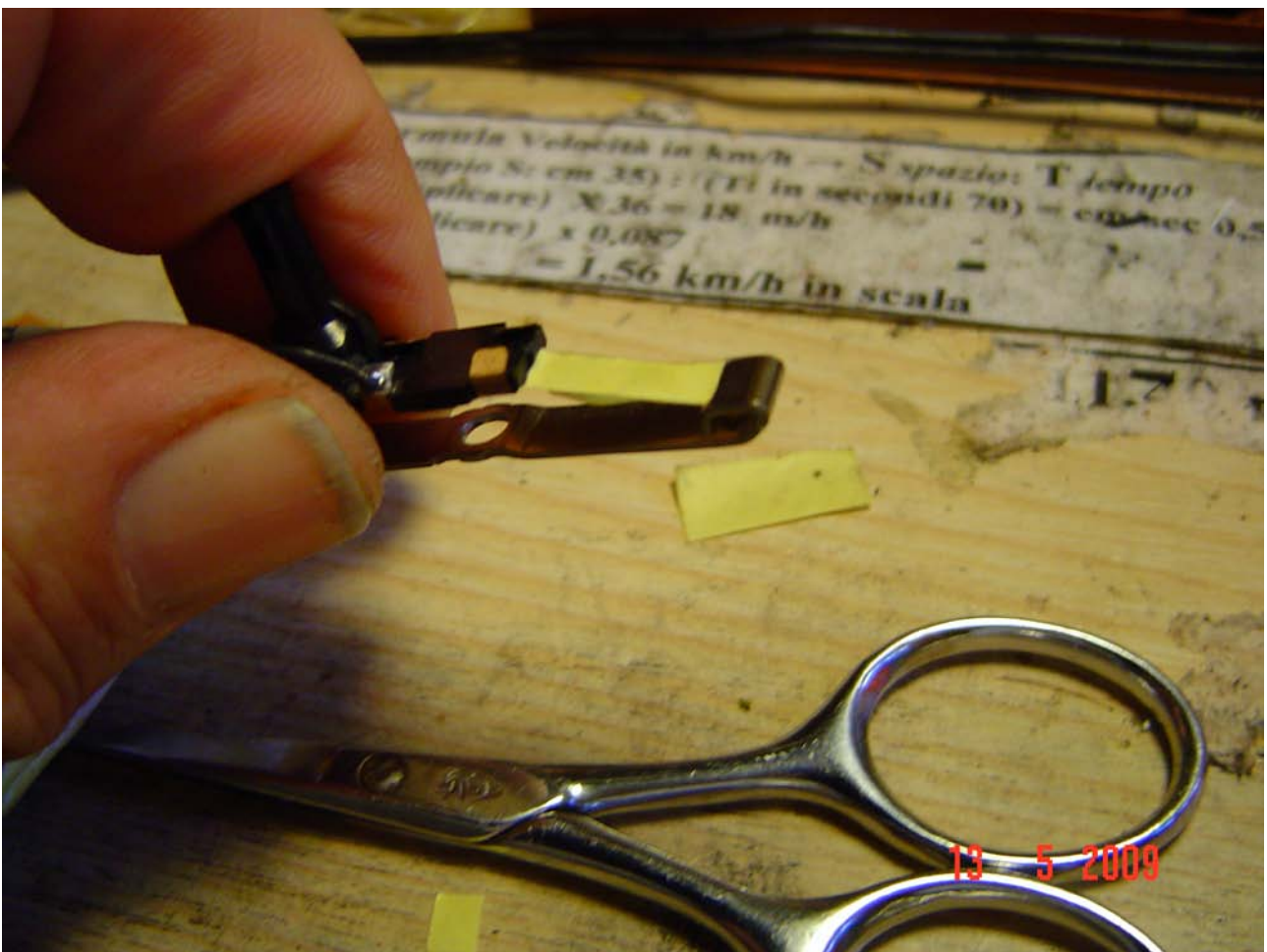
Foto n. 4: il pattino asimmetrico 73406 specifico per carrozze lunghe.
