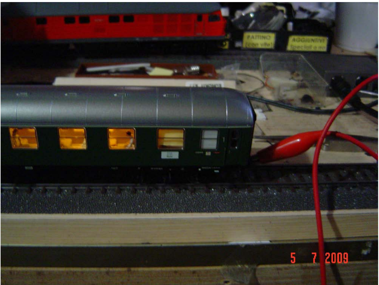
Foto n. 31 e n. 32: prove finali con l'aiuto di un cavo portacorrente
