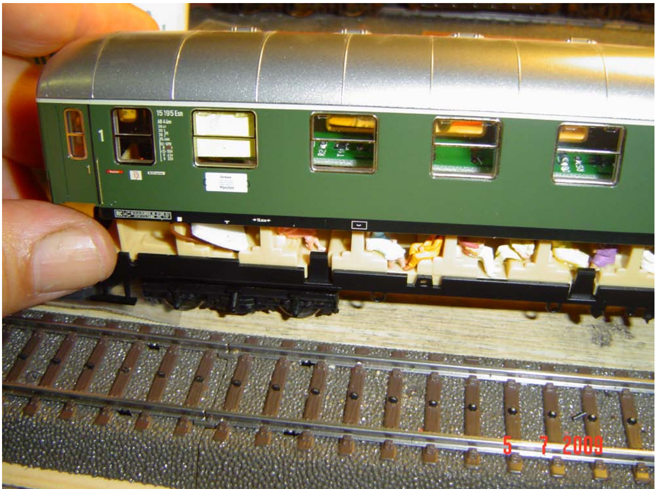
Foto n. 30: si rimonta il mantello di questa carrozza e si accea con una finta tendina lo scompartimento che ospita il passaggio dei cavi
