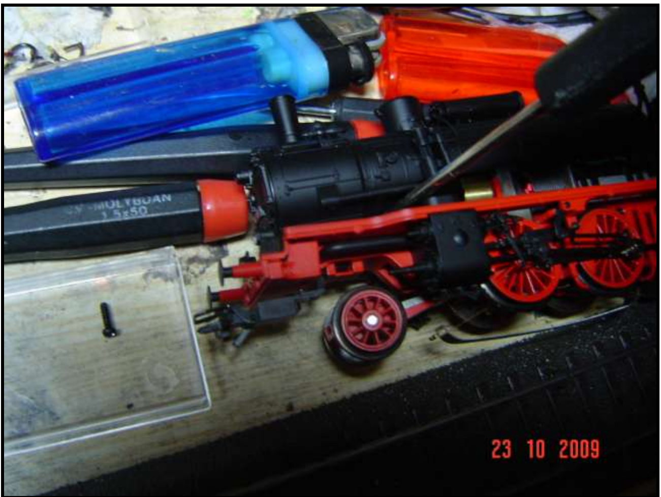
Foto n. 12: dove far leva con i cacciaviti (uno per lato).
