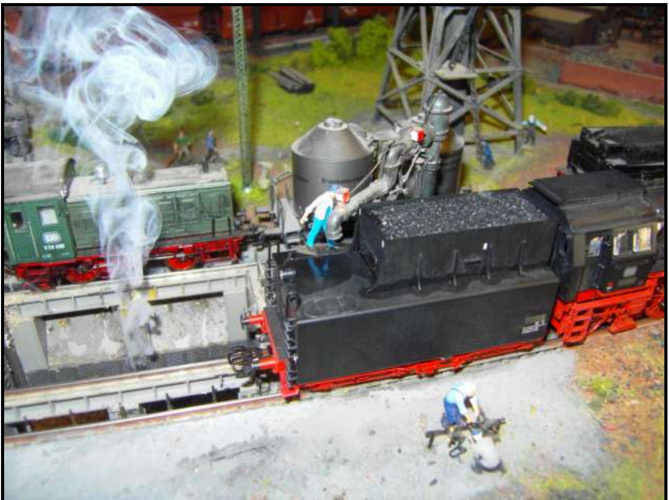
Foto n. 18: la Br 23 002 ha scaricato le ceneri nella fossa centrale.
