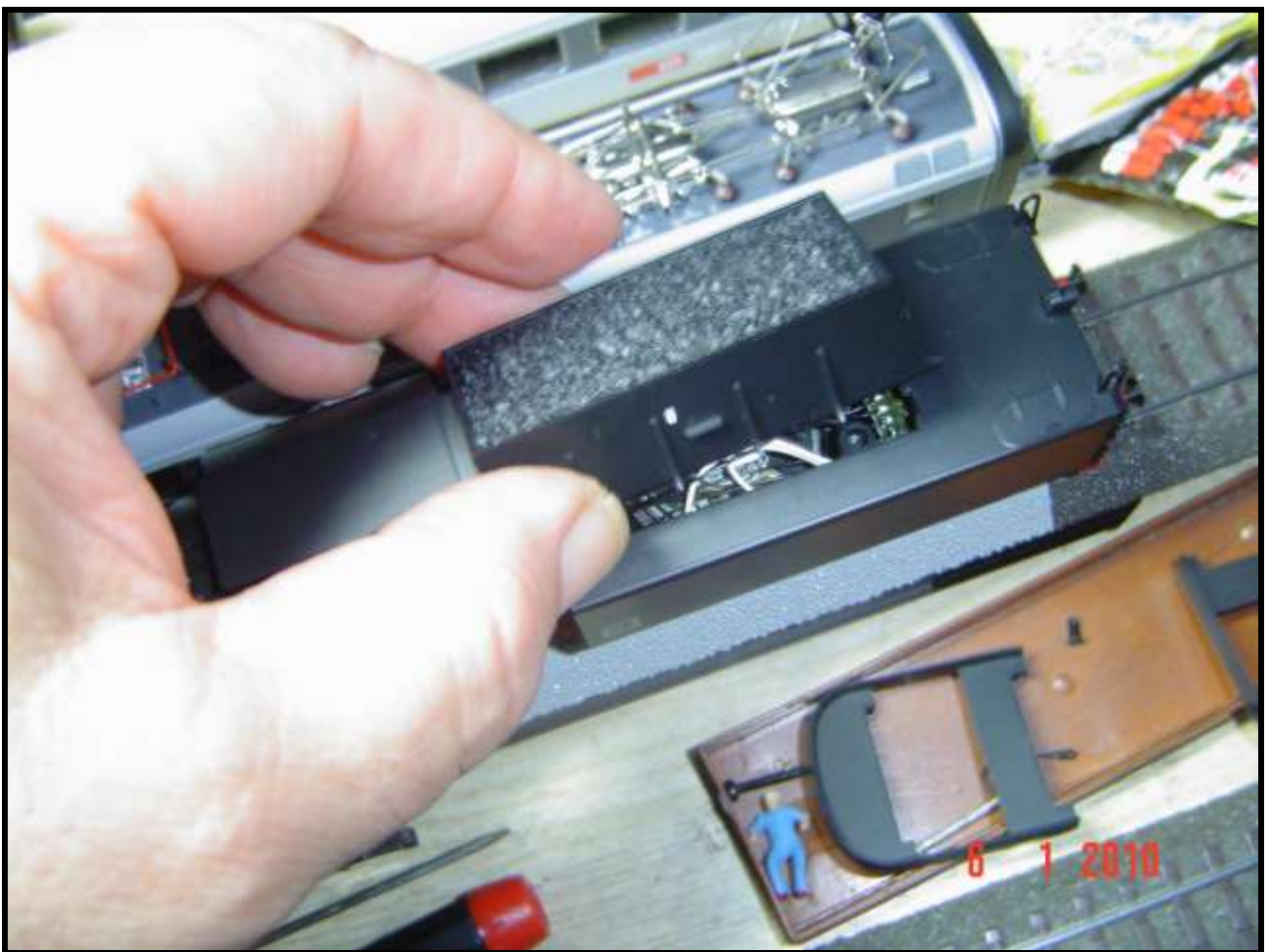
Foto n. 1: la 023 004-5 preliminare per lo smontaggio del tender.
