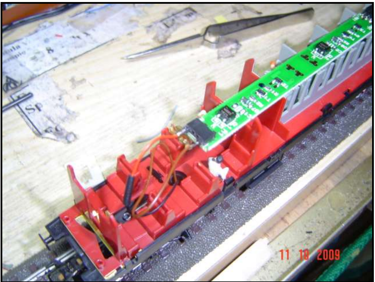
Foto n. 7: per illuminare la carrozza si usano i cavi predisposti.
