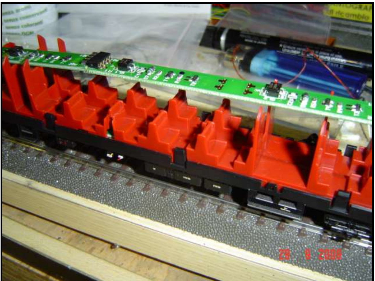
Foto n. 8: l'illuminazione interna è facile da collegare.
