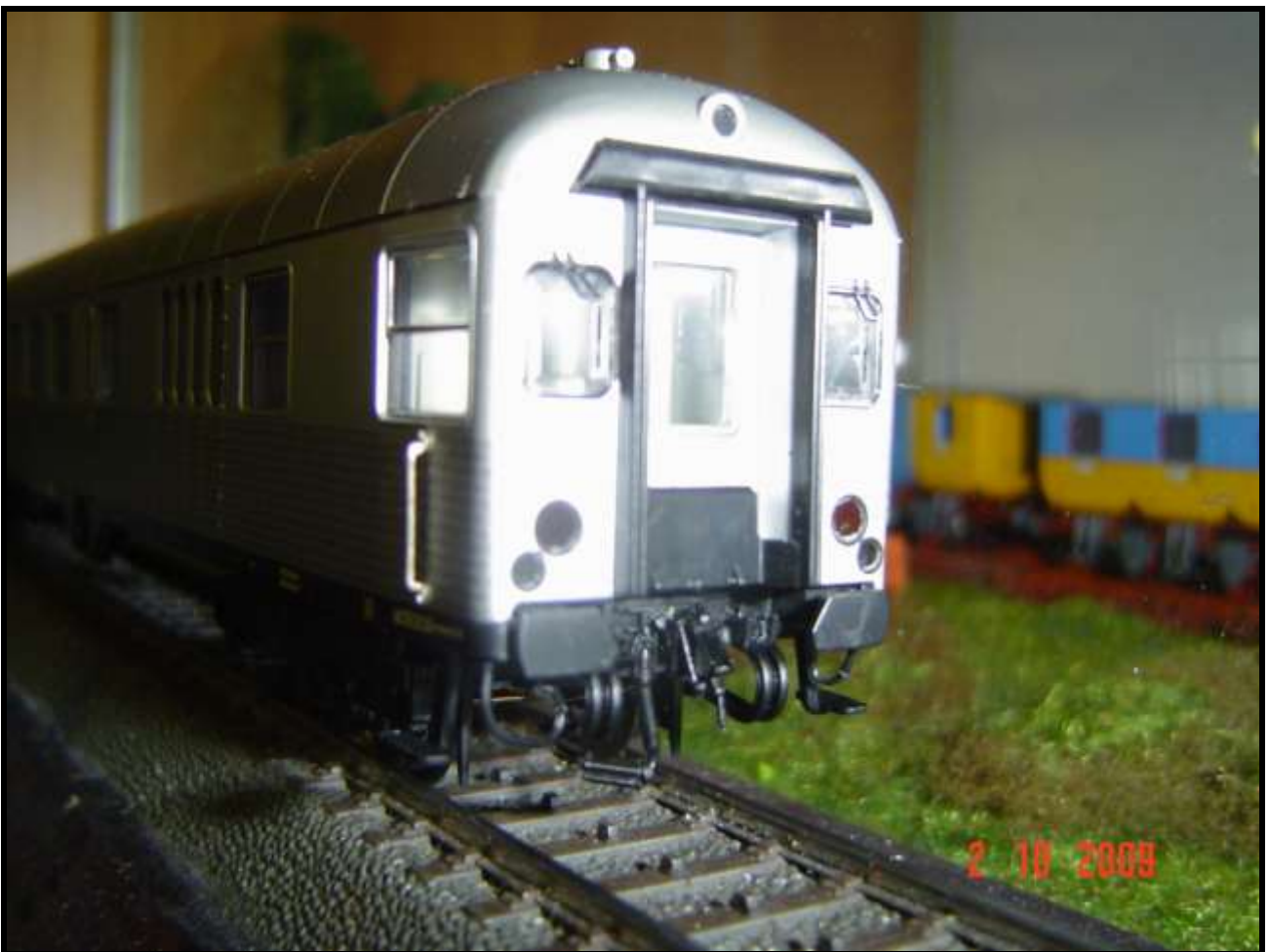
Foto n. 11: 4 tubi dei freni, un rec vapore e due accoppiatori.
