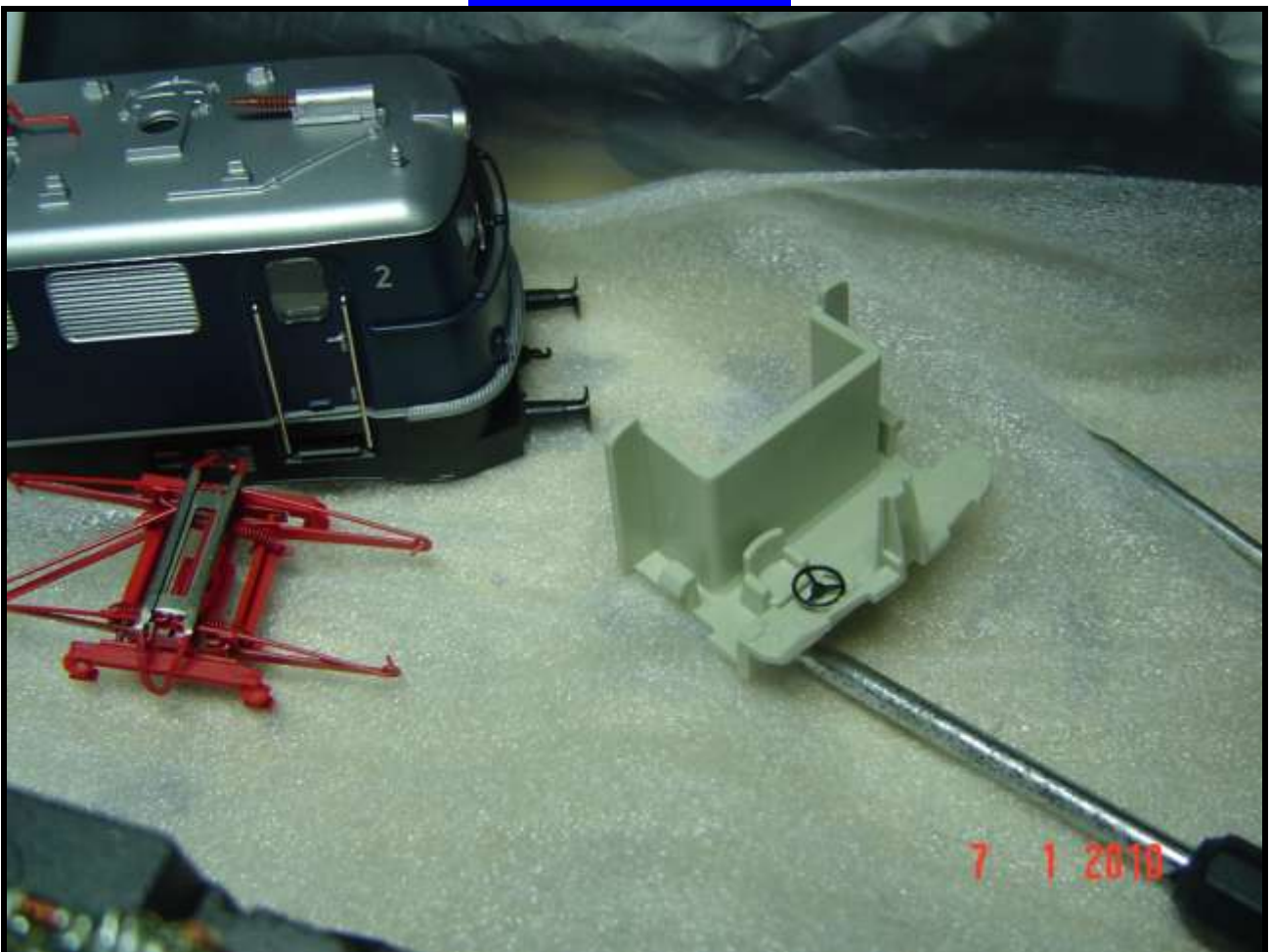
Foto n. 18 e n. 19 : allontanamento della cabina di guida facendo leva con un cacciavite.
