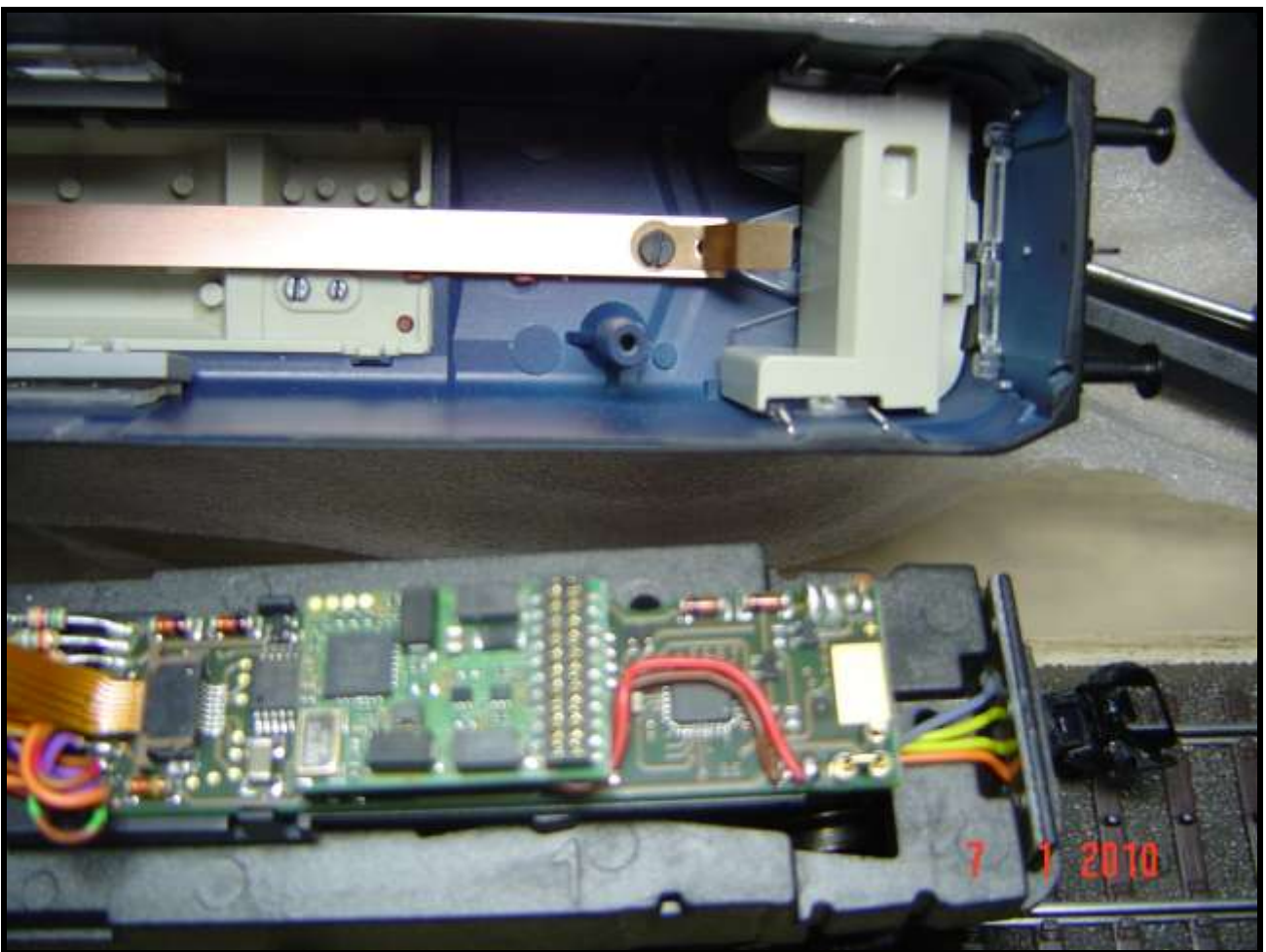
Foto n. 18 e n. 19 : allontanamento della cabina di guida facendo leva con un cacciavite.
