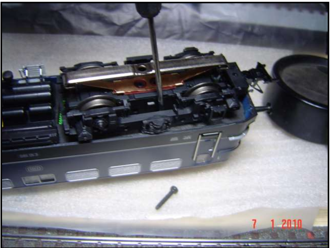
Foto n. 13: la posizione della serpentina vi può aiutare ad individuare l'esatta posizione della vite vicina al carrello dotato di pattino, consultate le istruzioni!
