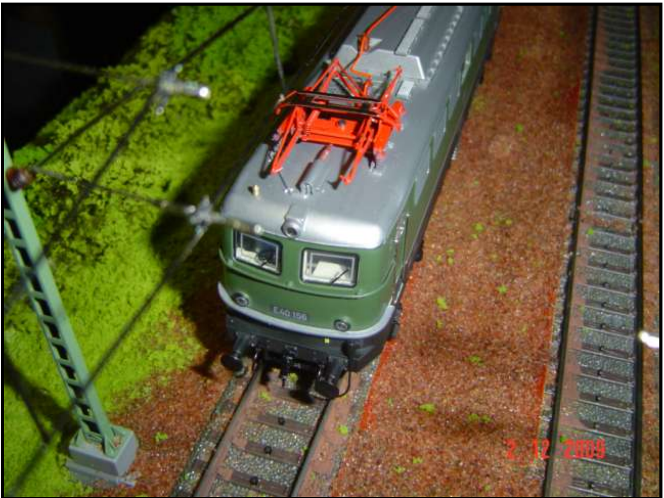
Foto n. 22: corretta presenza di 2 soli tubi dei freni per le prime E 40.
